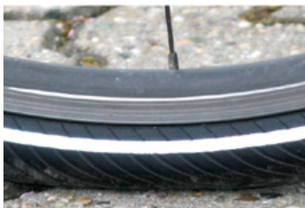
Rysunek 132: Prawidłowe ciśnienie w oponach. Opona prawie nie odkształca się pod wpływem ciężaru ciała
