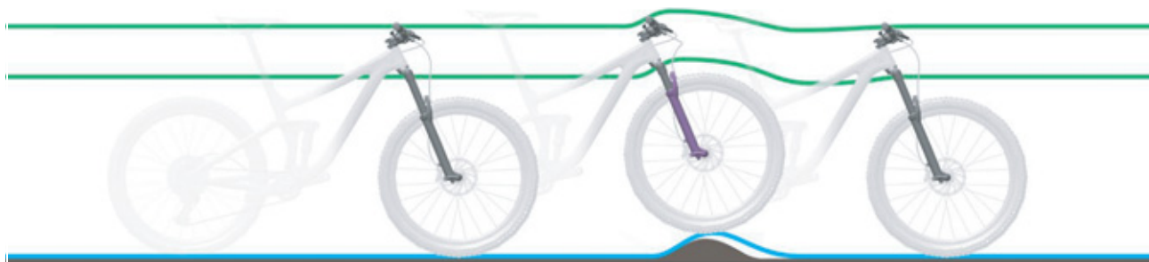
Rysunek 244: Zbyt twarde tłumienie widelca amortyzowanego na nierównościach
