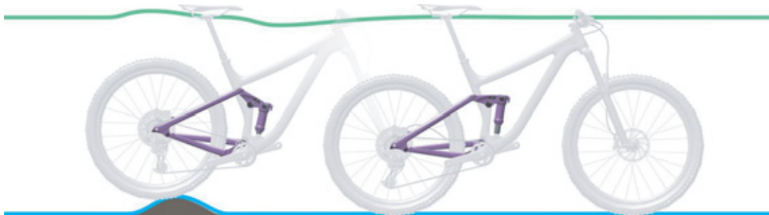
Rysunek 27: Optymalne działanie tylnego amortyzatora na nierównościach
