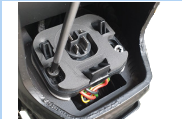
Rysunek 68: Odkręcanie śrub akumulatora
