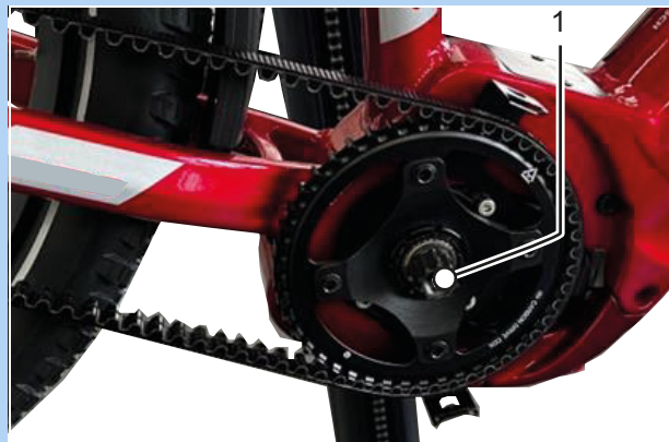
Rysunek 63: Odkręcanie koła pasowego
