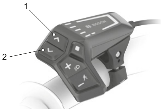
Rysunek 186: Położenie przycisku zwiększania jasności (2) i przycisku zmniejszania jasności (1)
