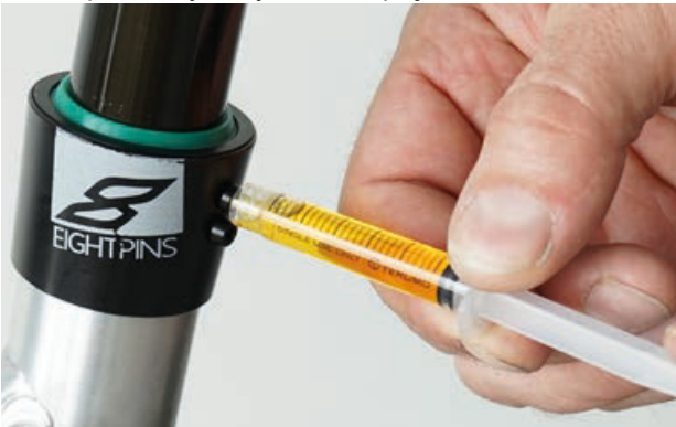
Rysunek 201: Smarowanie sztycy podsiodłowej eightpins
