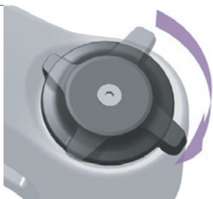
Rysunek 251: Ustawienie nastawnika dobiecia na twardszy tryb pracy
