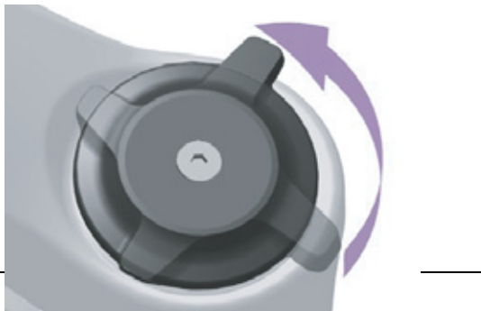
Rysunek 195: Ustawienie nastawnika dobiecia na bardziej miękki tryb pracy
