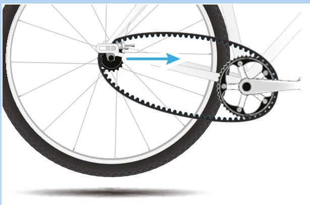
Rysunek 61: Przesuwanie tylnego koła do przodu
