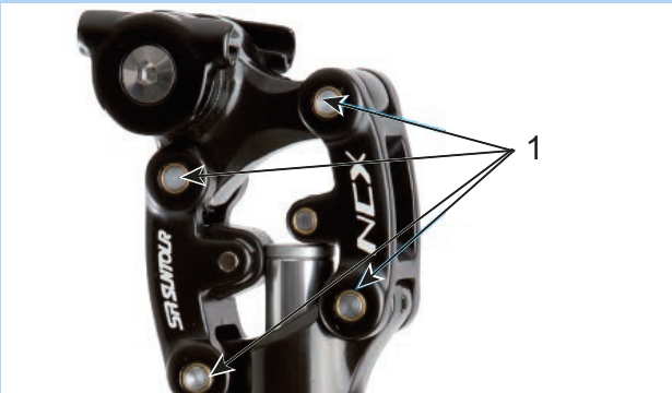
Rysunek 236: Punkty smarowania amortyzowanej sztycy podsiodłowej SR SUNTOUR
