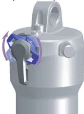
Rysunek 168: Ustawienie nastawnika dobiecia na twardszy tryb pracy
