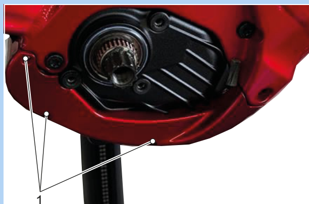
Rysunek 64: Śruby mocujące dolną pokrywę silnika (1)
