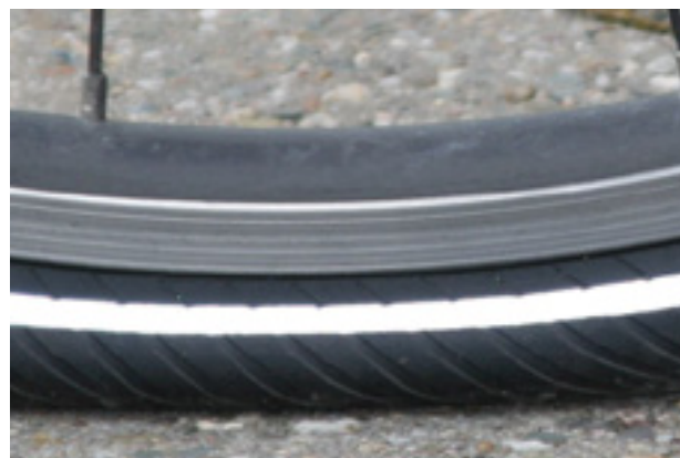
Rysunek 140: Zbyt niskie ciśnienie w oponie
