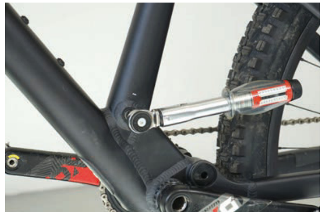
Rysunek 116: Dociąganie osi sztycy podsiodłowej
