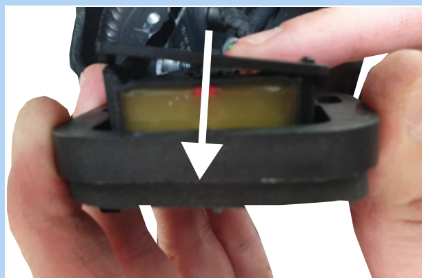
Rysunek 70: Zaciskanie klipsa
