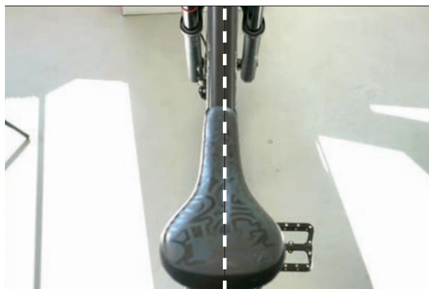
Rysunek 108: Ustawianie siodełka zgodnie z kierunkiem jazdy
