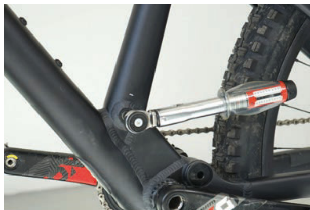
Rysunek 109: Dociąganie osi sztycy podsiodłowej
