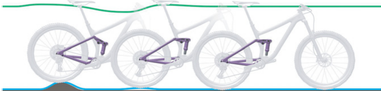
Rysunek 262: Zbyt szybkie rozprężanie się tylnego amortyzatora
