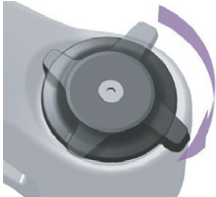
Rysunek 194: Ustawienie nastawnika dobiecia na twardszy tryb pracy
