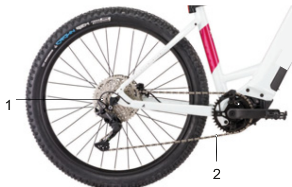
Rysunek 38: Schemat napędu łańcuchowego z przerzutką
