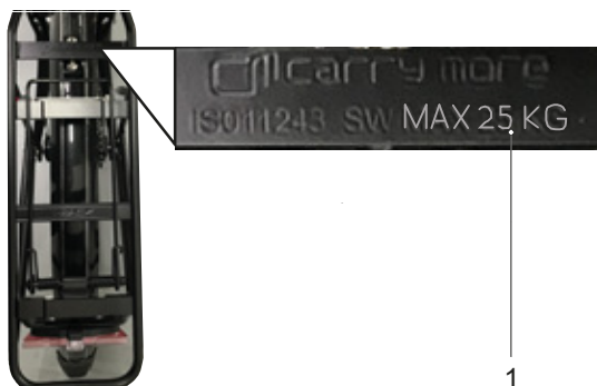
Rysunek 177: Na bagażniku umieszczona jest informacja o jego maksymalnej nośności (1)
