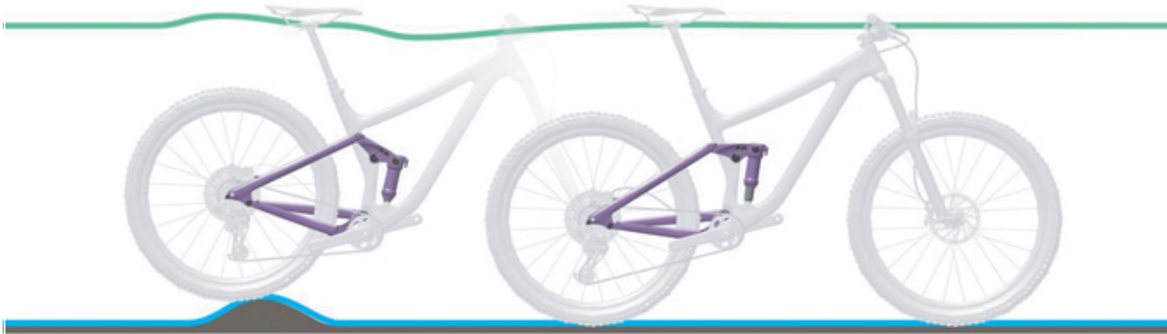
Rysunek 164: Optymalne działanie tylnego amortyzatora na nierównościach
