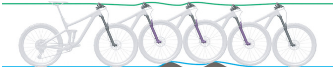
Rysunek 240: Zbyt wolne rozprężanie widelca amortyzowanego
