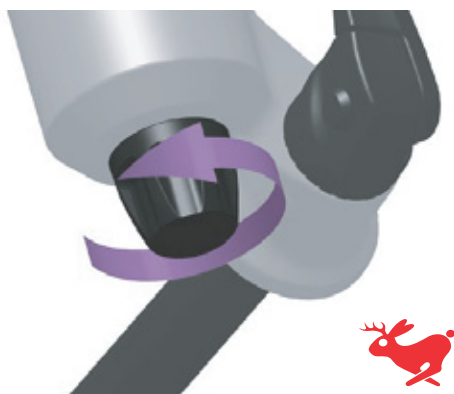
Rysunek 249: Obrócić pokrętko nastawnika odbicia w kierunku symbolu zająca
