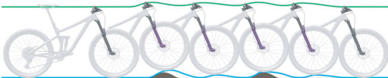
Rysunek 246: Zbyt szybkie rozprężanie widelca amortyzowanego
