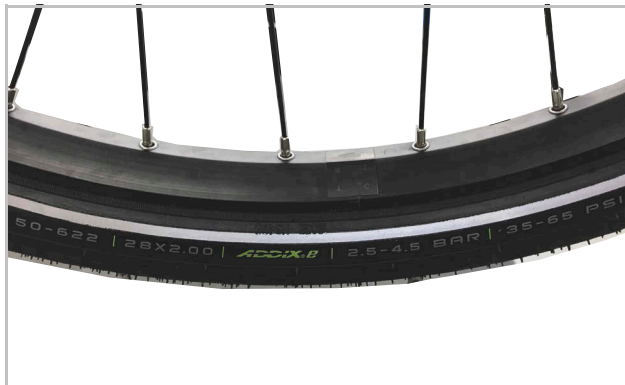
Obr. 29: Příklad: Informace na plášti
