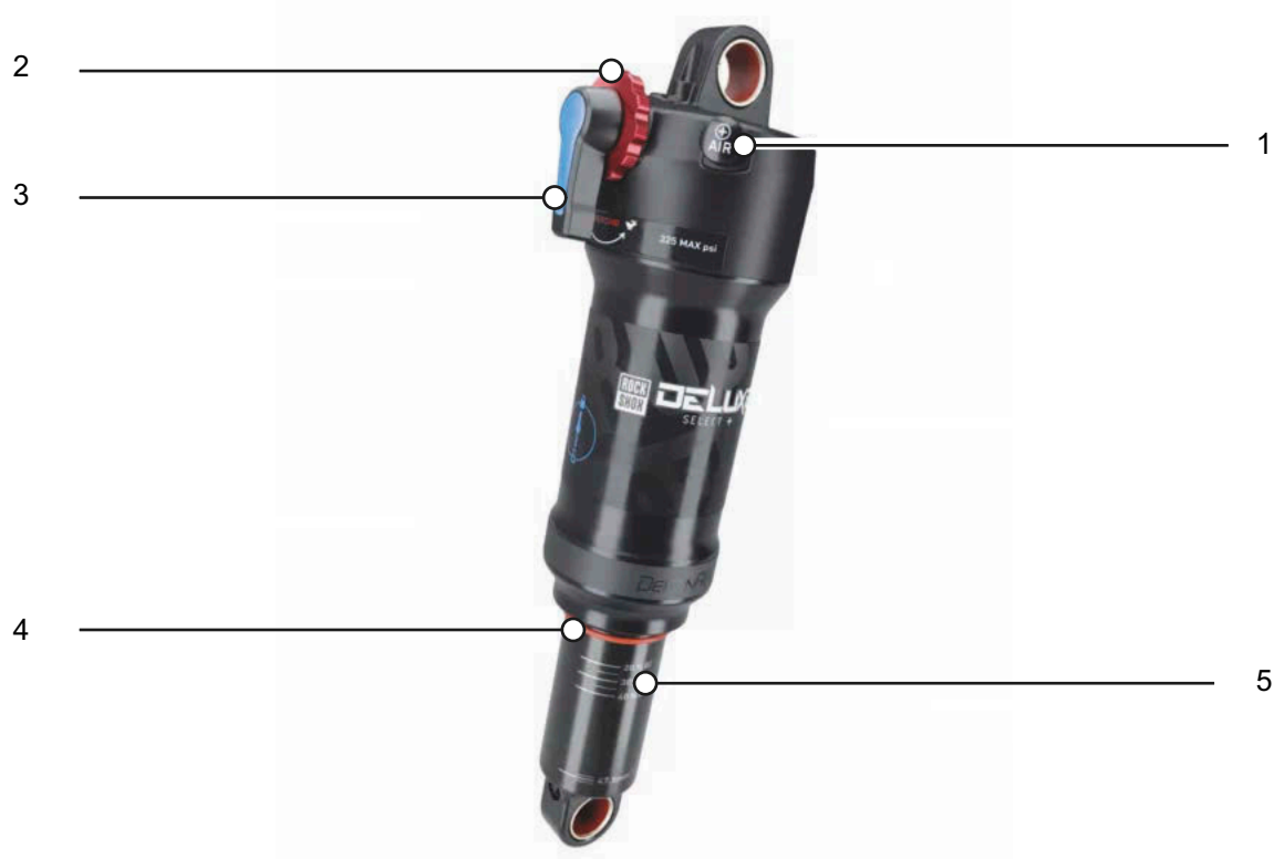
Obr. 88: Konstrukce tlumič zadního odpružení ROCKSHOX Deluxe Select+
