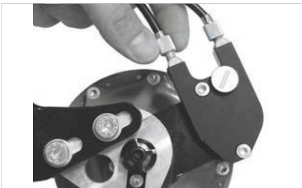
Obr. 259: Náboje ROHLOFF s externím ovládním řazení mají seřizovače napnutí na lanovodu, který je umístěn na levé straně
