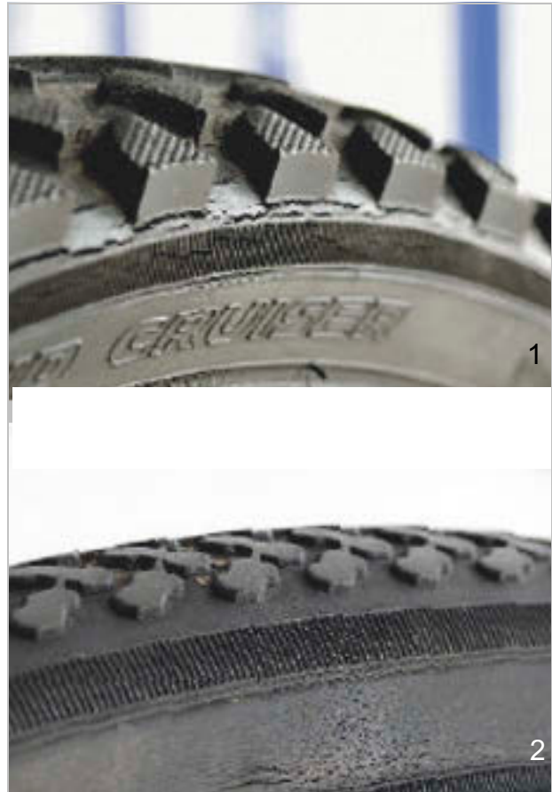
Obr. 233: Příklady únavových trhlin (1) a trhlin vzniklých stárnutím (2)
