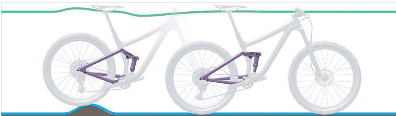
Obr. 198: Optimální chování tlumiče zadního odpružení při jízdě u nerovností
