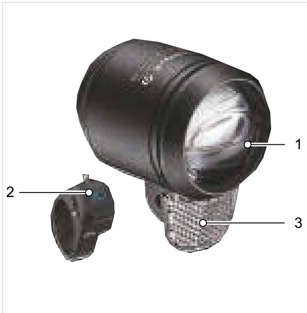
Obr. 58: LITEMOVE, AE-130 se světlometem (1), spínač dálkového světla na řídkách (2) a odrazové světlo (3)
