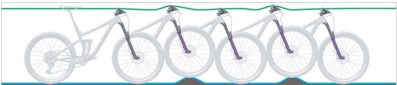
Illustration 21 : Comportement optimal de la fourche de suspension
