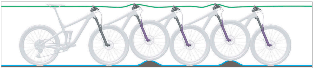
Illustration 18 : Comportement optimal de la fourche de suspension
