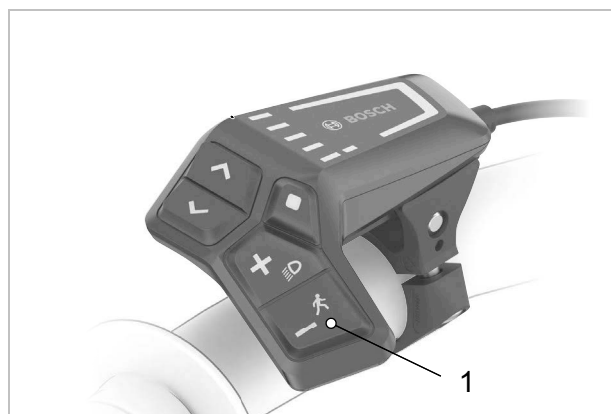
Illustration 212 : Position de la touche d'assistance de poussée (1)
