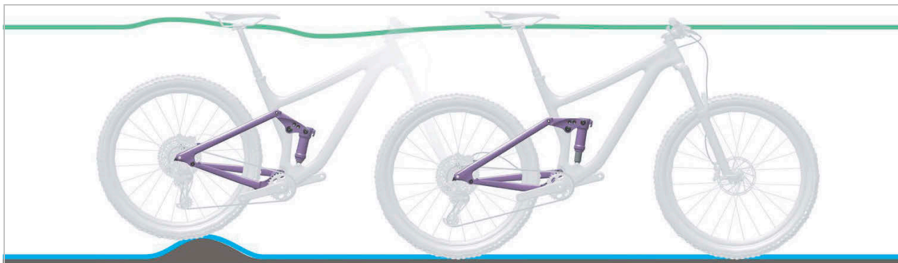
Illustration 198 : Comportement optimal de l'amortisseur arrière sur des irrégularités
