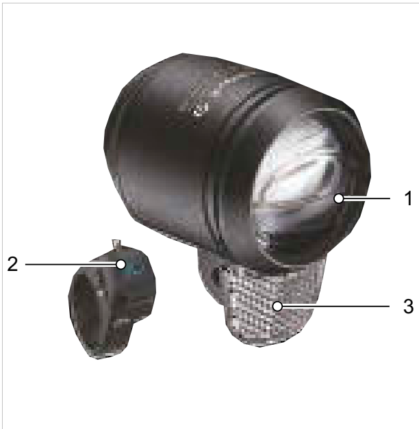
Illustration 58 : LITEMOVE AE-130 avec phare avant (1), interrupteur de feux de route sur le guidon (2) et réflecteur (3)
