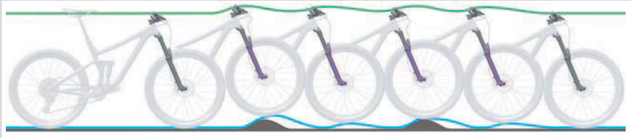
Illustration 266 : Détente trop rapide de la fourche suspendue
