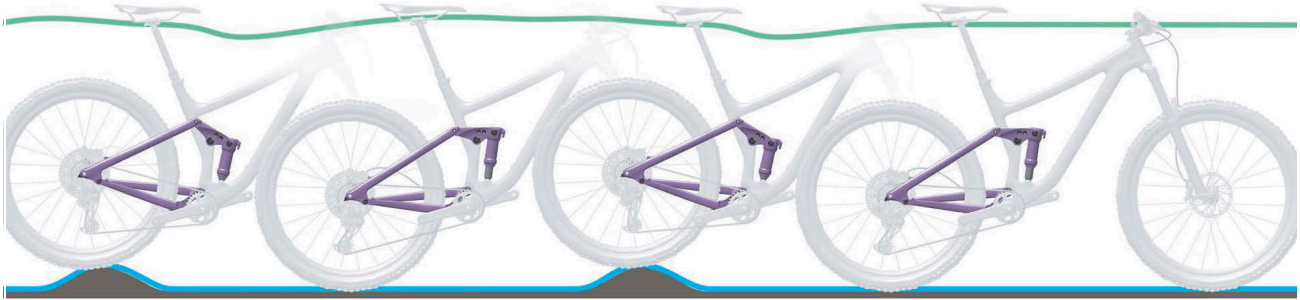
Illustration 8 : Comportement optimal de l'amortisseur arrière
