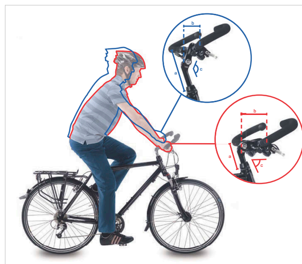
Illustration 165 : Position sur vélo de ville (en bleu) et sur vélo tout chemin (en rouge) avec modification de l'angle
