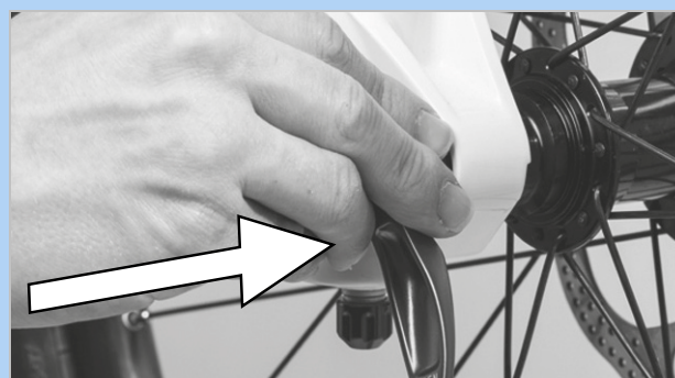
Figura 138: Inserimento del bloccaggio rapido nel verso della freccia
