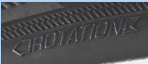
Figura 125: Freccia del senso di rotazione
