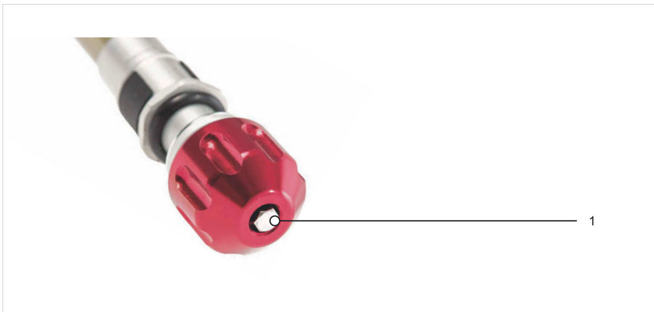
Figura 269: Esempio di regolatore del rebound (forcella) (1) SR SUNTOUR
