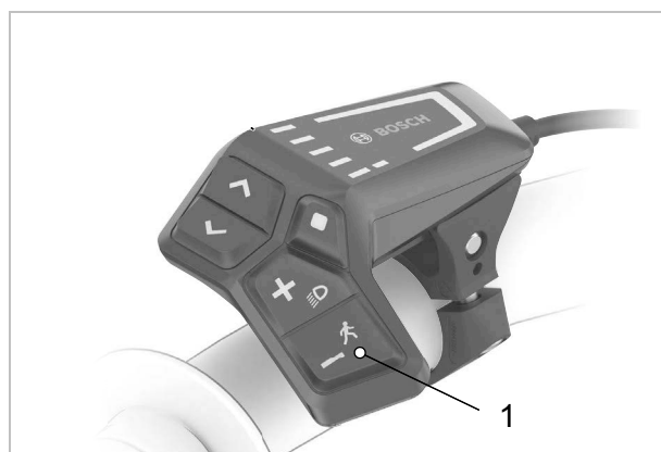
Figura 212: Ubicazione del tasto della funzione di assistenza di spinta (1)
