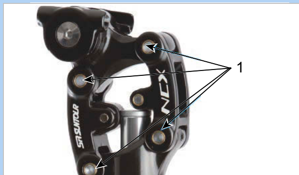
Figura 264: Punti di lubrificazione del canotto reggisella ammortizzato SR SUNTOUR
