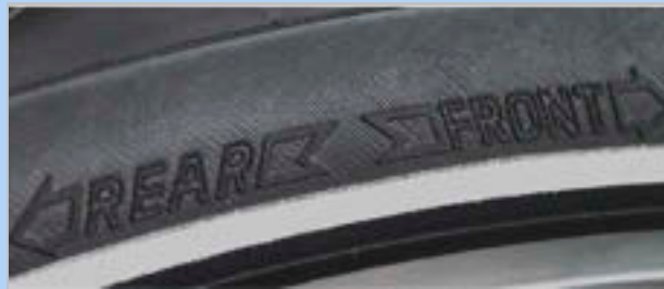
Figura 126: Freccia del senso di rotazione su pneumatici MTB
