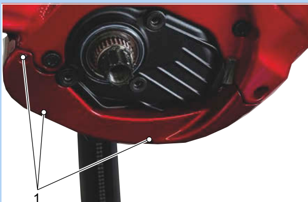
Figura 120: Viti di fissaggio della copertura inferiore del motore (1)
