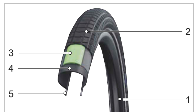
Figura 30: Struttura degli pneumatici aperti
