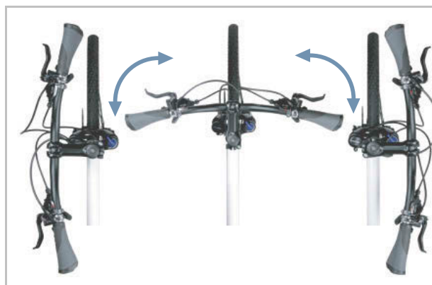
Figura 12: Funzione Twist, esempio BY.SCHULZ
