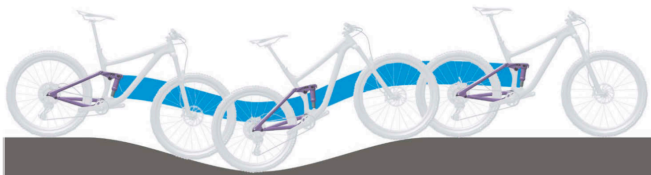
Figura 9: Comportamento di marcia ottimale dell'ammortizzatore del carro posteriore su un terreno con dossi
