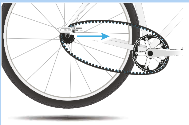
Figura 107: Spingere la ruota posteriore in avanti
