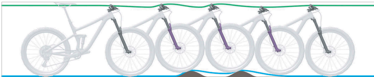
Figura 268: Corsa di estensione troppo lenta della forcella ammortizzata
