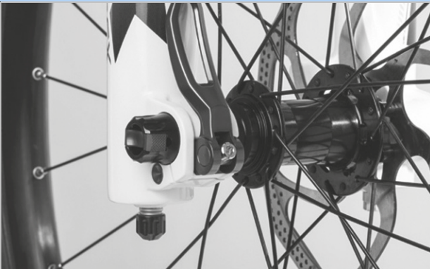
Figura 135: Corretta posizione della leva di serraggio
