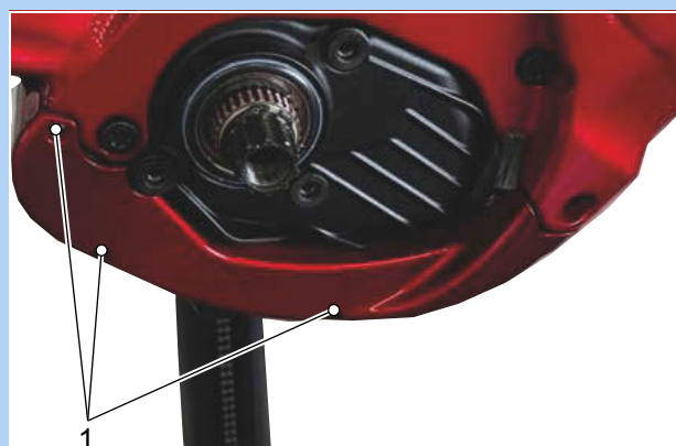
Figura 110: Viti di fissaggio della copertura inferiore del motore (1)
