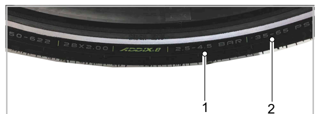
Figura 231: Pressione di gonfiaggio in bar (1) e in psi (2)
