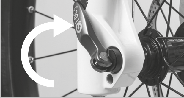
Figura 140: Chiusura del bloccaggio rapido
