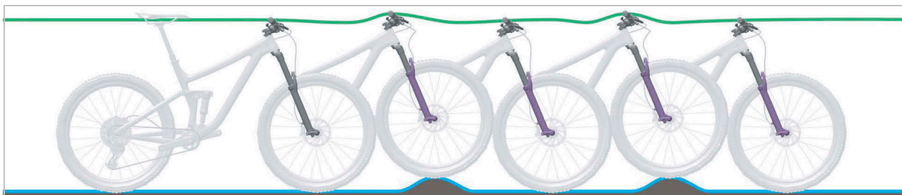
Figura 21: Comportamento di marcia ottimale della forcella ammortizzata
