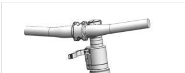
Figura 200: Esempio: All Up con leva di serraggio dell'attacco manubrio aperta
