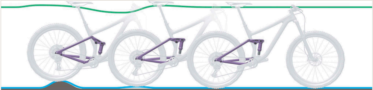
258. ábra: A hátsó lengéscsillapító túl gyors kirugózása
