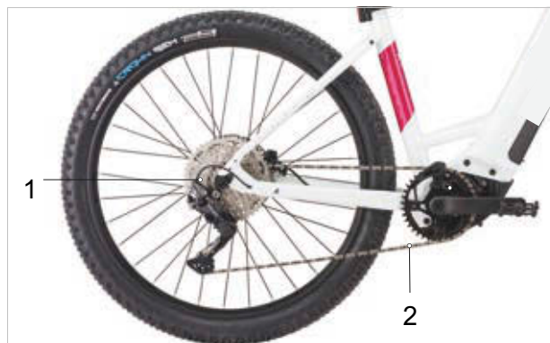
50. ábra: Külső váltóval felszerelt lánchajtás vázlata
