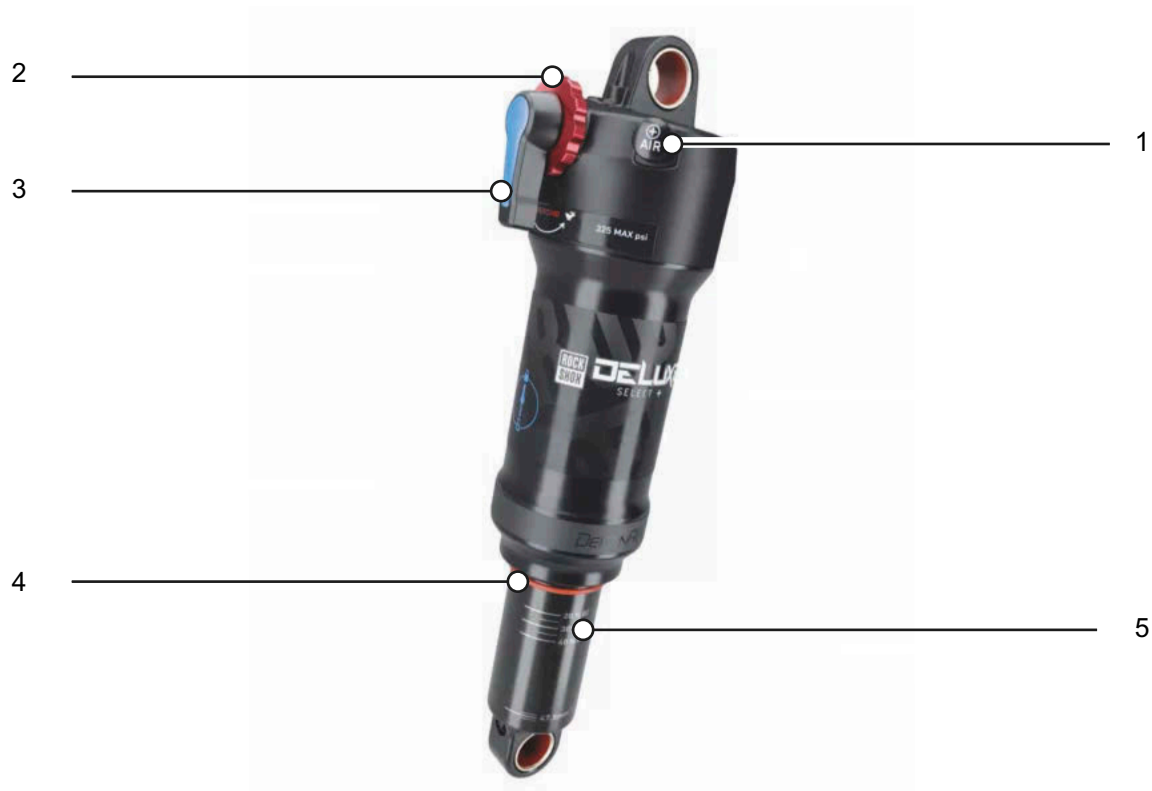
10. ábra: ROCKSHOX Deluxe Select+ hátsó lengéscsillapító felépítés
