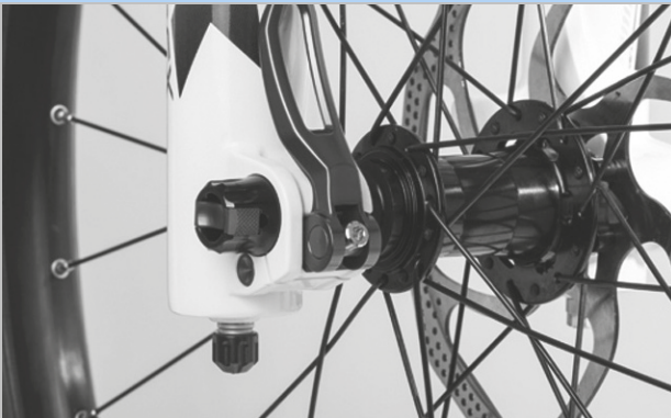
121. ábra: A gyorskioldó kar tökéletes helyzete
