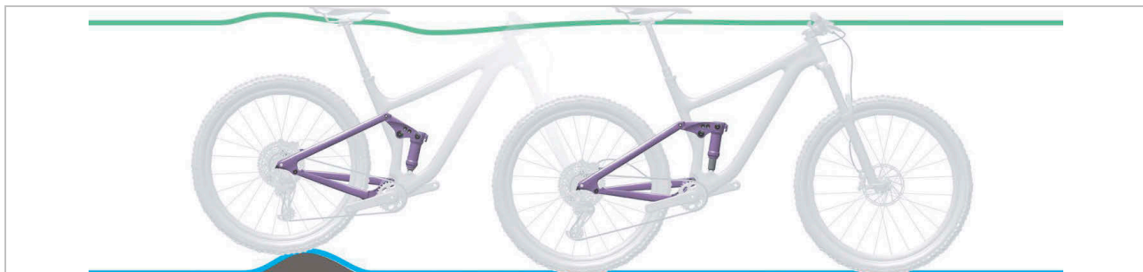
7. ábra: A hátsó lengéscsillapító optimális menetviselkedése egyenetlenségeknél
