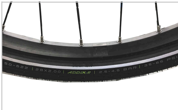
28. ábra: Példa: Információk a gumiabroncson
