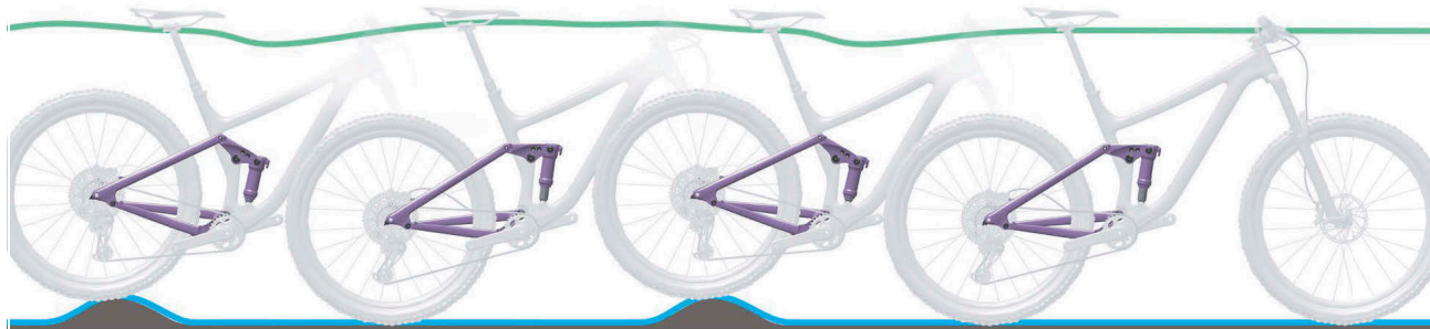
8. ábra: A hátsó lengéscsillapító optimális menetviselkedése
