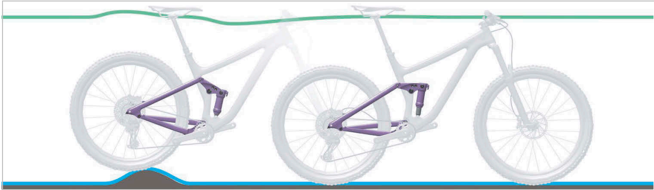
185. ábra: A hátsó lengéscsillapító optimális menetviselkedése egyenetlenségeknél
