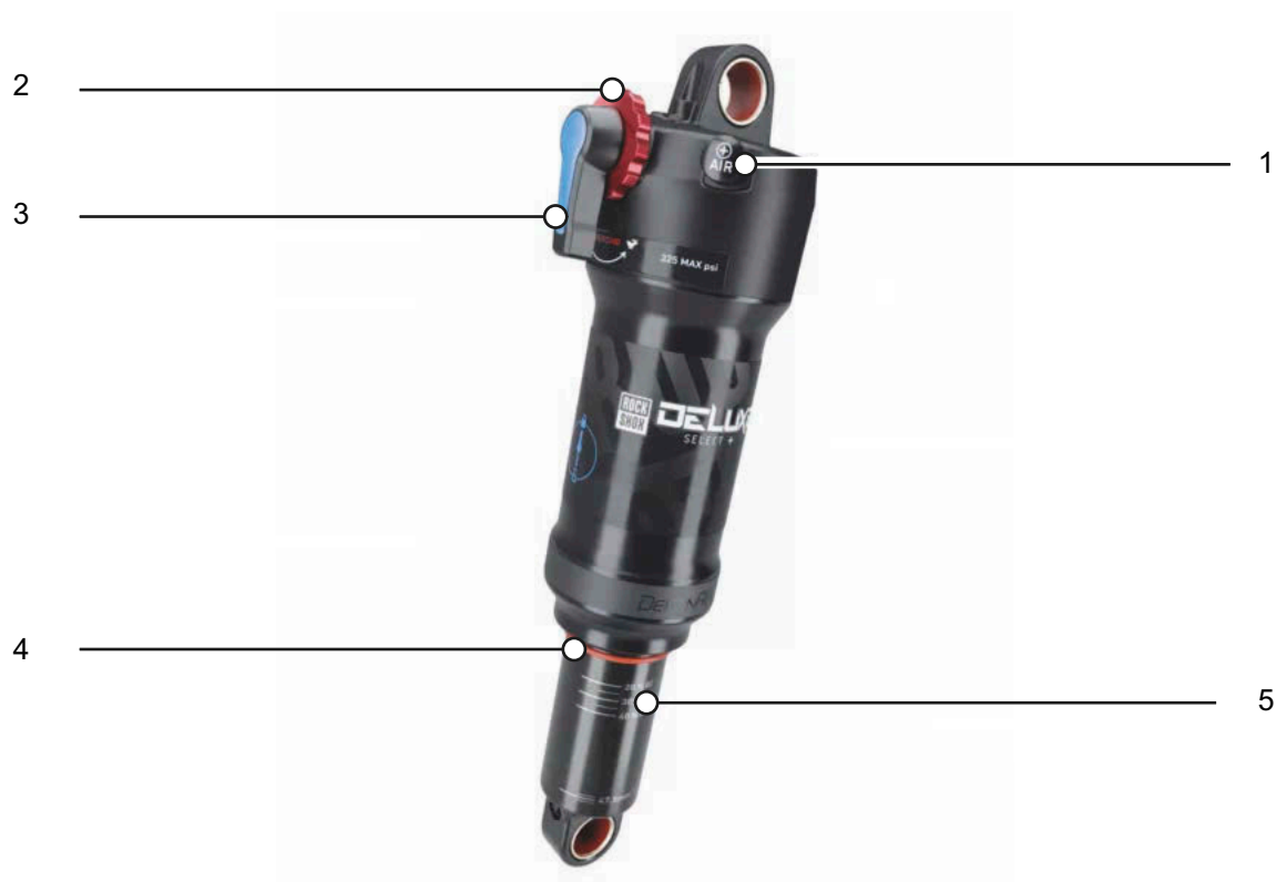
74. ábra: ROCKSHOX Deluxe Select+ hátsó lengéscsillapító felépítés
