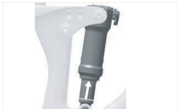
166. ábra: O-gyűrű eltolása a hátsó lengéscsillapítón
