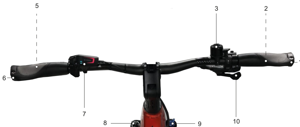
Slika 44: Detaljan prikaz upravljača s BOSCH Kiox300, primjer
