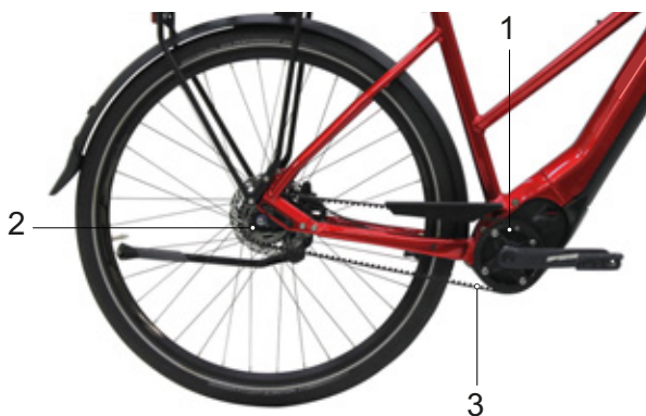
Slika 39: Shema remenskog pogona
