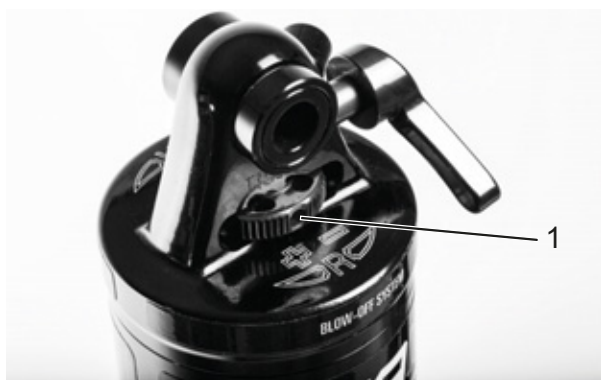
Slika 255: Kotačić za podešavanje odskoka SR SUNTOUR (1) na stražnjem amortizeru
