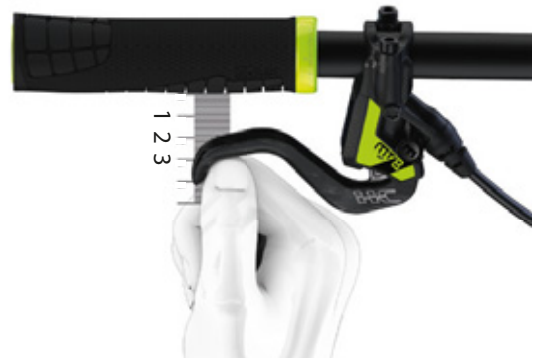
Slika 137: Pozicioniranje ručne kočnice
