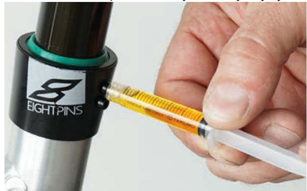
Slika 201: Podmazivanje eightpins cijevi sjedala
