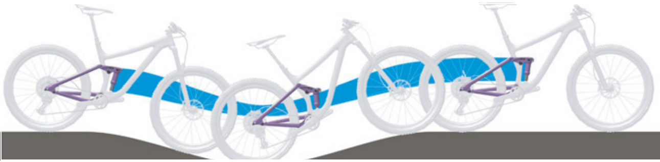
Slika 258: Premekan ovjes stražnjeg amortizera na uzbrdici
