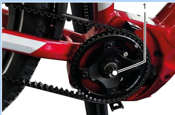
Slika 75: Primjer pričvršćivanja remenice
