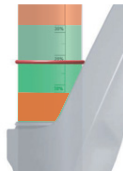
Slika 146: Propisano područje SAG-a (zeleno) i zabranjeno područje SAG-a (crveno)
