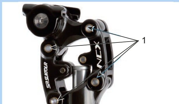
Slika 236: Točke podmazivanja amortizacijske cijevi sjedala SR SUNTOUR
