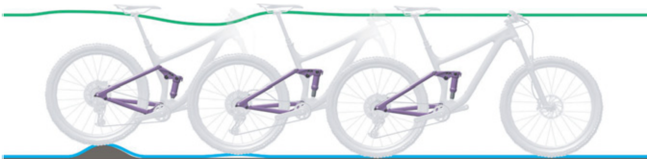
Slika 254: Prebrzo odskakivanje stražnjeg amortizera
