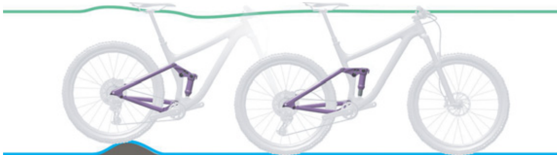
Slika 27: Optimalno ponašanje stražnjeg amortizera pri vožnji po neravninama
