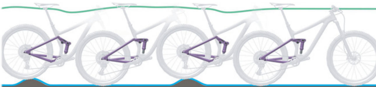
Slika 25: Optimalno ponašanje stražnjeg amortizera pri vožnji
