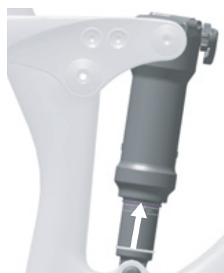
Slika 158: Pomicanje O-prstena na stražnjem amortizeru
