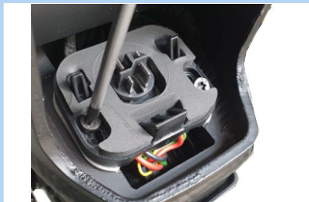
Slika 68: Otpustite vijke držača baterije
