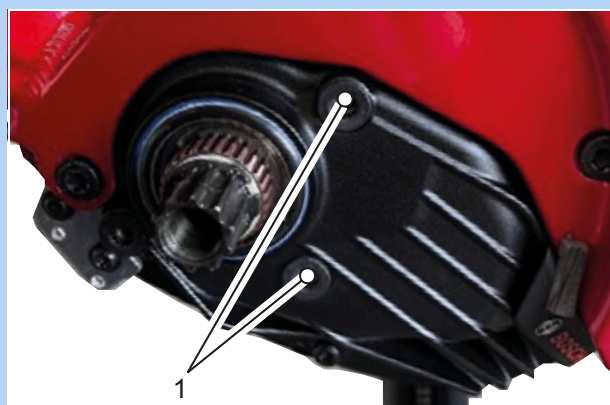
Slika 73: Položaj pričvrsnih vijaka (1)
