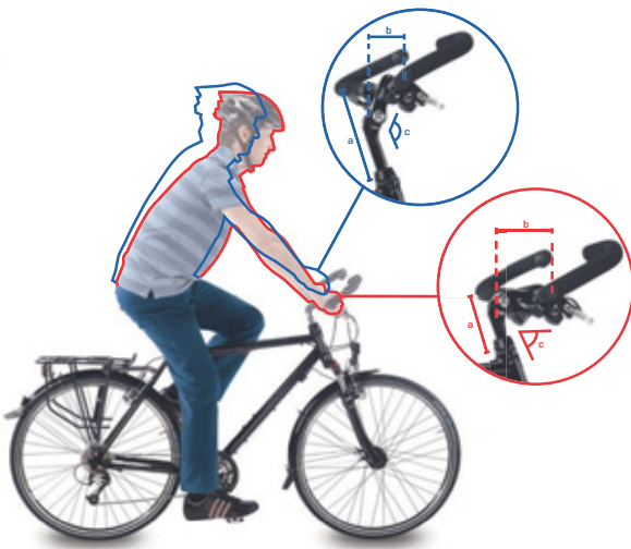
Slika 130: Položaj tijela za vožnju gradskog bicikla (plavo) i trekking bicikla (crveno) pri promjeni kuta
