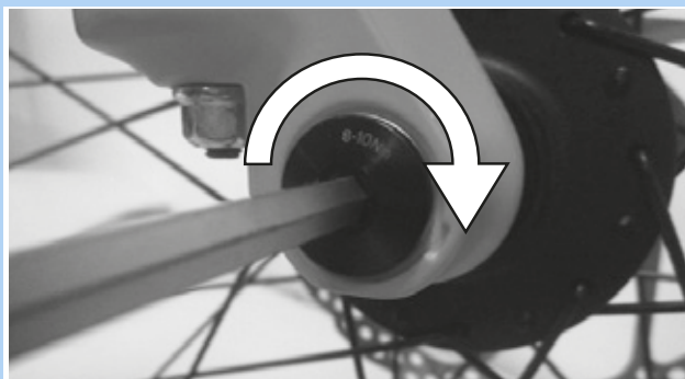
Slika 82: Pritezanje osovine u smjeru strelice
