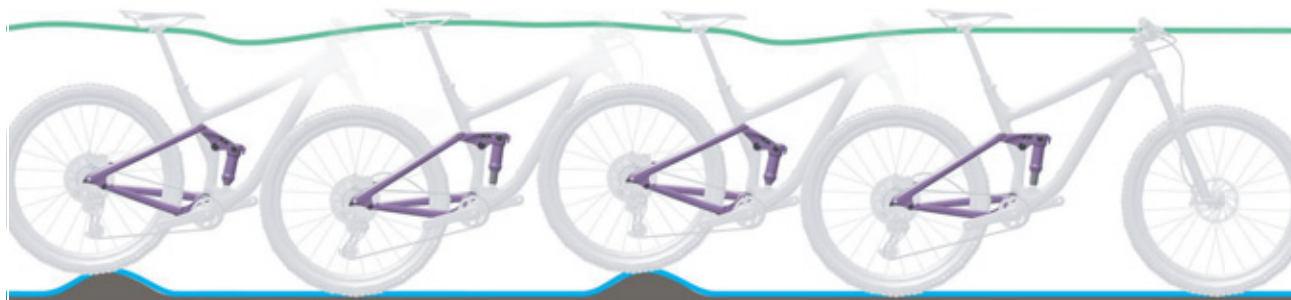
Slika 162: Optimalno ponašanje stražnjeg amortizera pri vožnji
