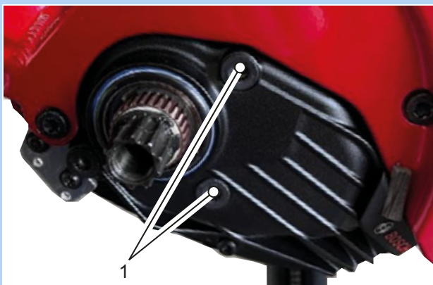
Slika 65: Položaj pričvrstnih vijaka (1)
