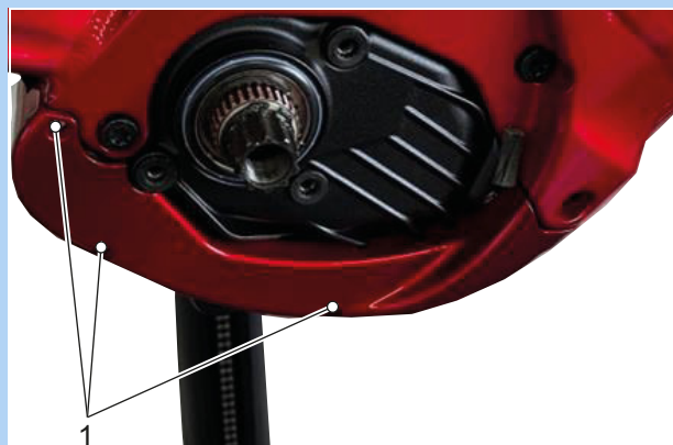
Slika 64: Pričvrzni vijci donjeg poklopca motora (1)
