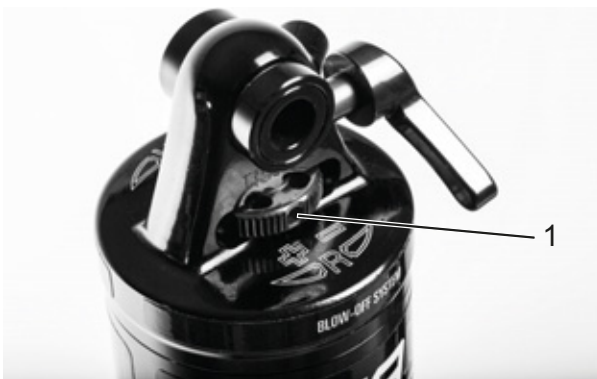
Slika 257: Kotačić za podešavanje odskoka SR SUNTOUR (1) na stražnjem amortizeru
