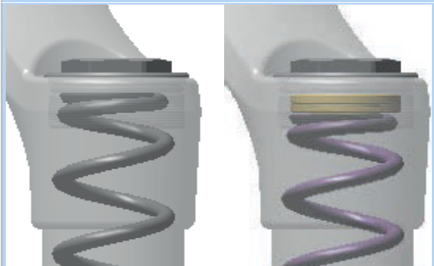
Slika 156: Uvrtanje i odvrtanje prstena za podešavanje prednapregnutosti
