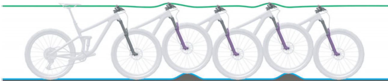
Slika 159: Optimalno ponašanje vilice pri vožnji
