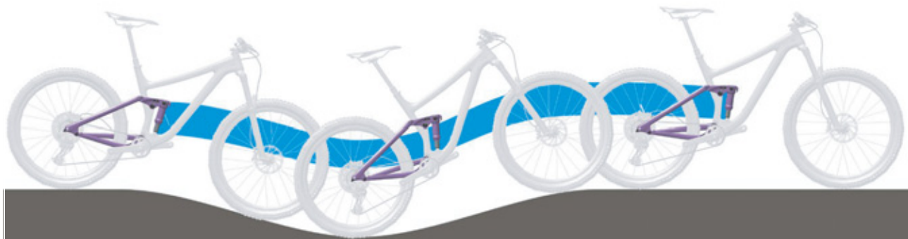
Slika 26: Optimalno ponašanje stražnjeg amortizera pri vožnji po brežuljkastom terenu
