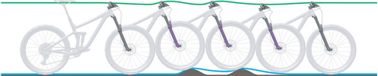
Slika 248: Presporo odskakivanje suspenzijske vilice
