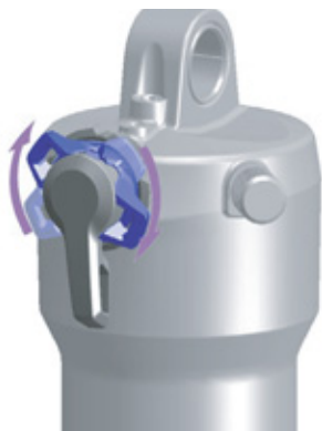
Slika 168: Povećanje krutosti kotačićem za podešavanje kompresije
