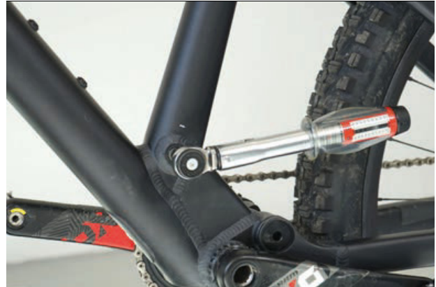
Slika 116: Pritezanje osovine cijevi sjedala
