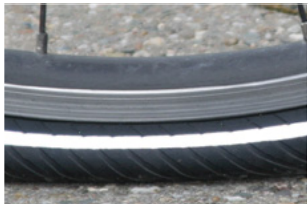
Slika 133: Prenizak tlak u gumama
