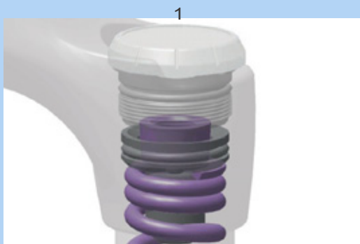
Slika 147: Uvrtnje i odvrtnje prstena za podešavanje prednapregnutosti
