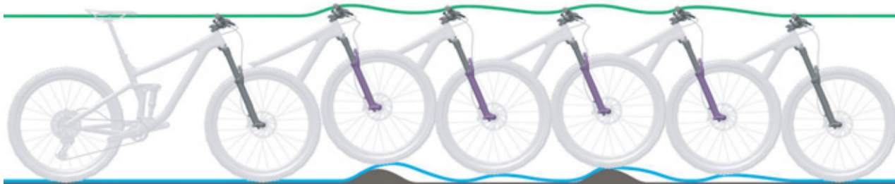
Slika 238: Prebrzo odskakivanje suspenzijske vilice
