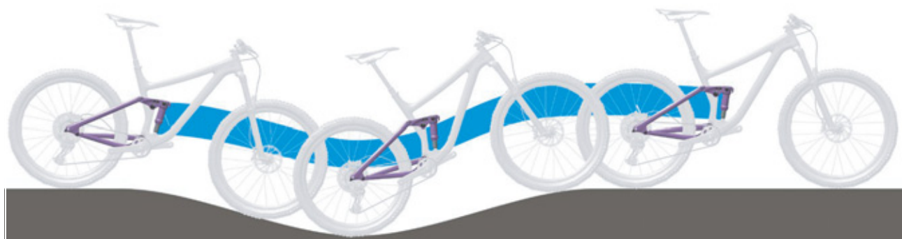
Slika 30: Optimalno ponašanje stražnjeg amortizera pri vožnji po brežuljkastom terenu
