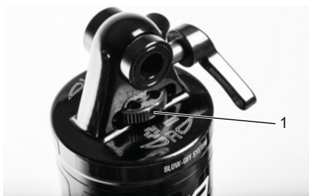
Figura 257: Rueda del regulador de niveles de tracción SR SUNTOUR (1) en el amortiguador de la horquilla trasera
