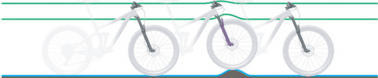
Figura 192: Condición óptima de marcha en terrenos con irregularidades
