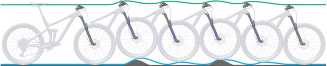
Figura 246: Descompresión demasiado rápida de la horquilla de suspensión
