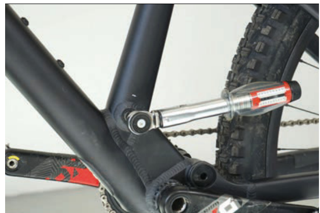
Figura 109: Apriete del eje de la tija de sillín
