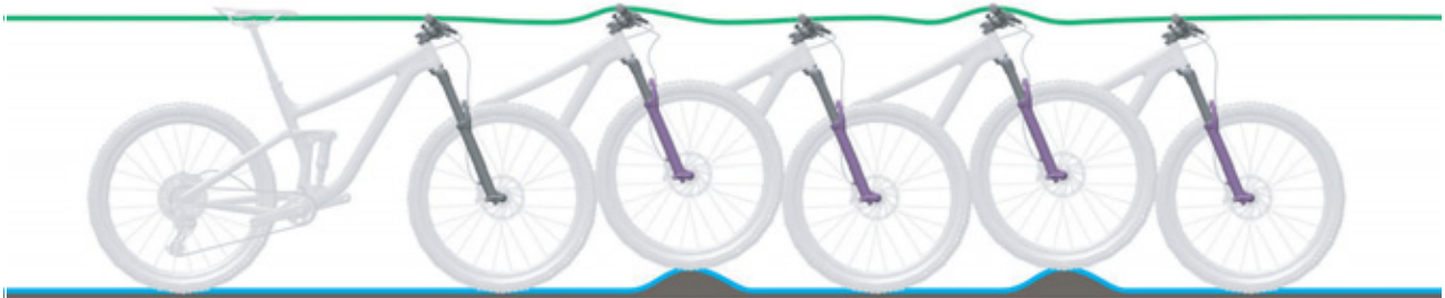
Figura 21: Condición óptima de marcha de la horquilla
