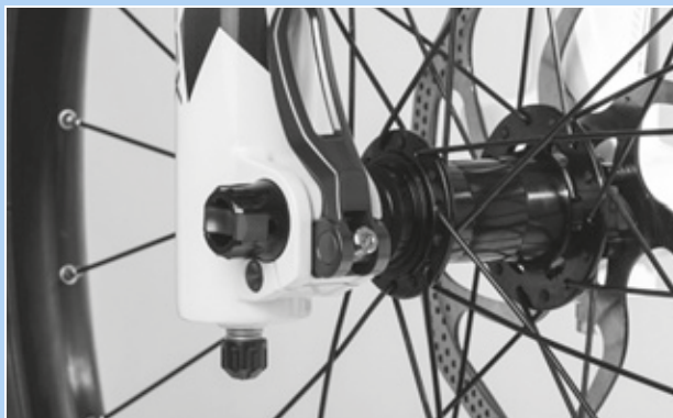
Figura 234: Ajuste de la fuerza de tensado del cierre rápido
