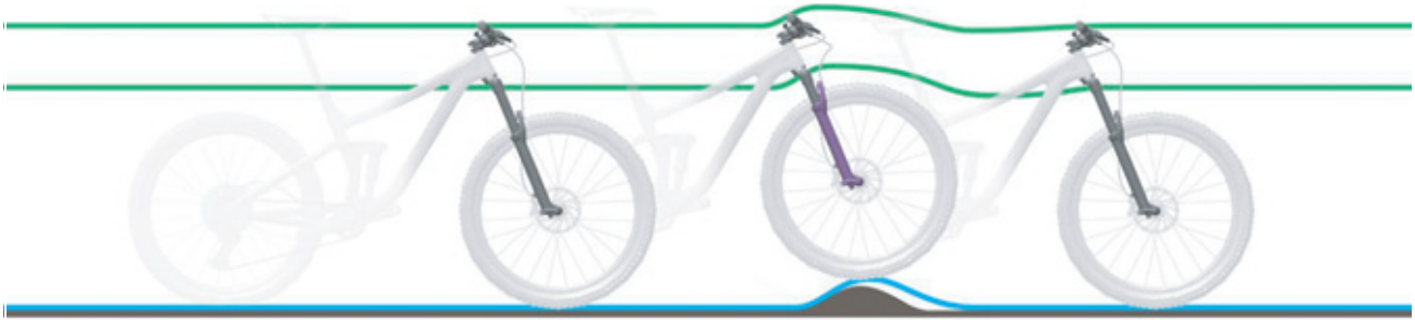
Figura 244: Amortiguación de la horquilla de suspensión demasiado dura en caso de irregularidades
