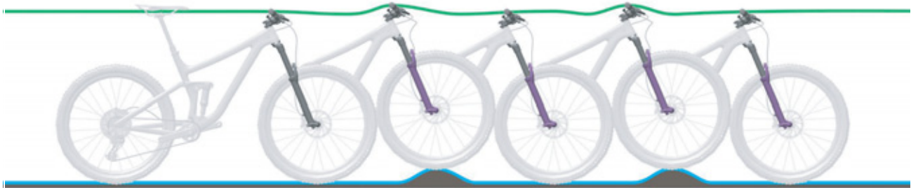
Figura 159: Condición óptima de marcha de la horquilla
