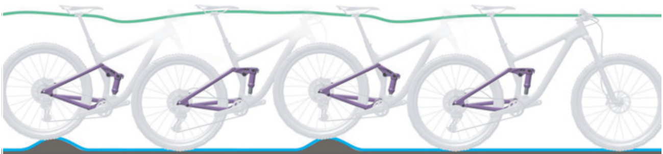
Figura 25: Condición óptima de marcha del amortiguador de la horquilla trasera
