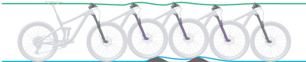
Figura 248: Descompresión demasiado lenta de la horquilla de suspensión
