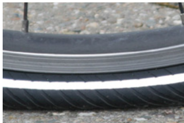
Figura 133: Presión de inflado demasiado baja
