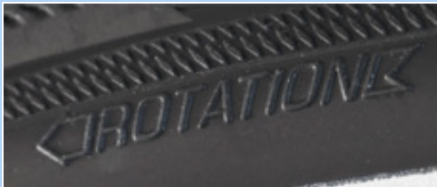
Figura 79: Flecha de sentido de la marcha
