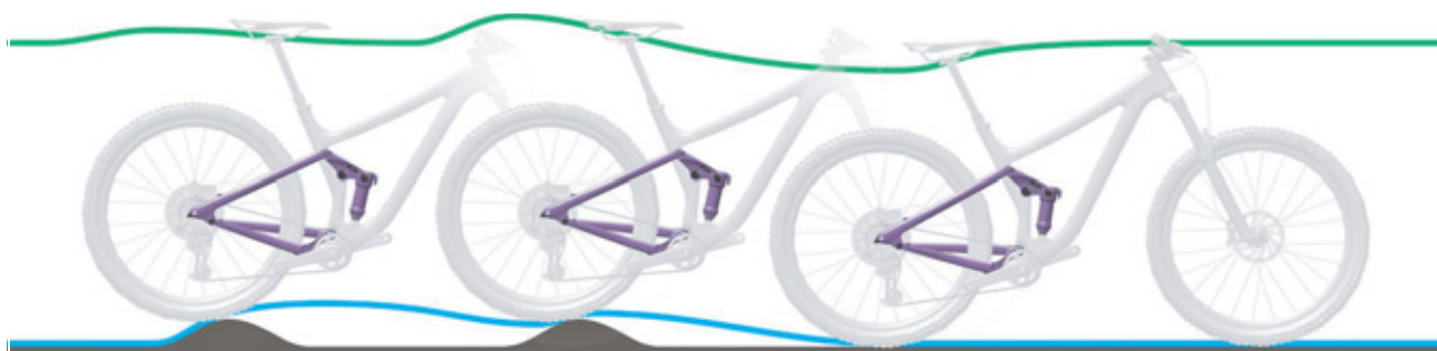
Figura 256: Descompresión demasiado lenta del amortiguador de la horquilla trasera
