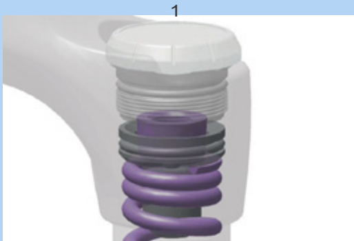
Figura 147: Enroscado y desenroscado del anillo de ajuste de la tensión previa
