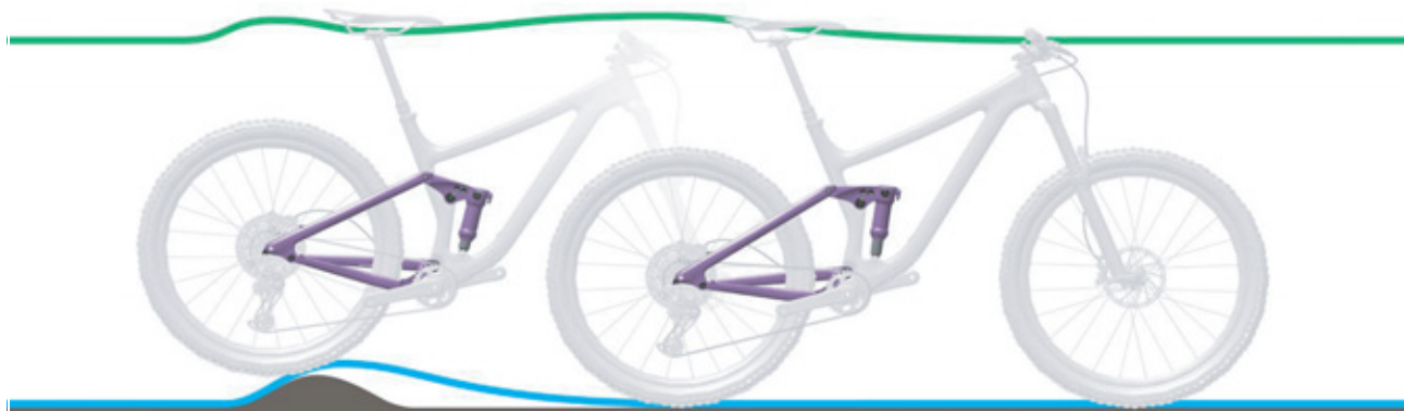
Figura 260: Amortiguación del amortiguador de la horquilla trasera demasiado dura en caso de irregularidades
