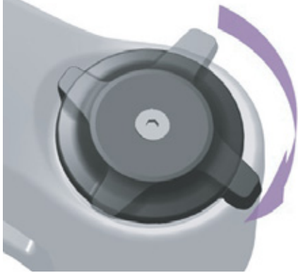
Figura 194: Ajuste para un regulador de niveles de presión más duro
