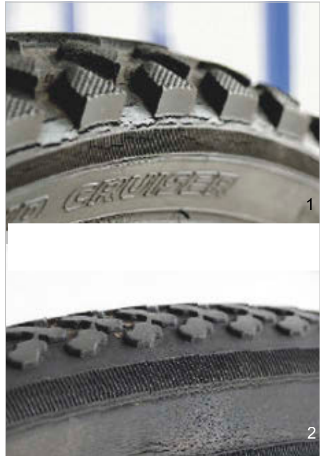
Slika 233: Primjeri pukotina uslijed zamora (1) i pukotina uslijed starenja (2)
