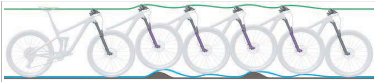
Slika 266: Prebrzo odskakivanje suspenzijske vilice
