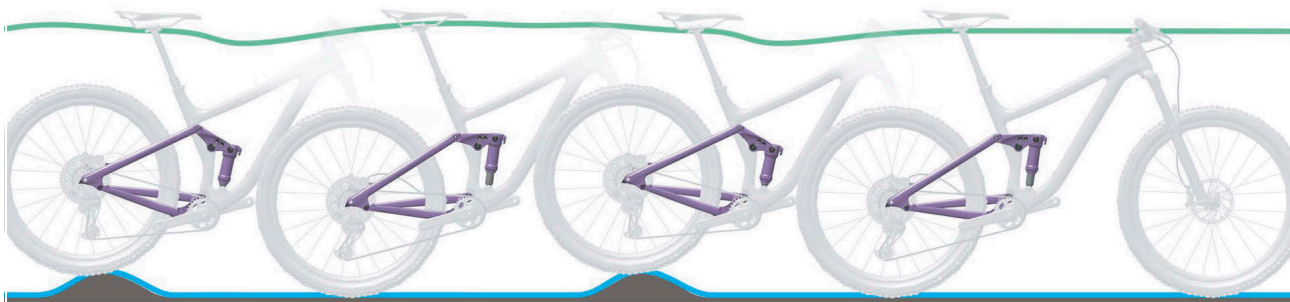
Slika 8: Optimalno ponašanje stražnjeg amortizera pri vožnji
