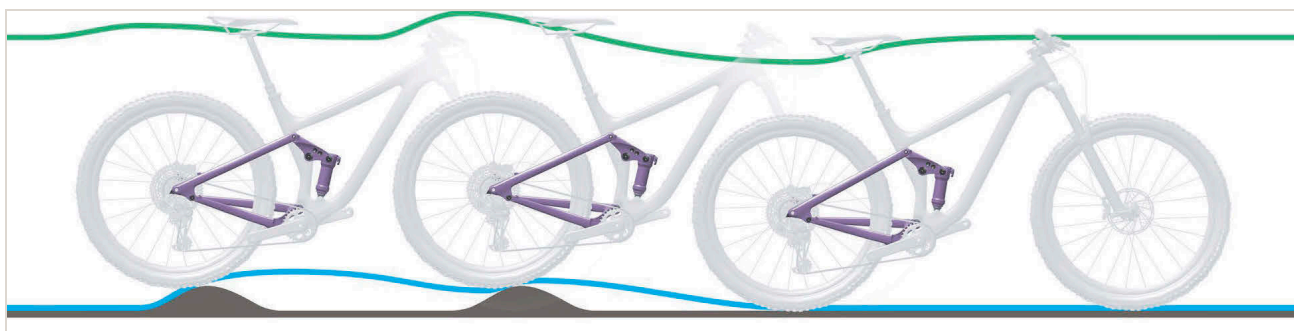
Slika 274: Presporo odskakivanje stražnjeg amortizera
