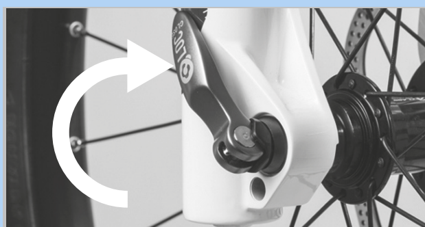
Slika 140: Zatvaranje brzog zatvarača
