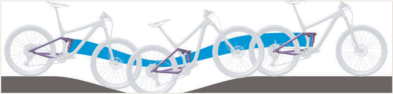
Slika 276: Premekan ovjes stražnjeg amortizera na uzbrdici
