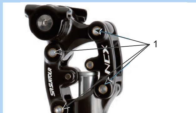
Illustration 236 : Points de lubrification de la tige de selle suspendue SR SUNTOUR
