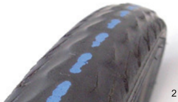
Illustration 203 : Pneu sans profil pouvant être changé (1) et pneu avec protection anti-crevaison visible (2) devant être changé
