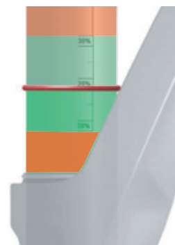
Illustration 146 : Plage de sag prescrite (vert) et plage de sag interdite (rouge)
