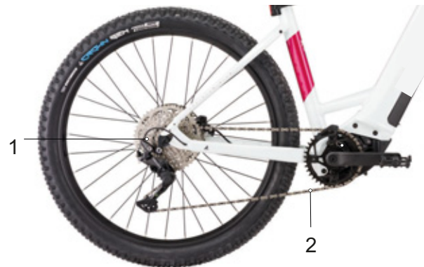
Illustration 38 : Schéma de l'entraînement à chaîne avec dérailleur
