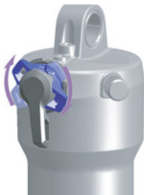
Illustration 168 : Régler le dispositif de réglage de la compression sur un niveau plus dur
