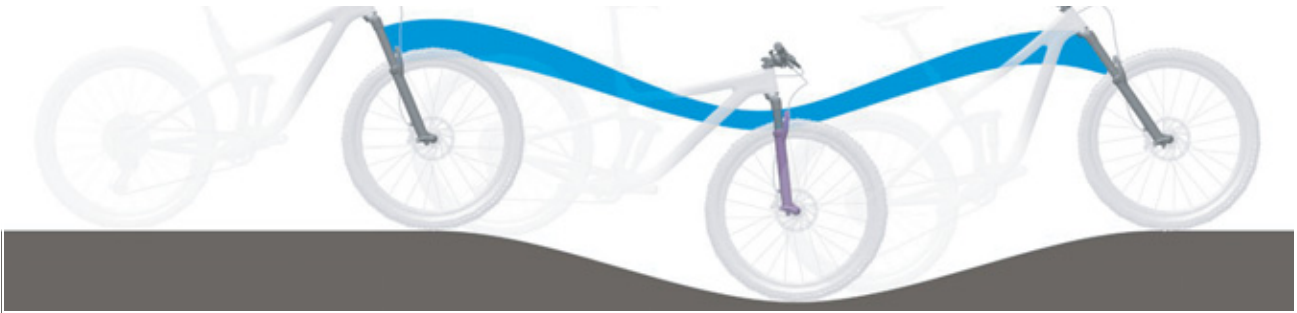
Illustration 242 : Suspension trop souple de la fourche suspendue dans les côtes
