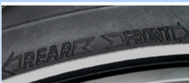
Illustration 80 : Flèche directionnelle sur les pneus VTT
