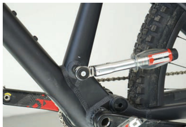
Illustration 109 : Serrer l'axe de la tige de selle
