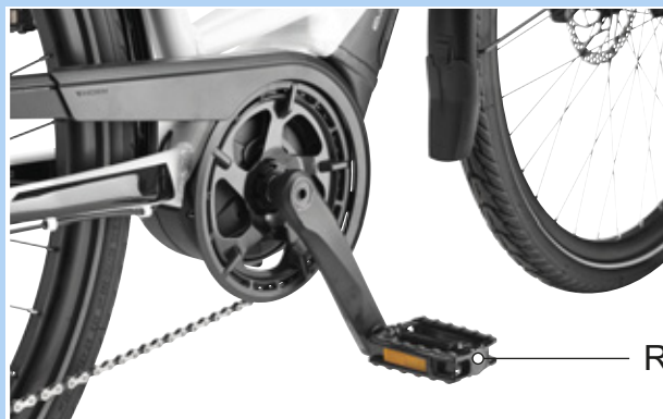
Illustration 59 : Pédale R dans le bras de manivelle droit
