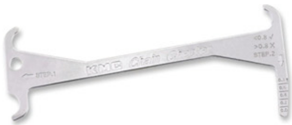
Illustration 208 : Exemple d'un gabarit de mesure KMC
