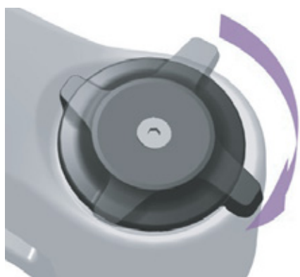
Illustration 251 : Régler le dispositif de réglage de la compression sur un niveau plus dur
