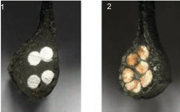
Illustration 7 : tringle en acier (1) et tringle en Kevlar (2)
