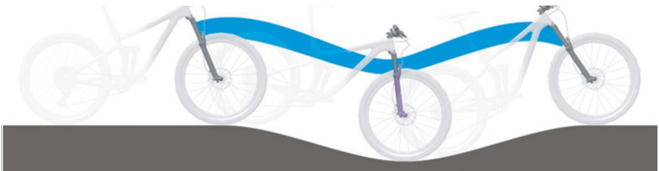
Illustration 19 : Comportement optimal de la fourche en terrain vallonné
