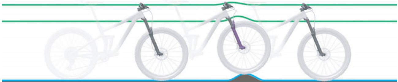
Illustration 20 : Comportement optimal de la fourche sur les irrégularités
