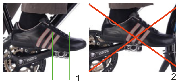
Illustration 178 : Position du pied sur la pédale, correcte (1) et incorrecte (2)
