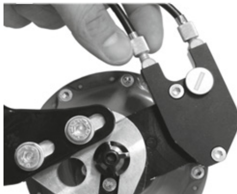
231. ábra: Külső váltóvezérléssel rendelkező ROHLOFF agyváltozatok húzásbeállítója a kötéldobozon van, ami a bal oldalon található
