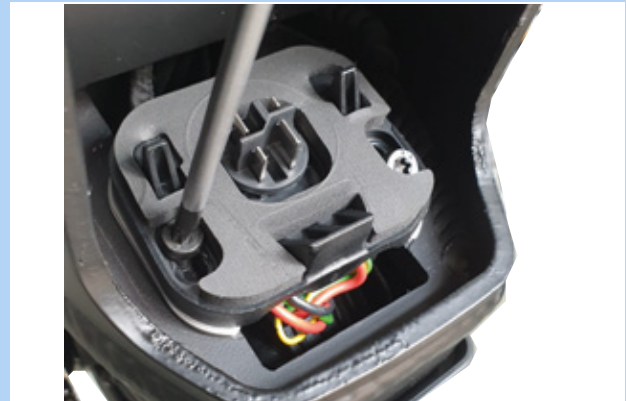
68. ábra: Akkumulátortartó csavarok oldása
