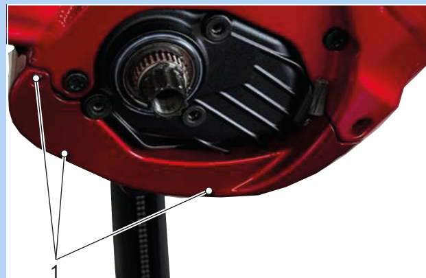
64. ábra: Alsó motorburkolat rögzítőcsavarjai (1)
