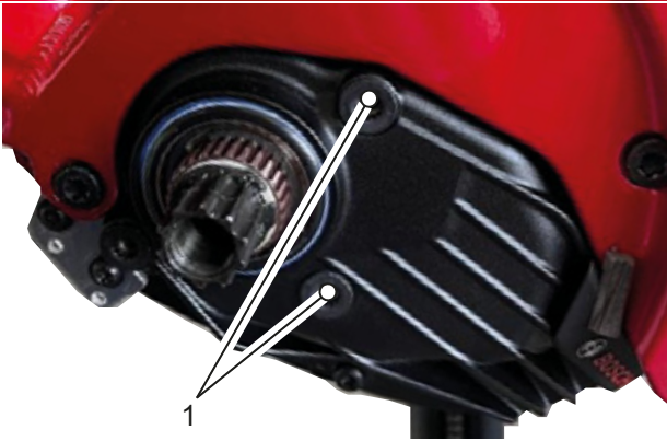
65. ábra: Rögzítőcsavarok (1) helyzete
