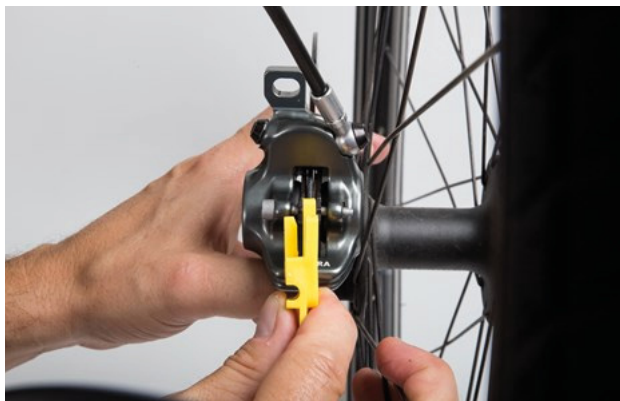
205. ábra: Fékbetét ellenőrzése beépített állapotban a szállítási rögzítés segítségével
