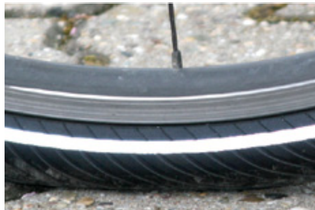
139. ábra: Helyes töltőnyomás. A gumiabroncs alakja a testsúly terhe alatt alig változik
