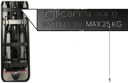
177. ábra: A csomagtartón fel van tüntetve maximális teherbírása (1)
