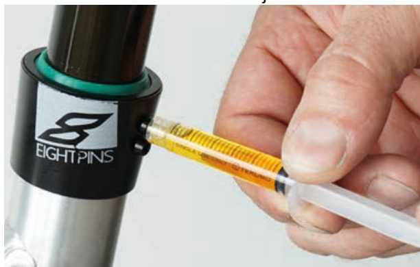
201. ábra: eightpins nyeregcső kenése
