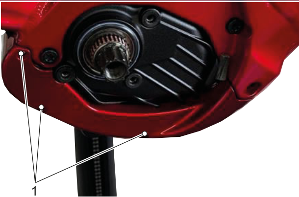
74. ábra: Alsó motorburkolat rögzítőcsavarjai (1)
