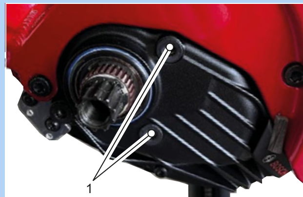
73. ábra: Rögzítőcsavarok (1) helyzete
