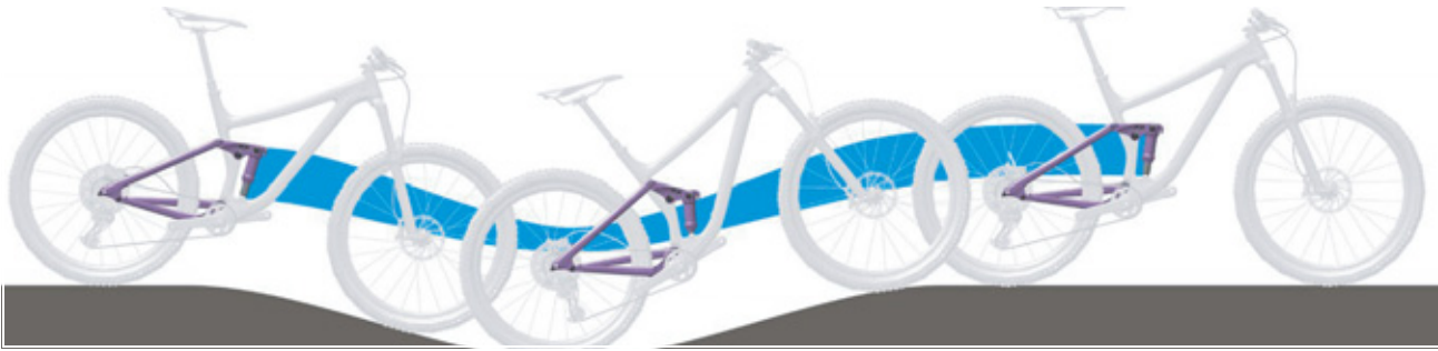
266. ábra: A hátsó lengéscsillapító túl puha rugózása hegymenetben
