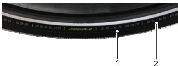
202. ábra: Guminyomás bar-ban (1) és psi-ben (2)
