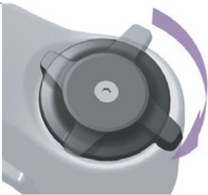
251. ábra: A nyomásfokozat-beállító keményebb beállítása
