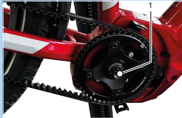
63. ábra: A szíjtárcsa meglazítása
