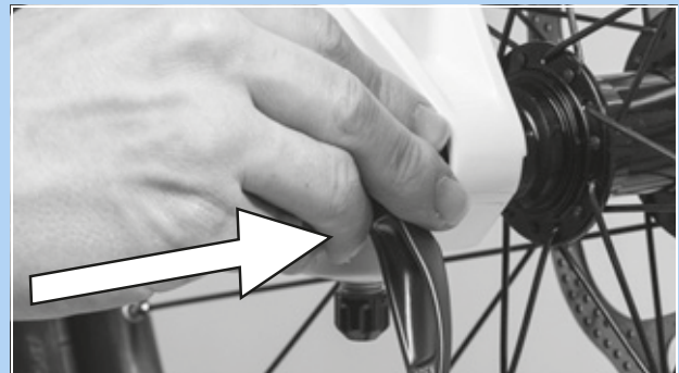
92. ábra: A gyorsár betolása nyilirányban
