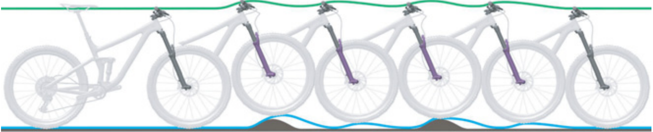
238. ábra: A teleszkópos villa túl gyors kirugózása
