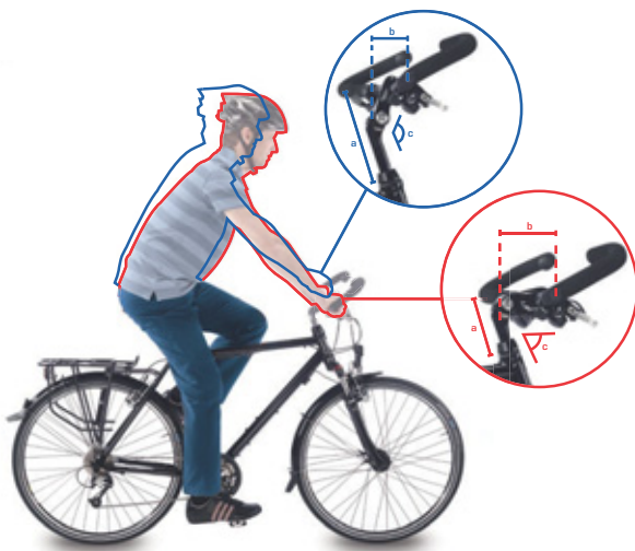
130. ábra: Városi kerékpár (kék) és túrakerékpár (piros) a szög változtatásával
