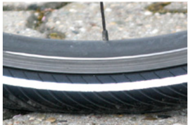
132. ábra: Helyes töltőnyomás. A gumiabroncs alakja a testsúly terhe alatt alig változik
