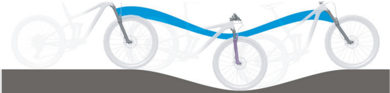
242. ábra: A teleszkópos villa túl puha rugózása hegymenetben
