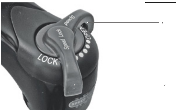
243. ábra: A nyomásfokozat-beállító keményebb beállítása
