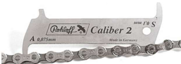
211. ábra: ROHLOFF mérőidom példája
