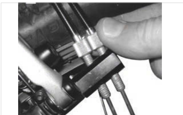
258. ábra: Belső váltóvezérléssel rendelkező ROHLOFF agyváltózatok húzásbeállítója a húzásellentartón van
