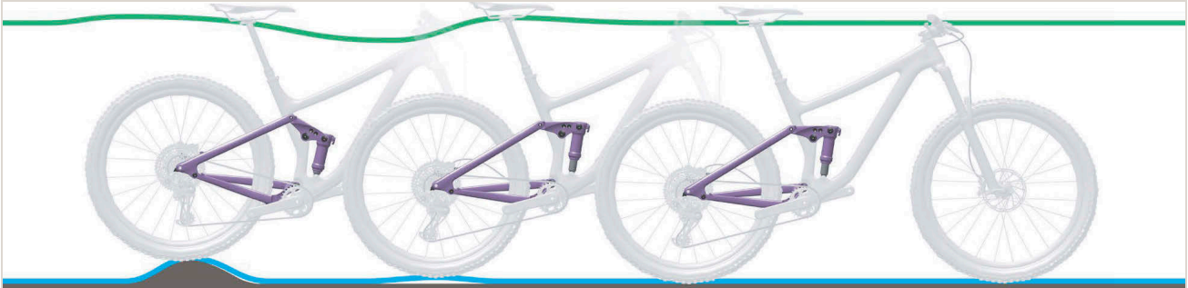
272. ábra: A hátsó lengéscsillapító túl gyors kirugózása
