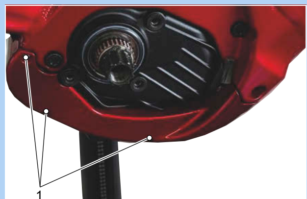
120. ábra: Alsó motorburkolat rögzítőcsavarjai (1)
