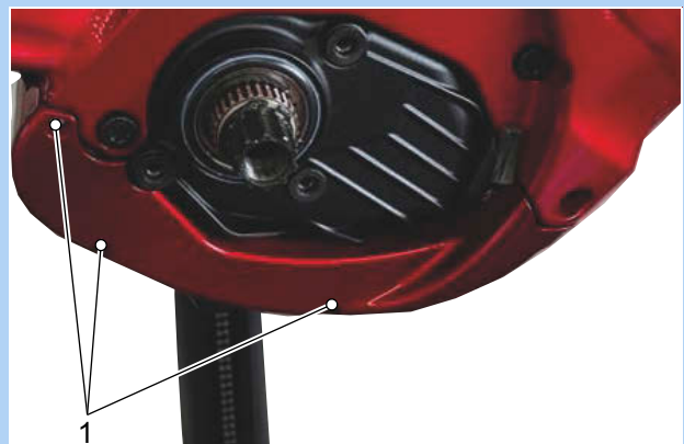
110. ábra: Alsó motorburkolat rögzítőcsavarjai (1)
