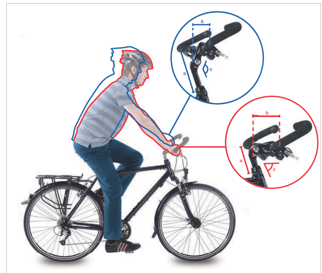
165. ábra: Városi kerékpár (kék) és túrakerékpár (piros) a szög változtatásával
