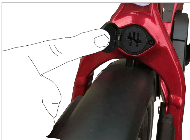
Afbeelding 193: ZEMO elektrische aansluiting
