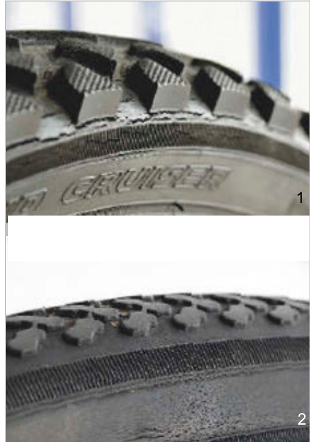
Afbeelding 233: Voorbeelden van vermoeiingsscheuren (1) en verouderingsscheuren (2)
