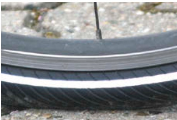
Afbeelding 167: Juiste vuldruk. De band is onder de belasting van het lichaamsgewicht nauwelijks vervormd
