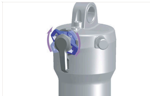
Afbeelding 197: Drukdemperafsteller harder afstellen
