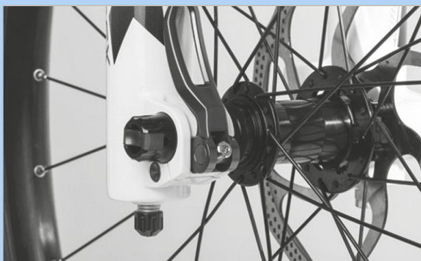
Afbeelding 135: Perfecte stand van de spanhendel
