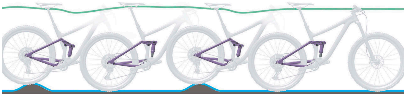
8 paveikslėlis. Optimali galinio amortizatoriaus važiavimo charakteristika
