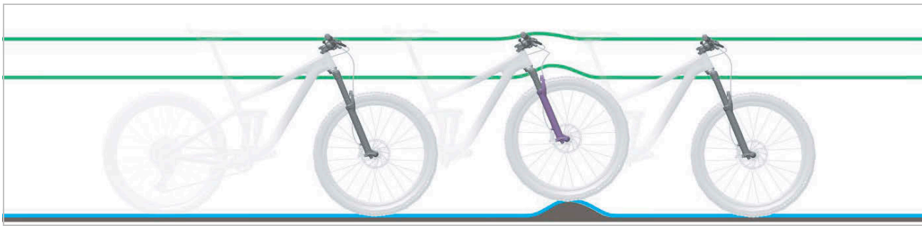
20 paveikslėlis. Optimali amortizuojančios šakės važiavimo charakteristika nelygumuose
