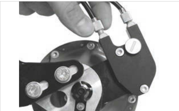
259 paveikslėlis. ROHLOFF stebulės variantas su išoriniu perjungimo valdymu turi įtempimo reguliatorius ant kabelių dėžės kairėje
