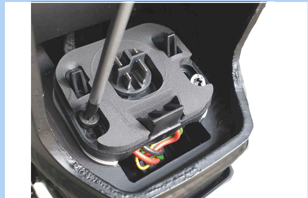
114 paveikslėlis. Akumuliatoriaus laikiklio varžtų atsukimas
