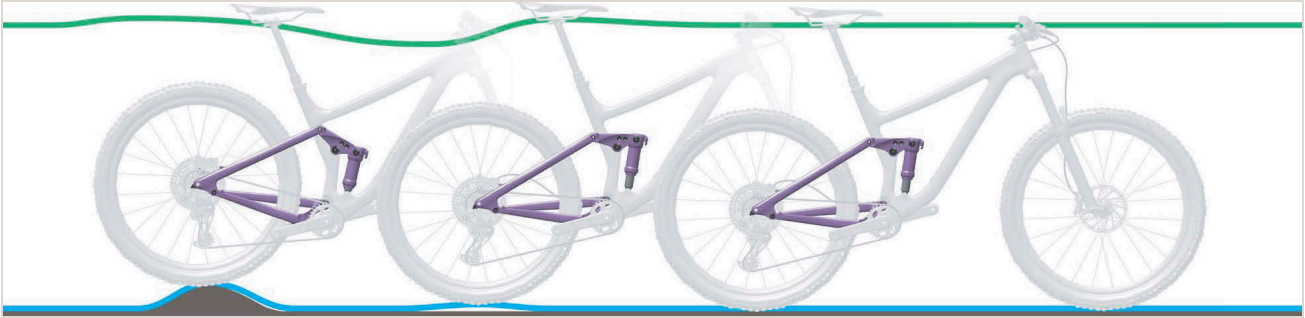
272 paveikslėlis. Per greitas galinio amortizatoriaus atšokimas
