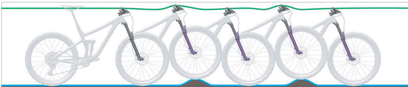
21 paveikslėlis. Optimali amortizuojančio šakės važiavimo charakteristika
