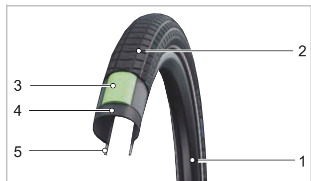
30 paveikslėlis. Atvirų padangų konstrukcija
