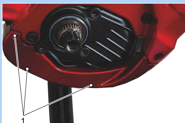
110 paveikslėlis. Apatinio variklio dangčio tvirtinimo varžtai (1)
