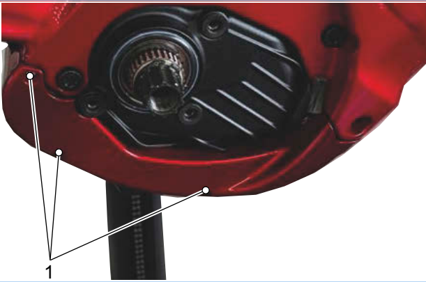
120 paveikslėlis. Apatinio variklio dangčio tvirtinimo varžtai (1)
