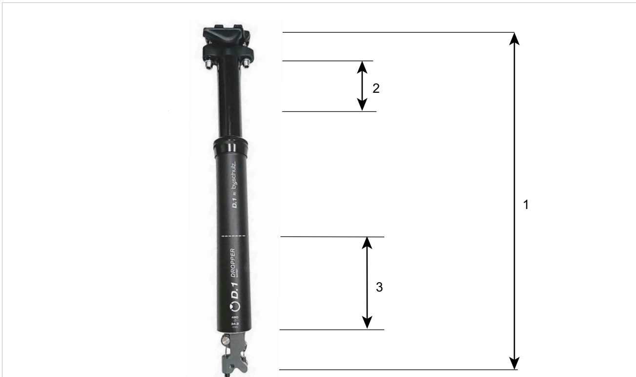
44 paveikslėlis. „by.schulz“ G.1 balnelio stovo konstrukcija
