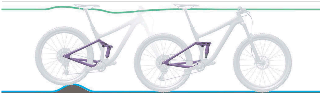
198 paveikslėlis. Optimali galinio amortizatoriaus važiavimo charakteristika važiuojant per nelygumus
