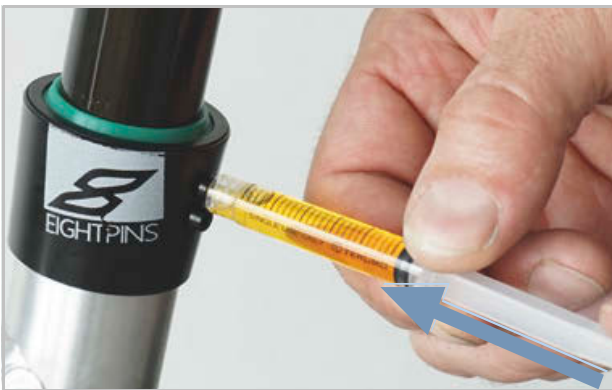
230 paveikslėlis. Sutepkite EIGHTPINS balnelio stovą
