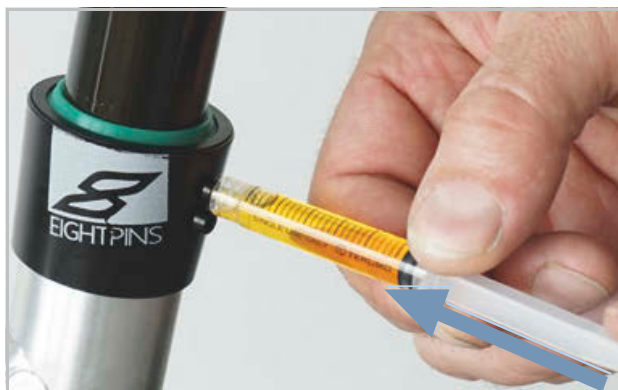
Rysunek 216: Smarowanie sztycy podsiodłowej EIGHTPINS
