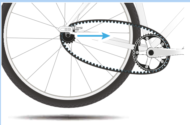
Rysunek 93: Przesuwanie tylnego koła do przodu
