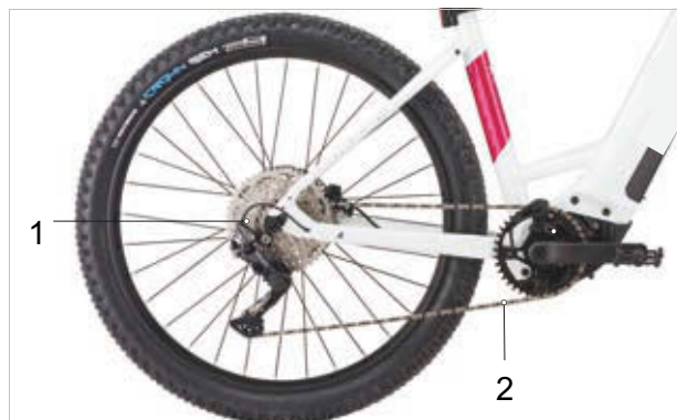
Rysunek 50: Schemat napędu łańcuchowego z przerzutką
