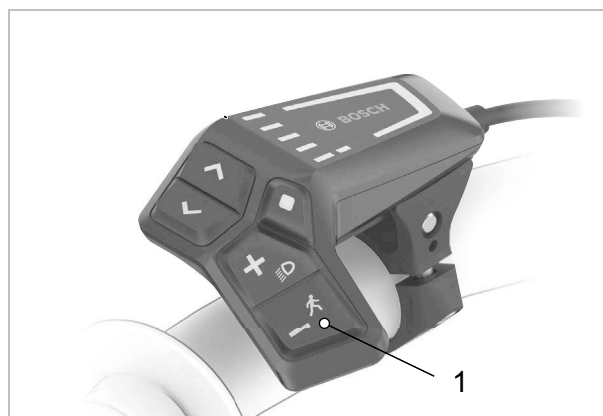
Rysunek 199: Położenie przycisku mechanizmu wspomagającego pchanie (1)
