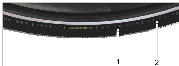
Rysunek 217: Dane ciśnienia w oponach w barach (1) i psi (2)
