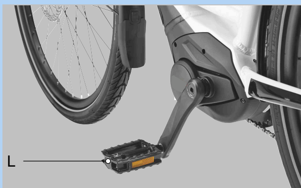
Rysunek 128: Pedał „L” w lewym ramieniu korby
