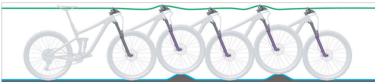
Rysunek 18: Optymalne działanie widełca amortyzowanego
