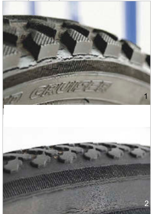
Rysunek 219: Przykłady pęknięć zmęczeniowych (1) i w wyniku starzenia się (2)
