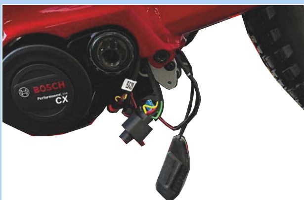
Rysunek 98: Silnik bez pokrywy
