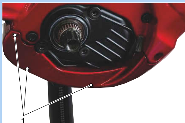
Rysunek 96: Śruby mocujące dolną pokrywę silnika (1)
