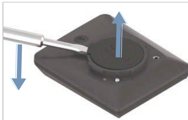
Rysunek 172: Podważanie pokrywy komory baterii
