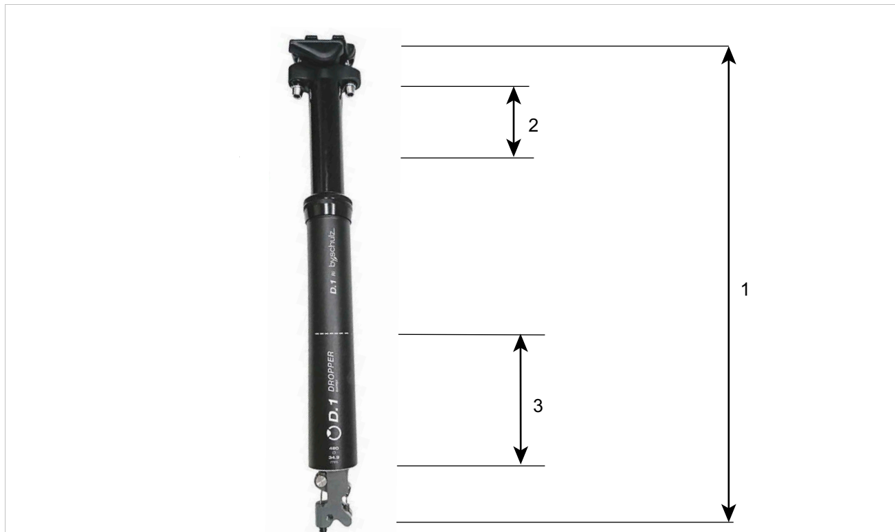
Rysunek 43: Budowa sztycy podsiodłowej by.Schulz G.1
