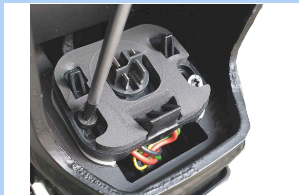
Rysunek 100: Odkręcanie śrub akumulatora
