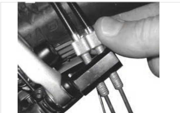
Rysunek 244: Wersje piast ROHLOFF z wewnętrznym sterowaniem mechanizmu zmiany biegów posiadają regulator naprężenia na uchwycie linki
