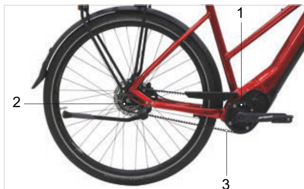
Rysunek 51: Schemat napędu paskowego
