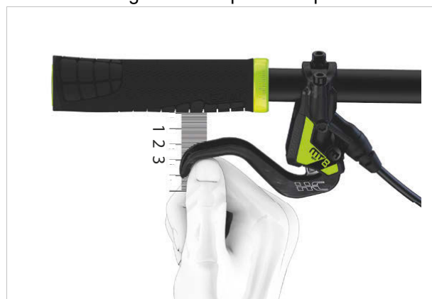
Figura 172: Posicionamiento del freno de mano
