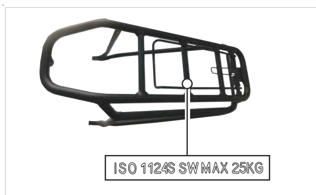
Figura 203: En el portaequipajes se indica la máxima capacidad de carga
