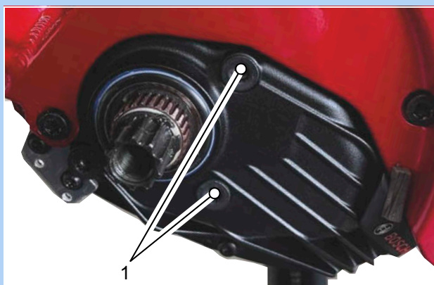
Figura 111: Posición de los tornillos de fijación (1)
