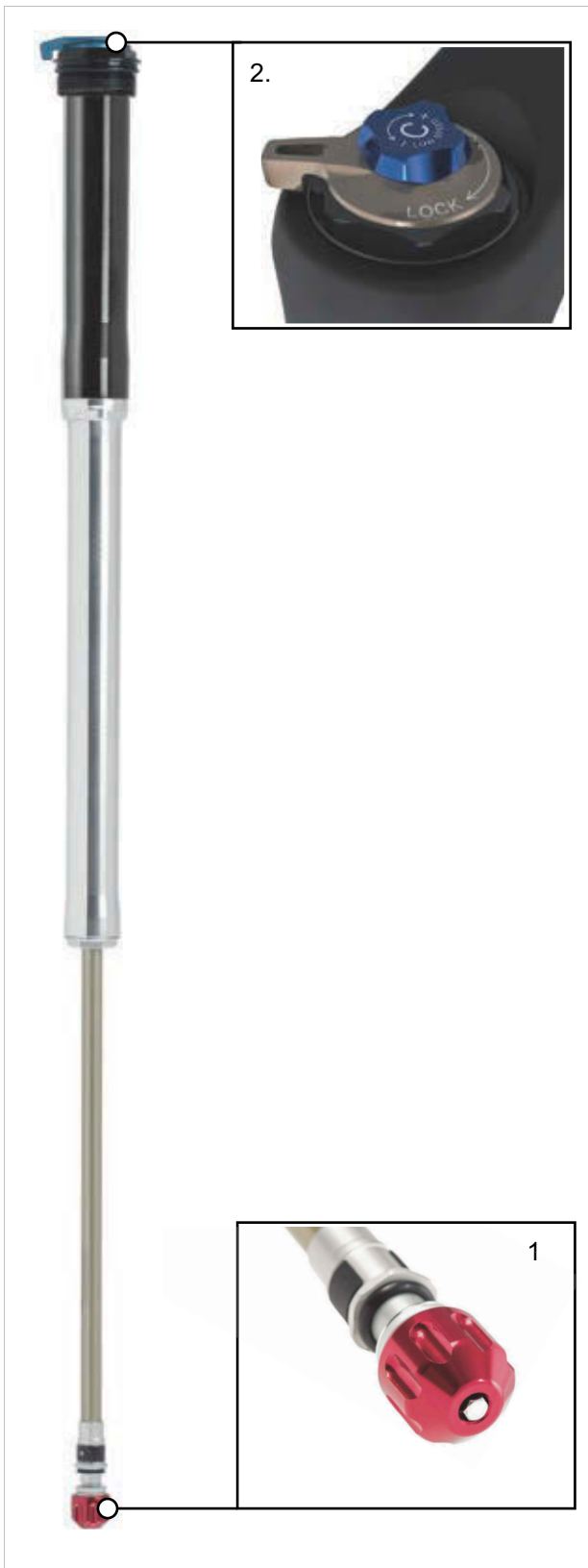
Figura 27: Elementos de mando del cartucho LORC-PCS
