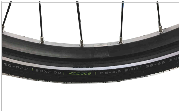
Figura 29: Ejemplo: Información en la cubierta
