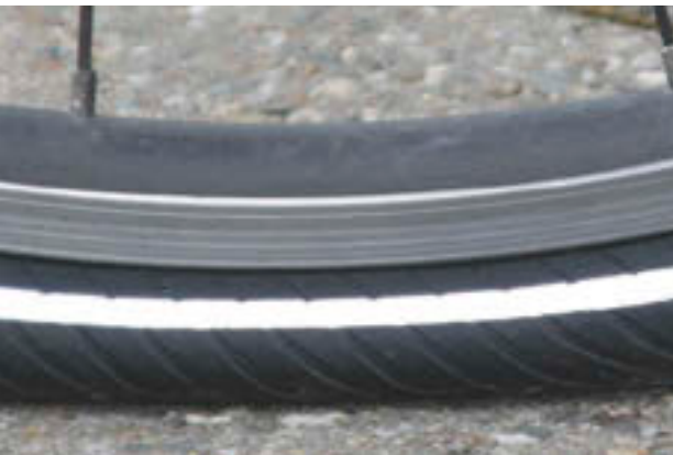
Figura 168: Presión de inflado demasiado baja
