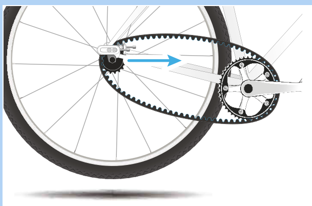
Figura 107: Desplazar la rueda trasera hacia delante
