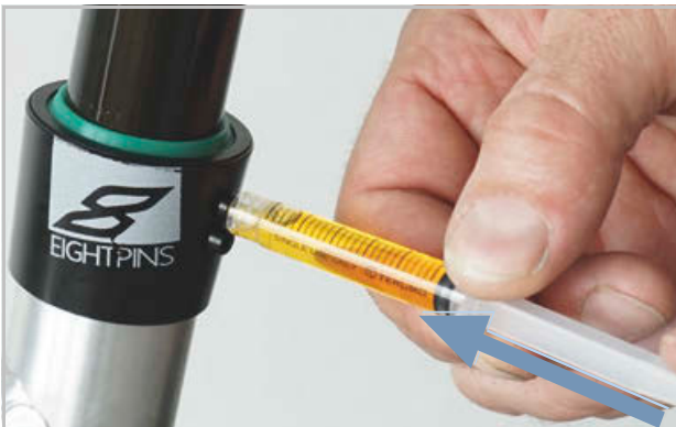
Figura 230: Lubricación de la tija de sillín EIGHTPINS
