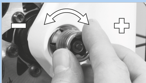
Figura 139: Ajuste de la tensión
