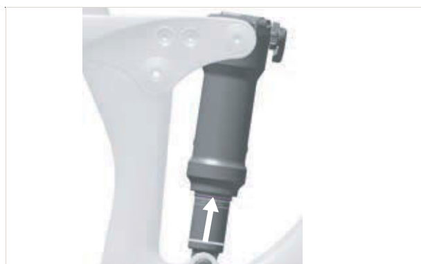
Figura 180: Desplazamiento de la junta tórica en el amortiguador de la horquilla trasera
