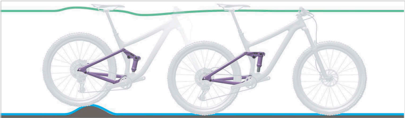
Figura 198: Condición óptima de marcha del amortiguador de la horquilla trasera en caso de irregularidades
