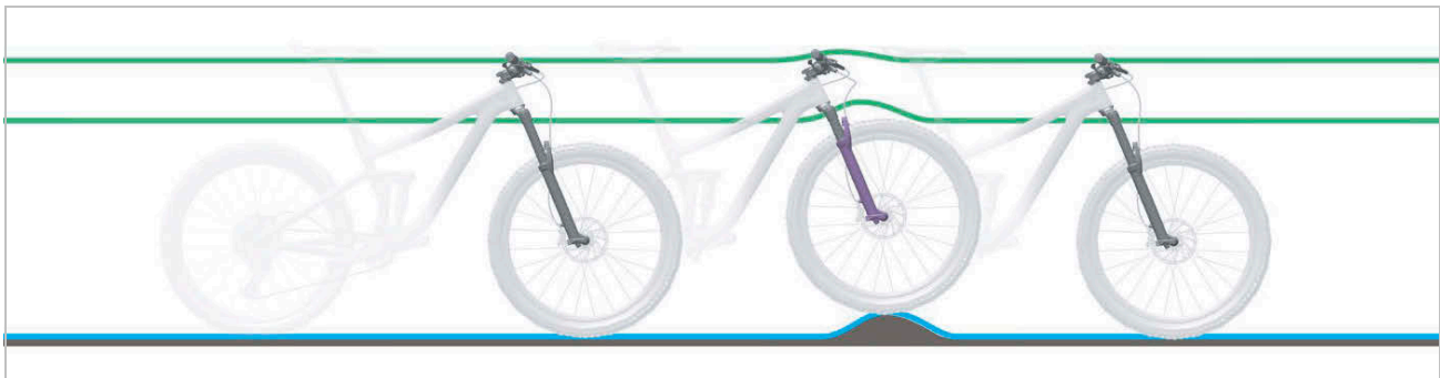
Figura 222: Amortiguador de niveles de presión ajustado en duro y en blando
