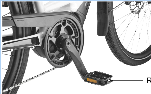
Figura 105: Pedal R en el brazo de manivela derecho
