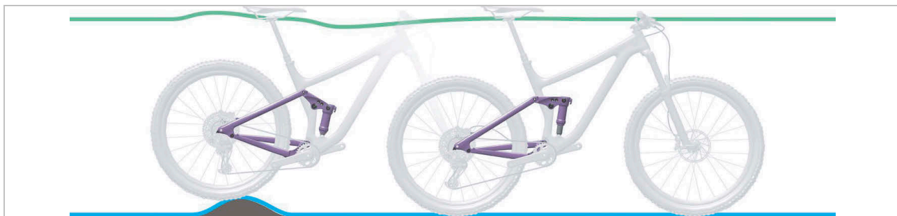
Figura 7: Condición óptima de marcha del amortiguador de la horquilla trasera en caso de irregularidades
