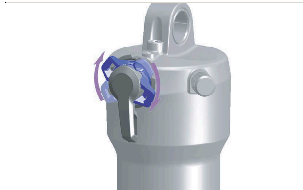
Figura 197: Ajustar el regulador de niveles de presión más duro
