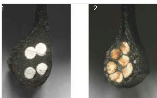
Figura 31: Núcleo de acero (1) y núcleo de Kevlar (2)
