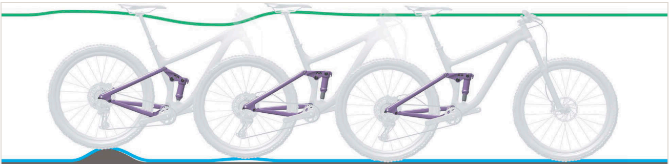
Figura 272: Descompresión demasiado rápida del amortiguador de la horquilla trasera
