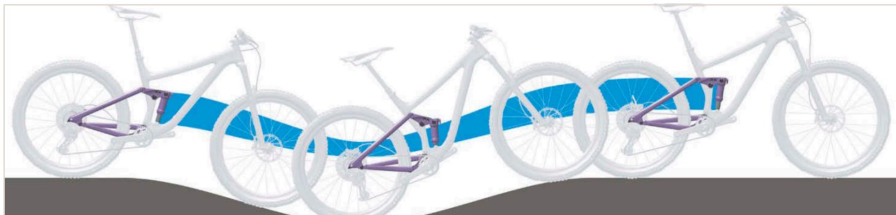
Figura 276: Suspensión del amortiguador de la horquilla trasera demasiado blanda en montaña
