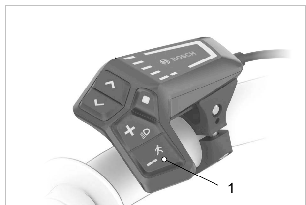
Figura 212: Posición del botón de ayuda para el desplazamiento (1)
