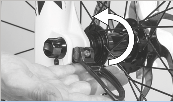
Figura 134: Presión de la palanca de cierre rápido en la dirección de la flecha
