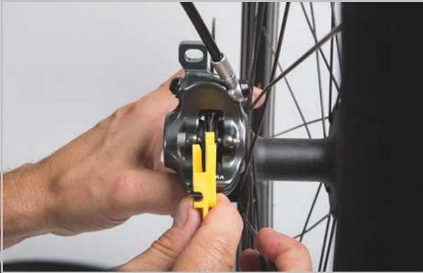
Figura 234: Comprobación de la almohadilla de freno montada con ayuda del seguro de transporte
