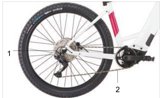
Figura 51: Esquema de la transmisión por cadena con cambio de cadena
