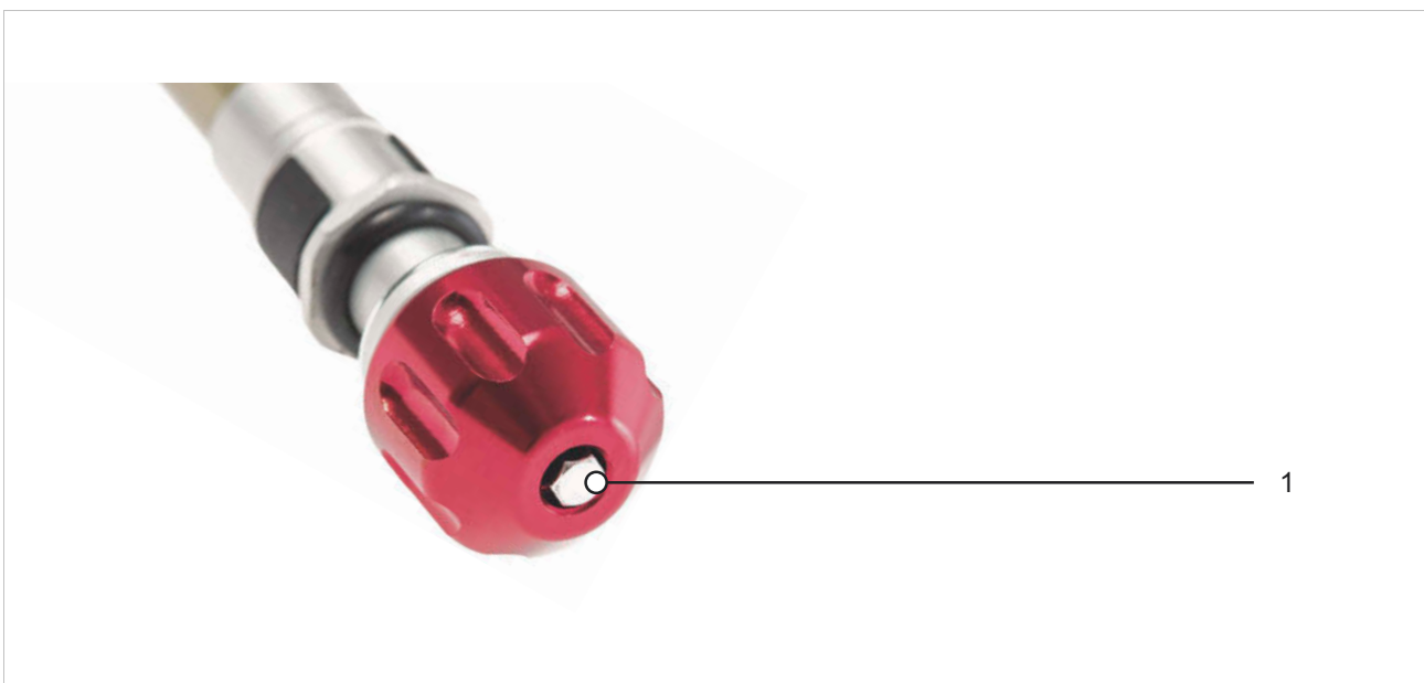
Figura 269: Ejemplo de regulador de niveles de tracción (horquilla) SR SUNTOUR (1)
