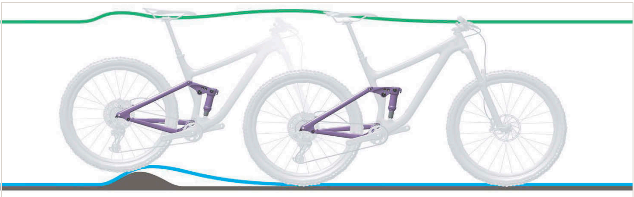
Figura 278: Amortiguación del amortiguador de la horquilla trasera demasiado dura en caso de irregularidades
