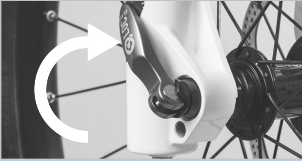
Figura 140: Cierre del cierre rápido
