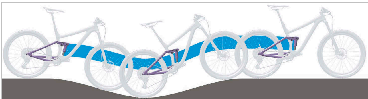
Figura 6: Condición óptima de marcha del amortiguador de la horquilla trasera sobre un terreno accidentado
