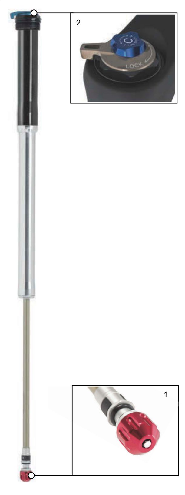
Figura 26: Elementos de mando del LOR
