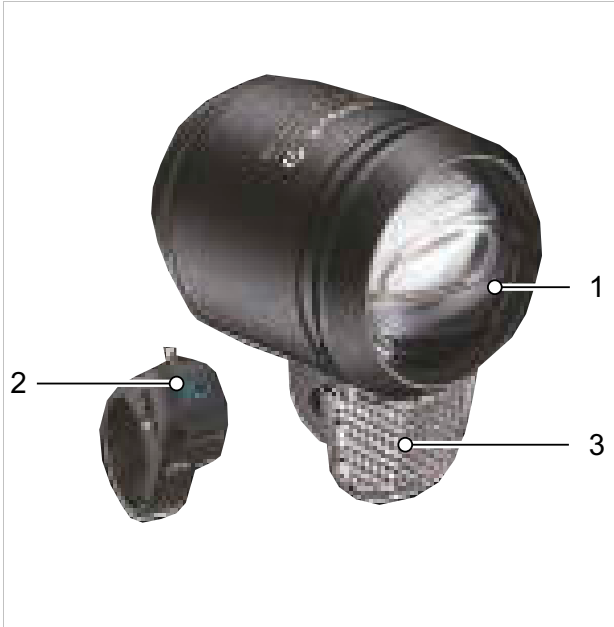
Figura 58: LITEMOVE, AE-130 con faro (1), interruptor de luz de carretera en el manillar (2) y reflector (3)
