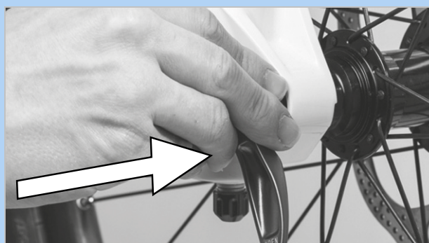
Figura 138: Inserción del cierre rápido en la dirección de la flecha
