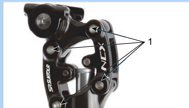
Figura 264: Puntos de lubricación de la tija de sillín de muelle SR SUNTOUR
