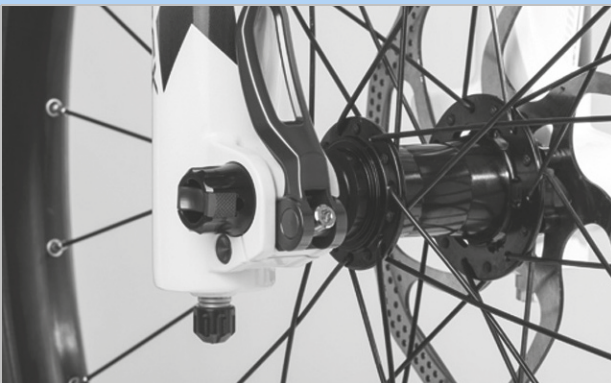
Figura 135: Posición perfecta de la palanca tensora
