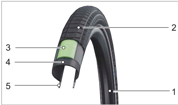
Figura 30: Estructura de las cubiertas abiertas
