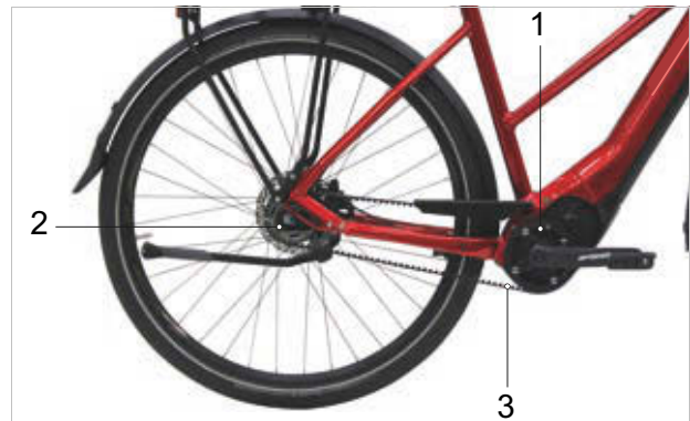
Figura 52: Esquema de la transmisión por correa
