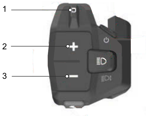
Illustration 131 : Position du bouton à bascule de navigation (1) et des touches Plus (2) et Moins (3)
