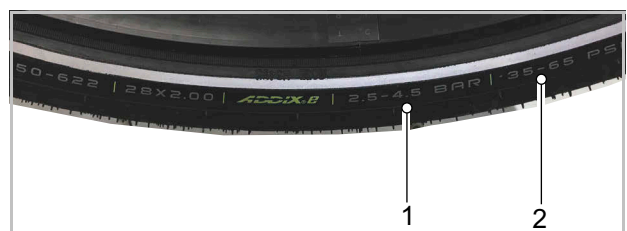
Illustration 165 : Indication de pression des pneus en bar (1) et psi (2)
