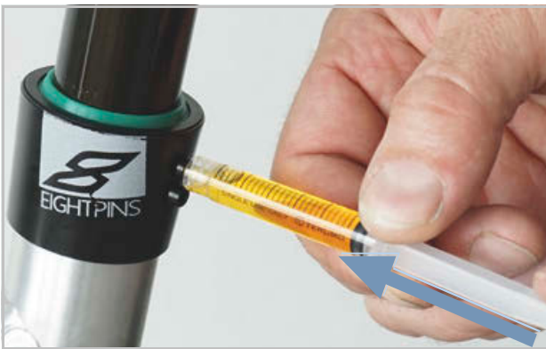
Illustration 164 : Lubrifier une tige de selle EIGHTPINS
