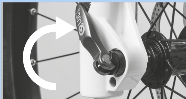
Illustration 81 : Fermer l'attache rapide
