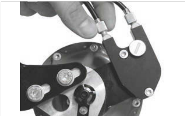
Illustration 183 : Sur les versions de moyeux ROHLOFF avec commande externe du changement de vitesse, le dispositif de réglage de la tension est situé sur le boîtier de câbles qui est placé sur le côté gauche
