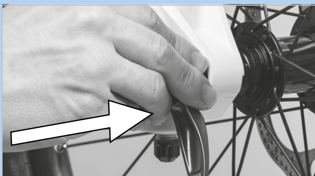
Illustration 79 : Enfoncez l'attache rapide dans le sens de la flèche
