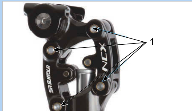
Illustration 188 : Points de lubrification de la tige de selle suspendue SR SUNTOUR
