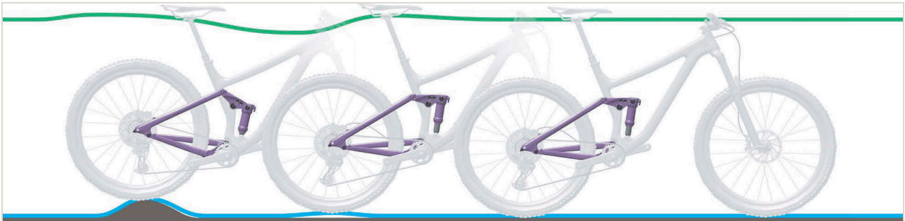
Illustration 197 : Détente trop rapide de l'amortisseur arrière
