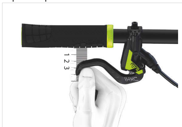
Illustration 115 : Positionnement du frein à main
