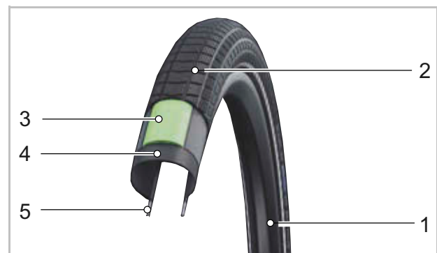
Illustration 26 : Structure des pneus ouverts
