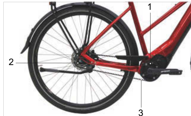
Illustration 46 : Schéma de l'entraînement à courroie
