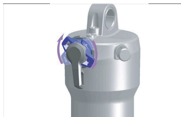
Illustration 148 : Régler le dispositif de réglage de la compression sur un niveau plus dur
