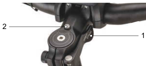
Illustration 83 : Potence, modèle II avec levier de serrage de l'attache rapide de la potence (1) et bouton de déblocage (2)
