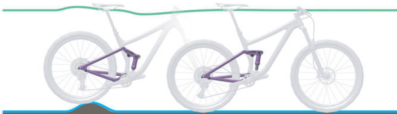
Figura 164: Optimali galinio amortizatoriaus važiavimo charakteristika nelygumuose
