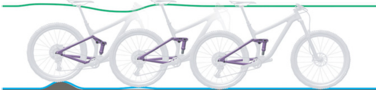
262 paveikslėlis. Per greitas galinio amortizatoriaus atšokimas
