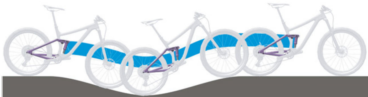
Figura 26: Optimali galinio amortizatoriaus važiavimo charakteristika kalvota vietovėje
