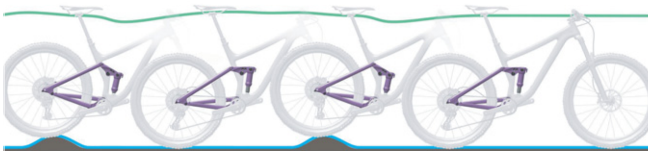
Figura 25: Optimali galinio amortizatoriaus važiavimo charakteristika
