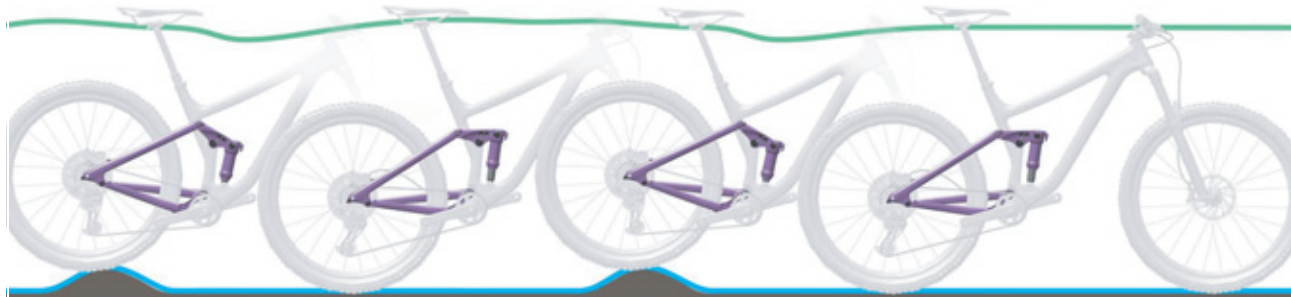
Figura 29: Optimali galinio amortizatoriaus važiavimo charakteristika
