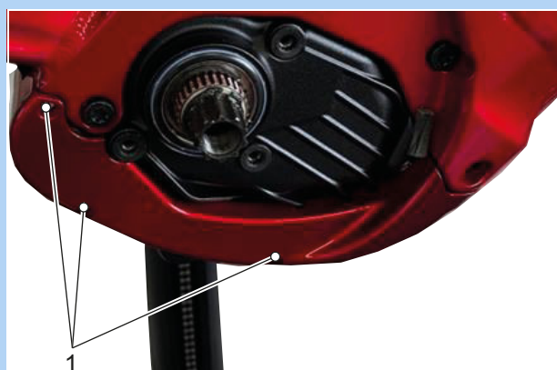
64 paveikslėlis. Apatinio variklio dangčio tvirtinamieji varžtai (1)
