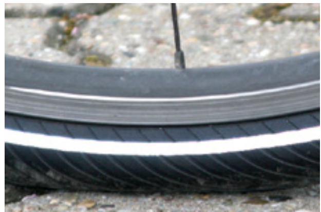
132 paveikslėlis. Tinkamas pripildymo slėgis. Padanga vos deformuota veikiant kūno svoriui
