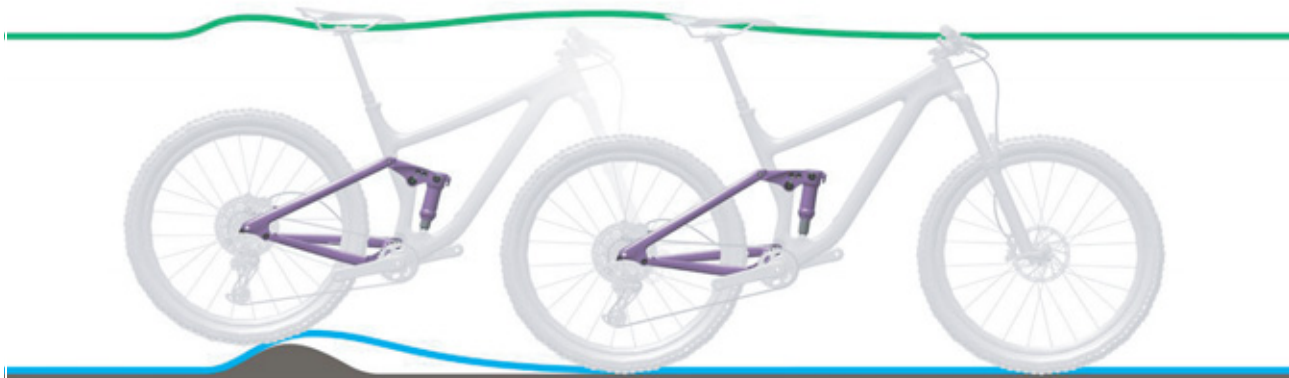
268 paveikslėlis. Per kietas galinio amortizatoriaus amortizavimas nelygumuose
