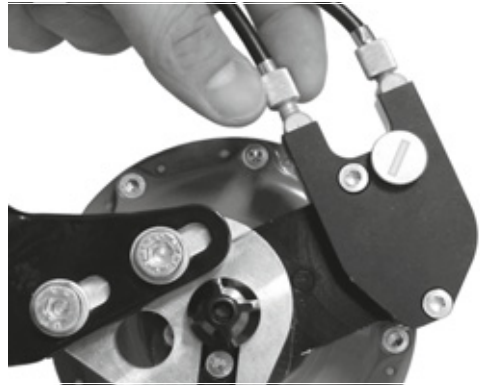
231 paveikslėlis. ROHLOFF stebulės variantas su išoriniu perjungimo valdymu turi įtempimo reguliatorius ant kabelių dėžės kairėje
