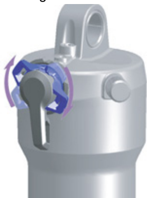
168 paveikslėlis. Kompresijos reguliatorių nustatykite kietesnėje padėtyje
