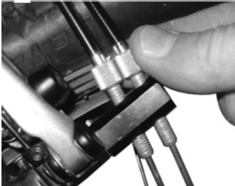
230 paveikslėlis. ROHLOFF stebulės variantas su vidiniu perjungimo valdymu turi įtempimo reguliatorių atraminiame įtempimo įtaise
