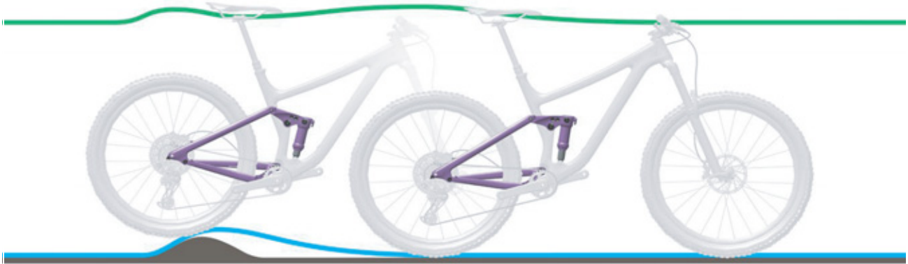
260 paveikslėlis. Per kietas galinio amortizatoriaus amortizavimas nelygumuose
