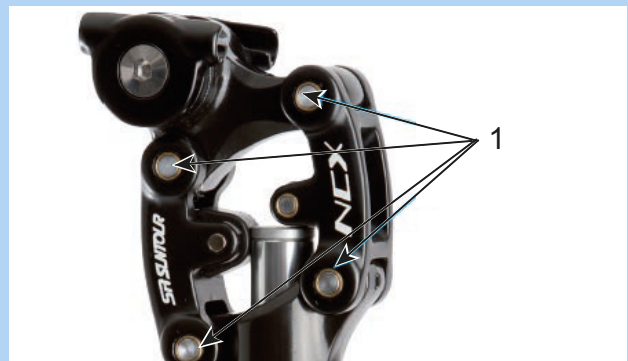
236 paveikslėlis. Spyruoklinio balnelio stovo SR SUNTOUR sutepimas
