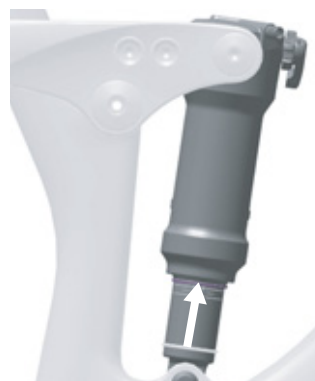
Obr. 158: Posunutí O-kroužku na tlumiči zadního odpružení
