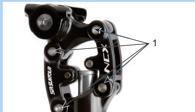
Obr. 236: Mazací body odpružené sedlovky SR SUNTOUR
