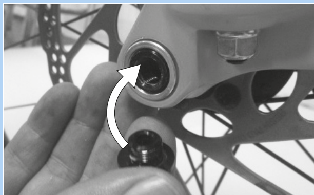
Obr. 83: Nasazení pojistného šroubu
