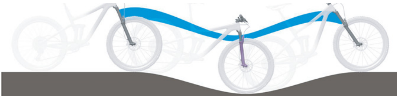
Obr. 242: Příliš měkké odpružení odpružené vidlice v horách
