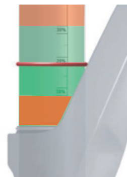
Obr. 146: Předepsaný rozsah SAG (zelený) a zakázaný rozsah SAG (červený)
