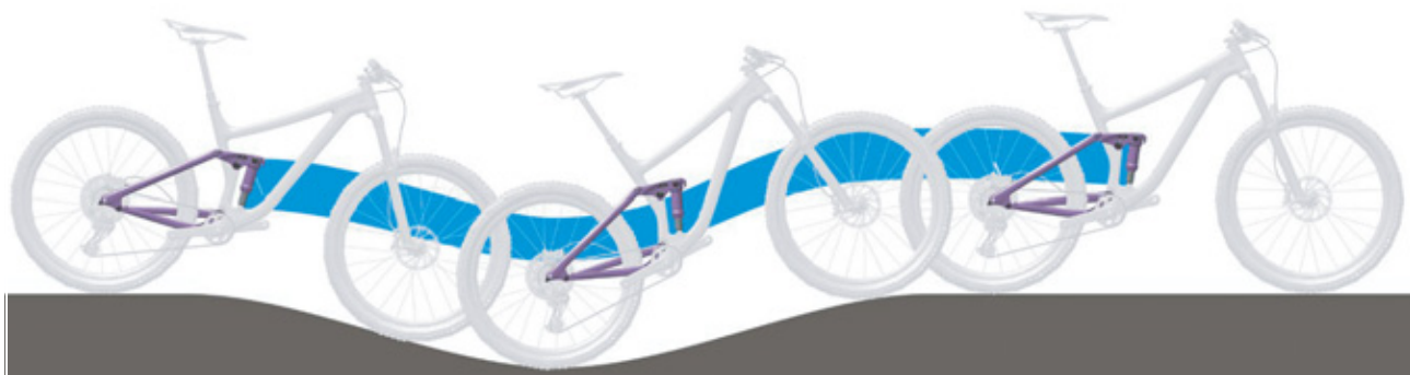
Obr. 26: Optimální chování tlumiče zadního odpružení při jízdě v kopcovitém terénu
