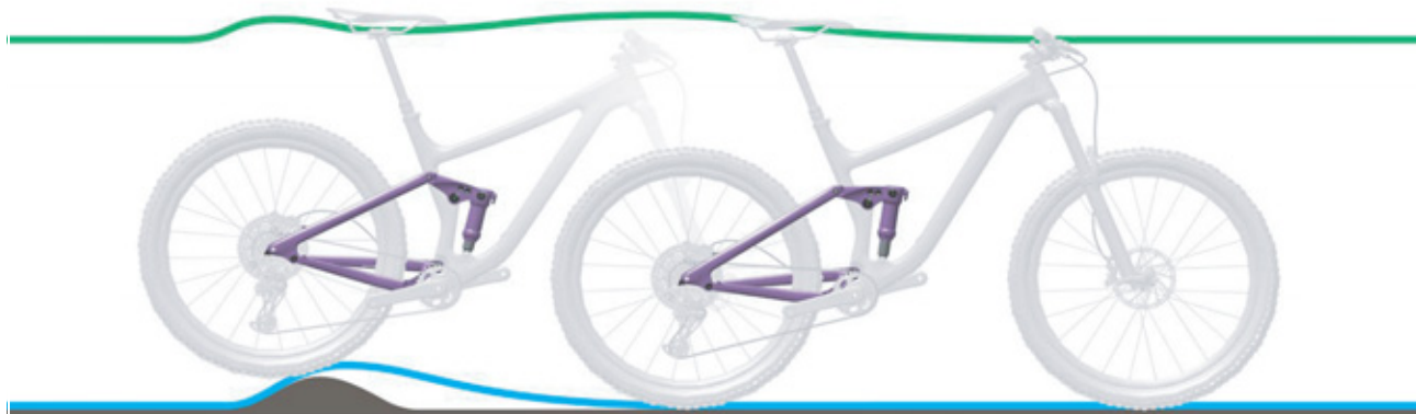
Obr. 260: Příliš tvrdé tlumení tlumiče zadního odpružení u nerovností
