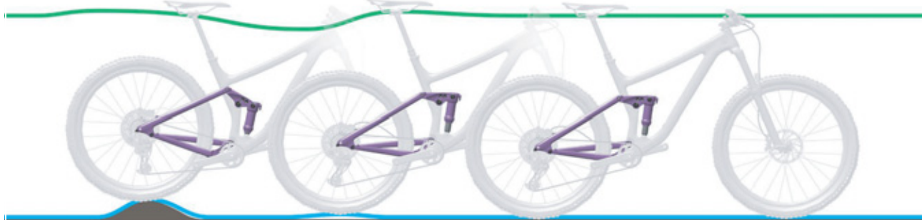
Obr. 262: Příliš rychlé roztahování tlumiče zadního odpružení
