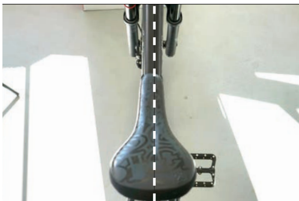
Obr. 115: Vyrovnání sedla ve směru jízdy
