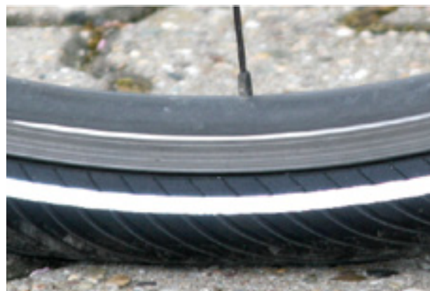
Obr. 132: Správný tlak. Plášť se působením hmotnosti těla téměř nezdeformuje
