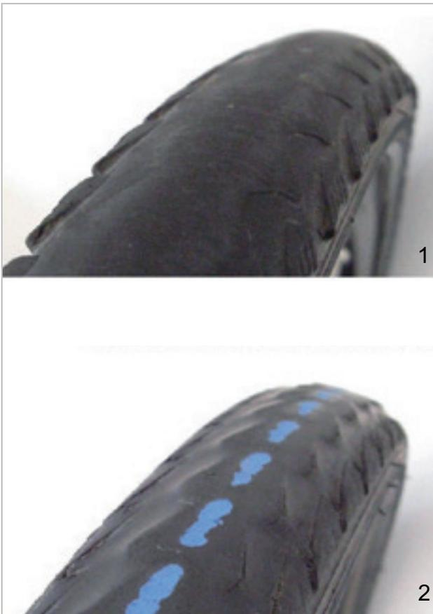
Abbildung 173: Reifen ohne Profil, der gewechselt werden kann (1) und Reifen mit durchscheinendem Pannenschutz (2), der gewechselt werden muss
