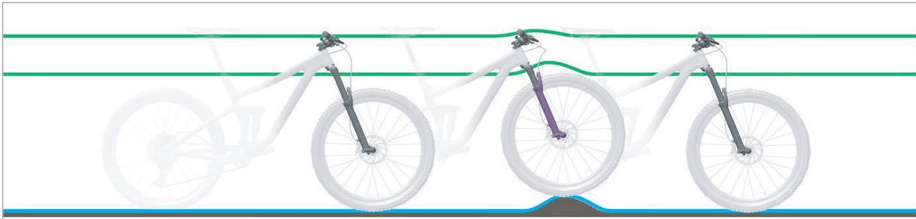
Abbildung 14: Optimales Fahrverhalten der Federgabel bei Unebenheiten
