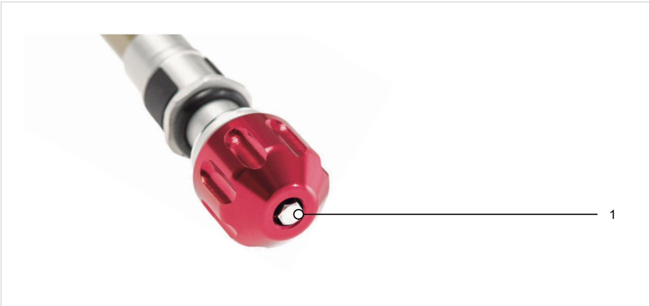
Abbildung 121: Beispiel SR SUNTOUR Zugstufen-Einsteller (Federgabel) (1)
