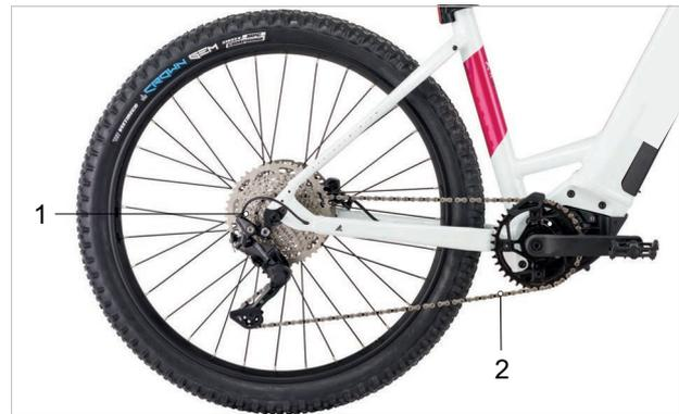
Abbildung 46: Schema Kettenantrieb mit Kettenschaltung
