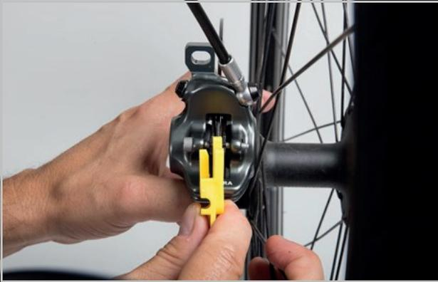
Abbildung 175: Bremsbelag im eingebauten Zustand mithilfe der Transportsicherung prüfen
