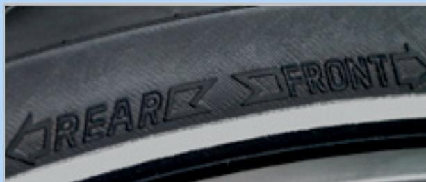
Abbildung 49: Laufrichtungspfeil auf MTB-Reifen
