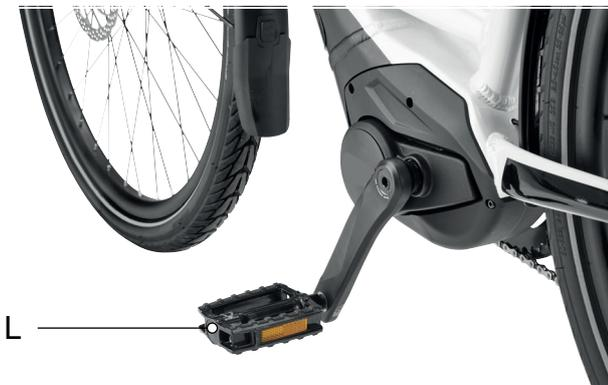
Abbildung 67: L Pedal im linken Kurbelarm
