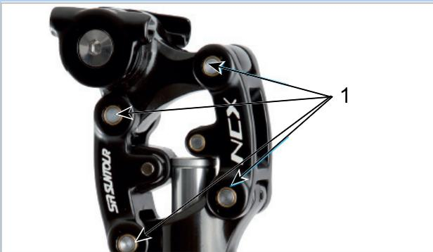
Abbildung 205: Schmierpunkte SR SUNTOUR Feder-Sattelstütze
