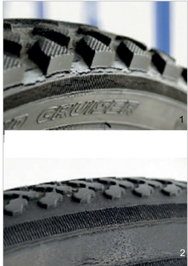
Abbildung 174: Beispiele für Ermüdungsrisse (1) und Alterungsrisse (2)
