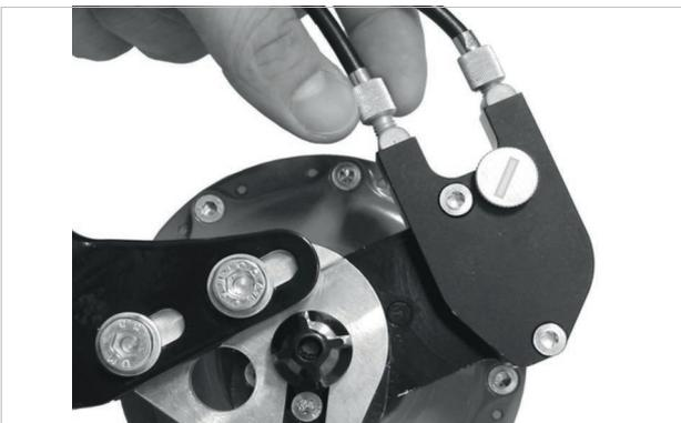
Abbildung 200: ROHLOFF-Naben Versionen mit externer Schaltansteuerung haben die Zugeinsteller an der Seilbox, die sich auf der linken Seite befindet
