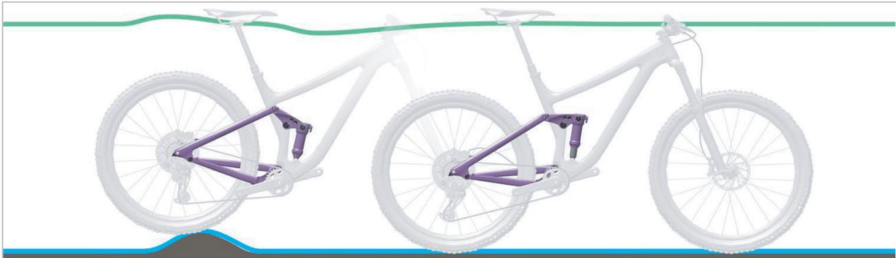
Abbildung 153: Optimales Fahrverhalten des Hinterbau-Dämpfers bei Unebenheiten
