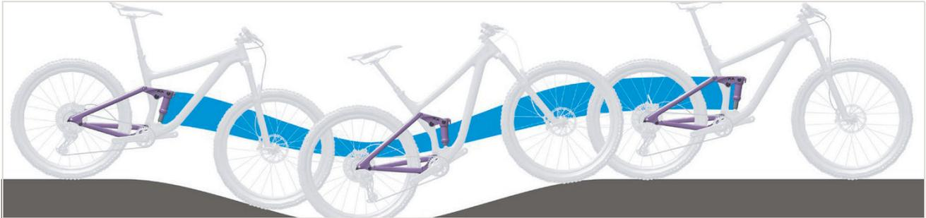
Abbildung 306: Zu weiche Federung des Hinterbau-Dämpfers am Berg
