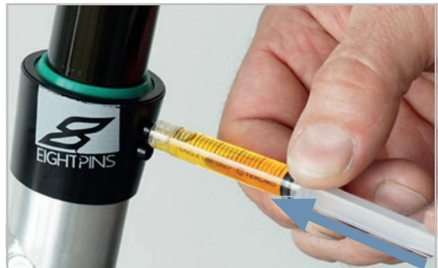
Abbildung 171: EIGHTPINNS Sattelstütze schmieren
