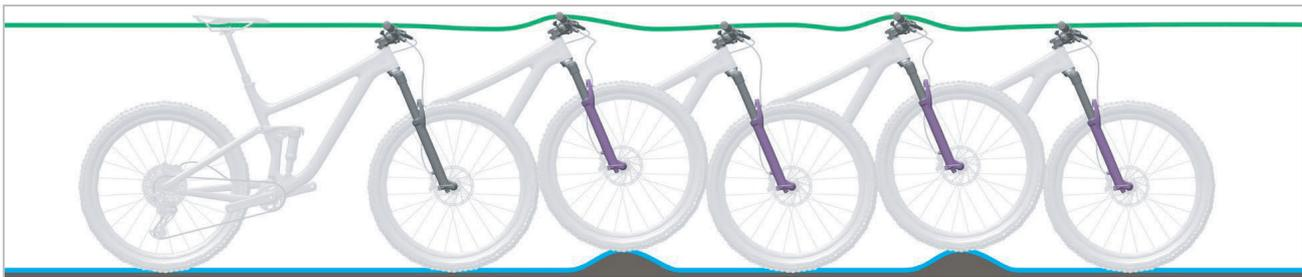
Abbildung 15: Optimales Fahrverhalten der Federgabel
