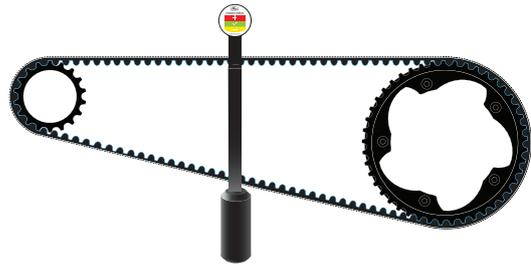
Abbildung 194: Aufgehängter Messstab
