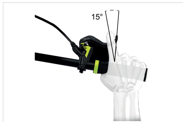
Abbildung 94: Position der Handbremse
