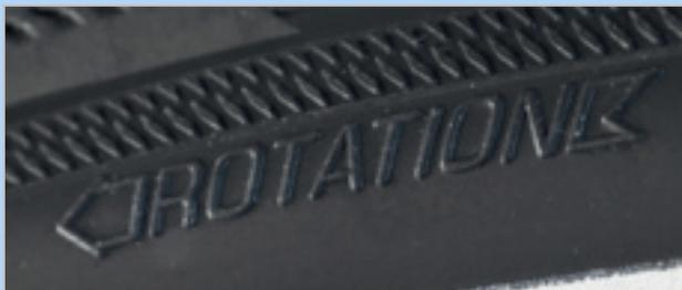
Abbildung 48: Laufrichtungspfeil
