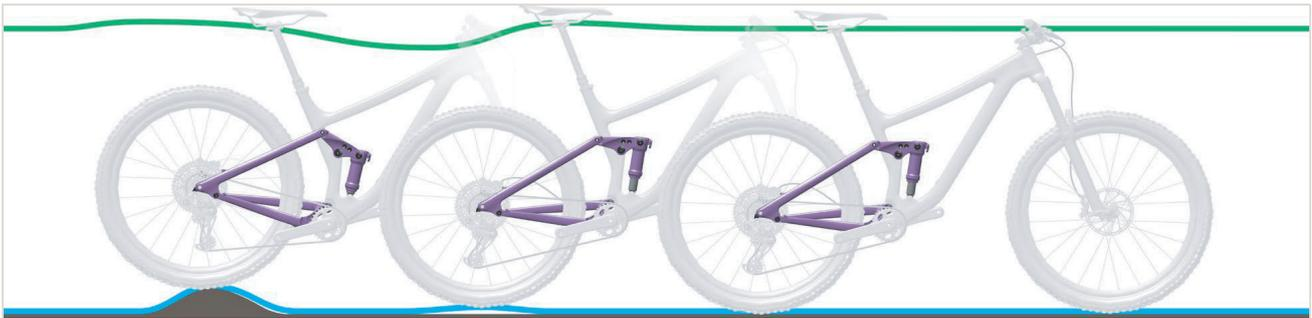
Abbildung 302: Zu schnelles Ausfedern des Hinterbau-Dämpfers
