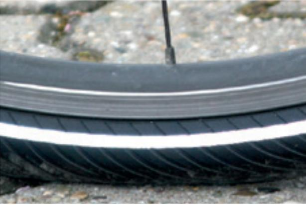
Abbildung 99: Korrekter Fülldruck. Der Reifen ist unter der Last des Körpergewichts kaum verformt
