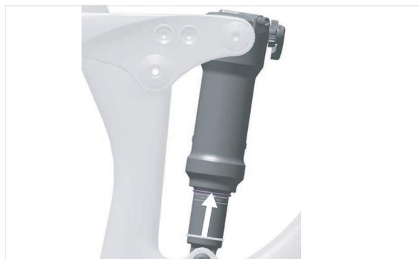
Abbildung 118: O-Ring am Hinterbau-Dämpfer verschieben
