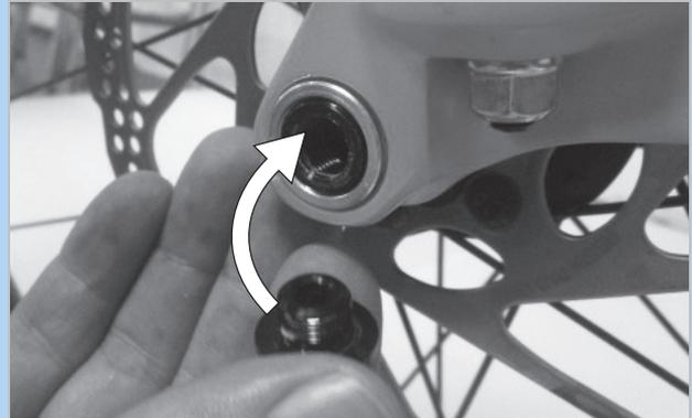
Abbildung 59: Sicherungsschraube einsetzen
