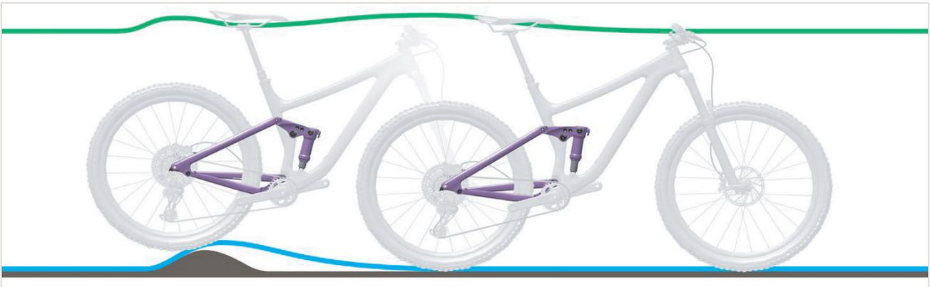
Abbildung 308: Zu harte Dämpfung des Hinterbau-Dämpfers bei Unebenheiten
