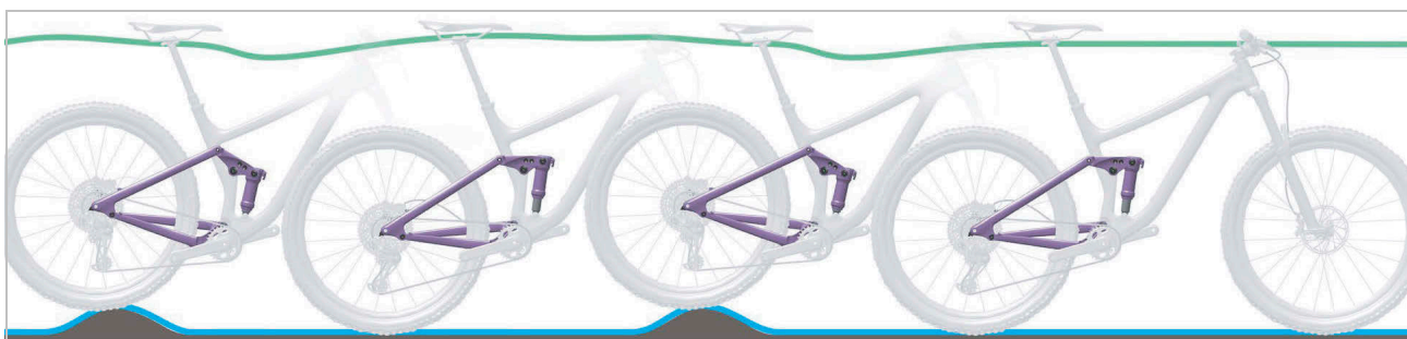
Slika 5: Optimalno ponašanje stražnjeg amortizera pri vožnji
