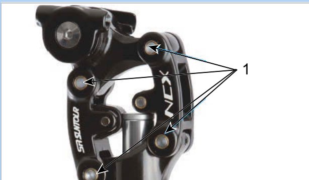
Slika 250: Točke podmazivanja amortizacijske cijevi sjedala SR SUNTOUR
