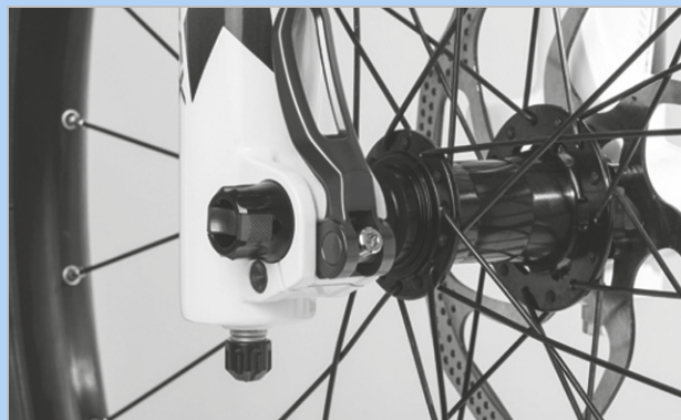
Slika 248: Podešavanje sile stezanja brzog zatvarača
