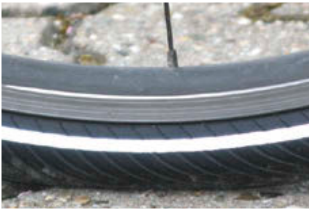
Slika 153: Ispravan tlak u gumi. Guma se jedva deformira pod tjelesnom težinom
