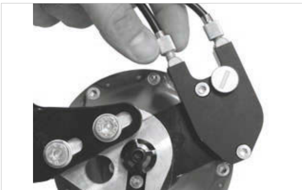
Slika 245: Kod verzija ROHLOFF glavčina s vanjskim upravljanjem brzinama, kotačići za podešavanje zategnutosti nalaze se na kutiji za sajlu koja se nalazi na lijevoj strani
