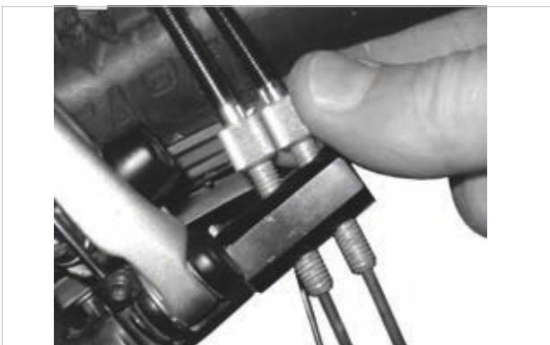
Slika 244: Kod verzija ROHLOFF glavčina s unutarnjim upravljanjem brzinama, kotačići za podešavanje sajle nalaze se na držaču sajle
