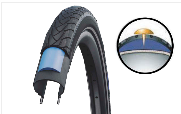
Slika 31: Djelovanje pojasa za zaštitu od bušenja
