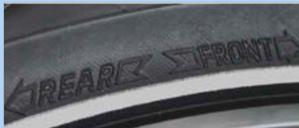
Slika 112: Strelica smjera vožnje na MTB gumama
