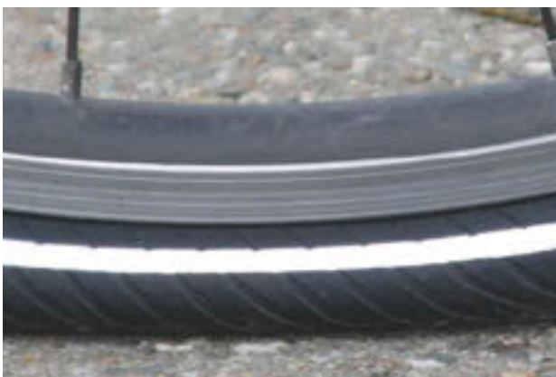
Slika 154: Prenizak tlak u gumi
