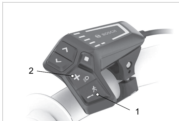
Abbildung 202: Lage Plus-Taster und Minus-Taster
