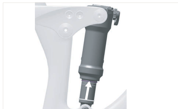
Abbildung 168: O-Ring am Hinterbau-Dämpfer verschieben
