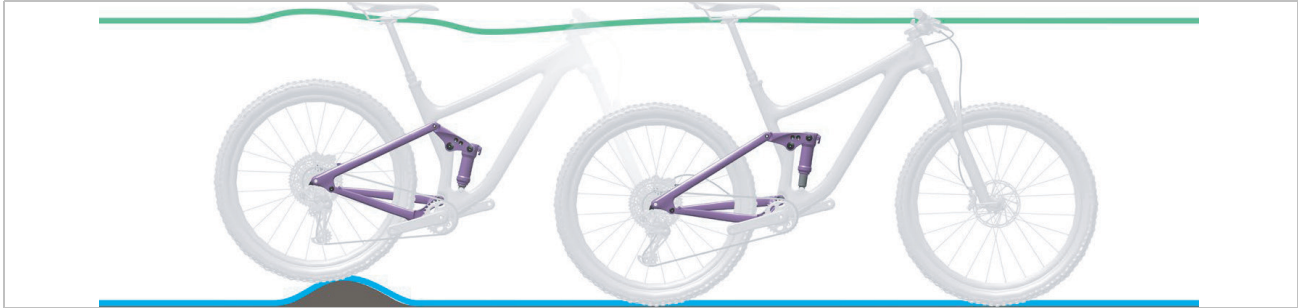
Abbildung 7: Optimales Fahrverhalten des Hinterbau-Dämpfers bei Unebenheiten
