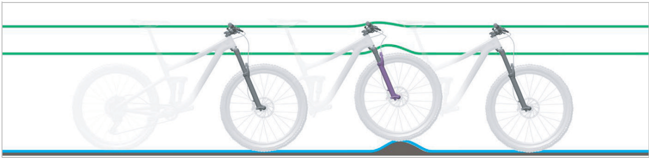
Abbildung 20: Optimales Fahrverhalten der Federgabel bei Unebenheiten
