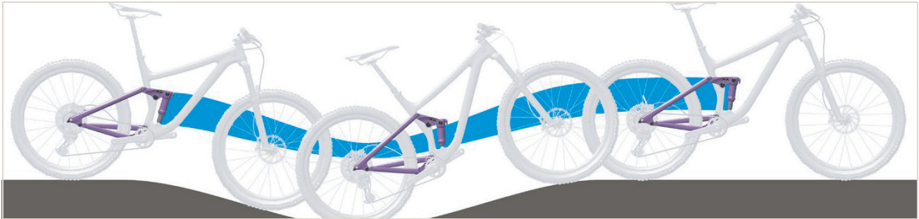
Abbildung 263: Zu weiche Federung des Hinterbau-Dämpfers am Berg
