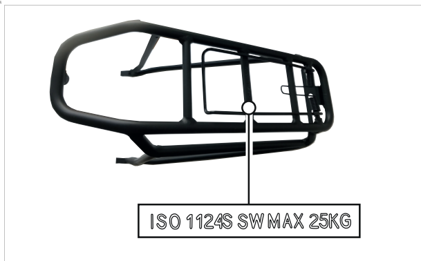
Abbildung 192: Auf dem Gepäckträger ist seine maximale Tragfähigkeit ausgewiesen
