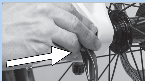
Abbildung 126: Schnellspanner in Pfeilrichtung einschieben
