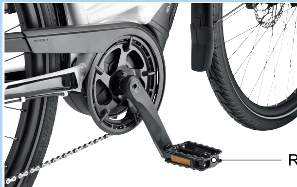
Abbildung 93: R-Pedal im rechten Kurbelarm
