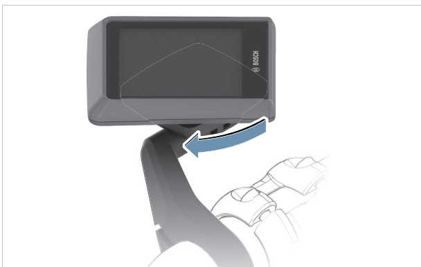
Abbildung 177: Bildschirm im Uhrzeigersinn drehen
