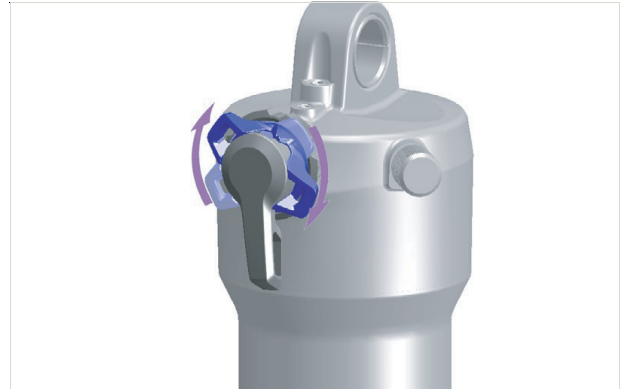
Abbildung 186: Druckstufen-Einsteller härter einstellen
