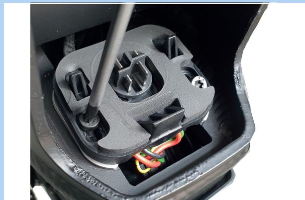
Abbildung 102: Akkuhalter Schrauben lösen
