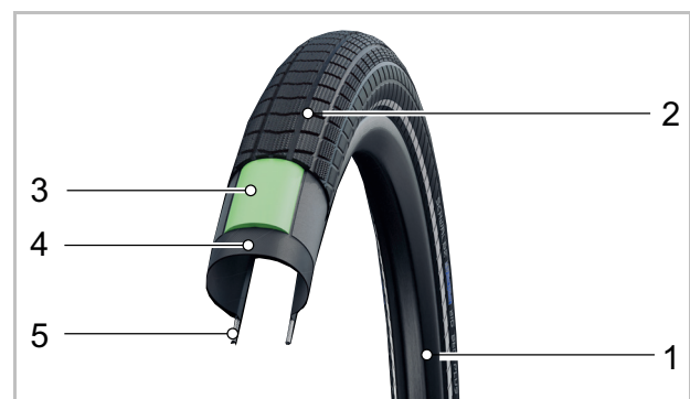
Abbildung 29: Aufbau offener Reifen
