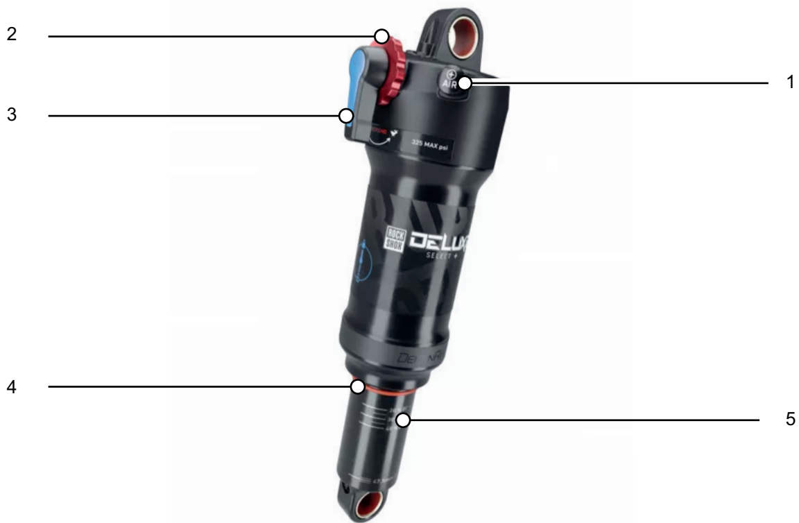
Abbildung 10: Aufbau ROCKSHOX Deluxe Select+ Hinterbau-Dämpfer
