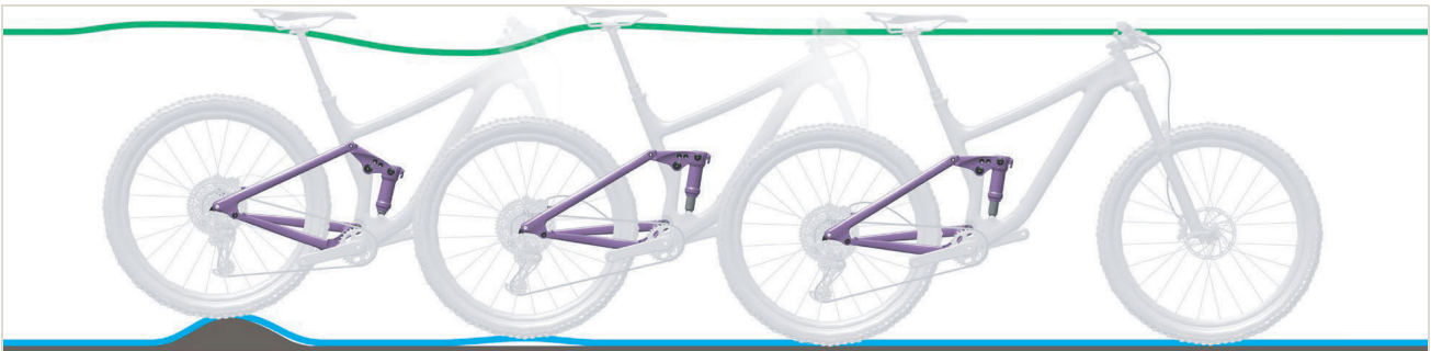
Abbildung 259: Zu schnelles Ausfedern des Hinterbau-Dämpfers
