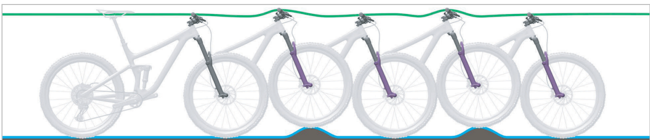
Abbildung 21: Optimales Fahrverhalten der Federgabel
