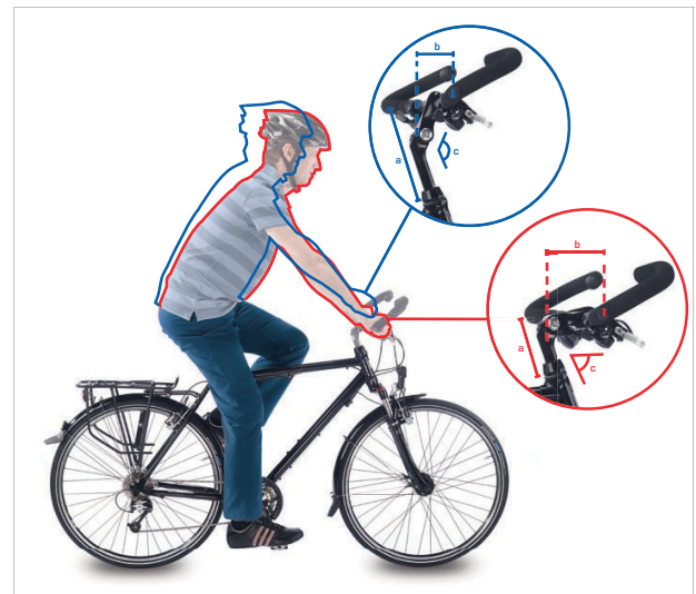
Abbildung 153: Citybike (blau) und Trekkingrad Position (rot) durch Winkeländerung
