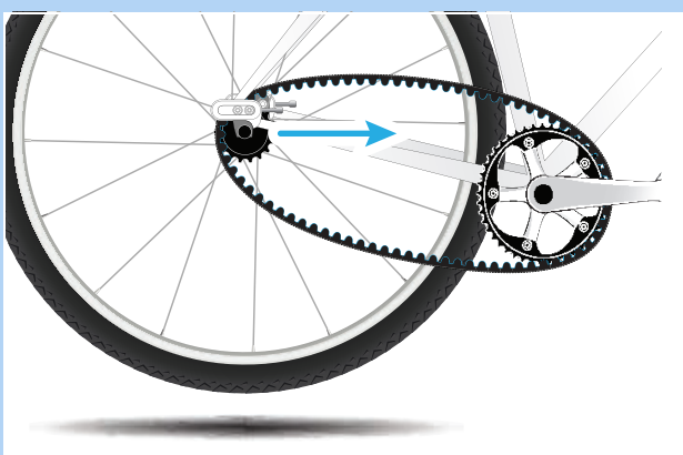
Abbildung 95: Hinterrad nach vorne schieben
