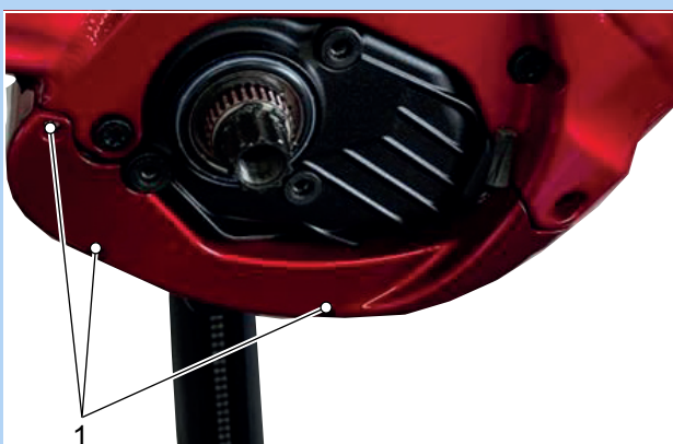
Abbildung 108: Befestigungsschrauben unteres Motorcover (1)
