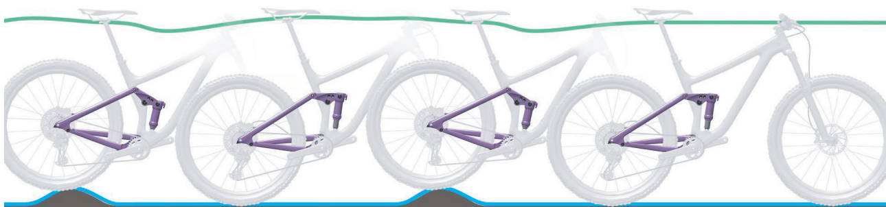
Abbildung 8: Optimales Fahrverhalten des Hinterbau-Dämpfers
