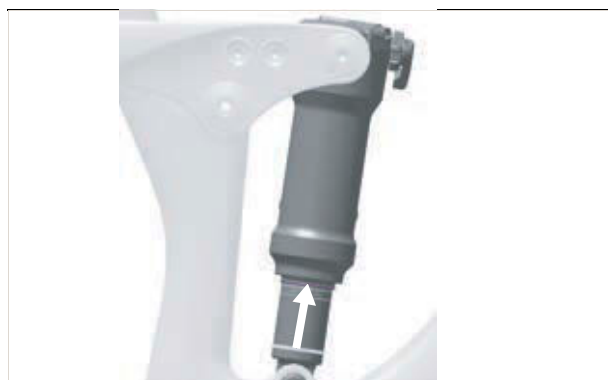
Rysunek 180: Przesuwanie pierścienia o-ring na tylnym amortyzatorze
