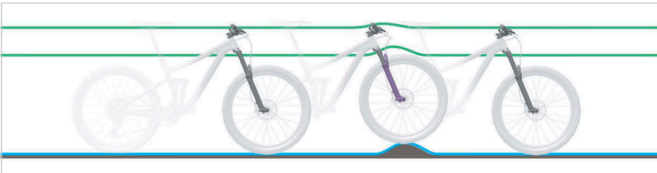
Rysunek 222: Twarde i miękkie ustawienie tłumika dobicia
