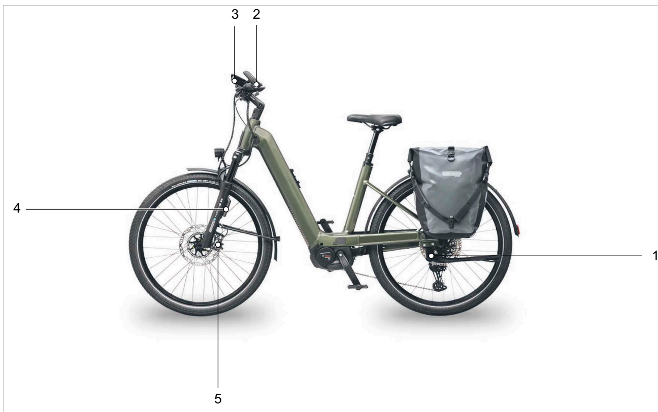
Rysunek 60: Komponenty systemu ABS firmy BOSCH
