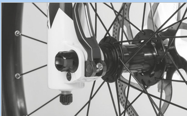
Rysunek 135: Optymalne położenie dźwigni mocującej
