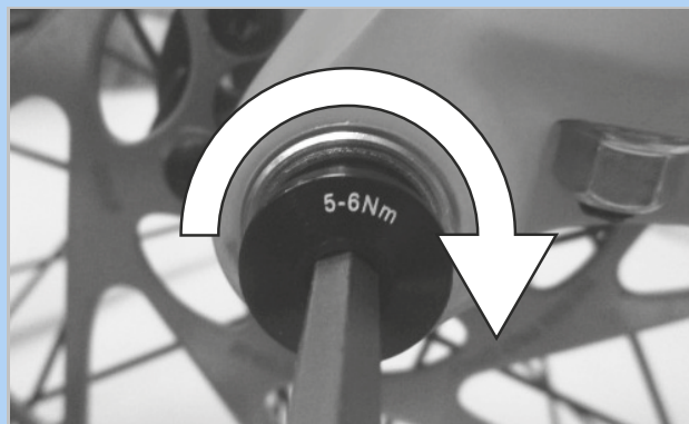
Rysunek 130: Sposób dokręcania śruby zabezpieczającej
