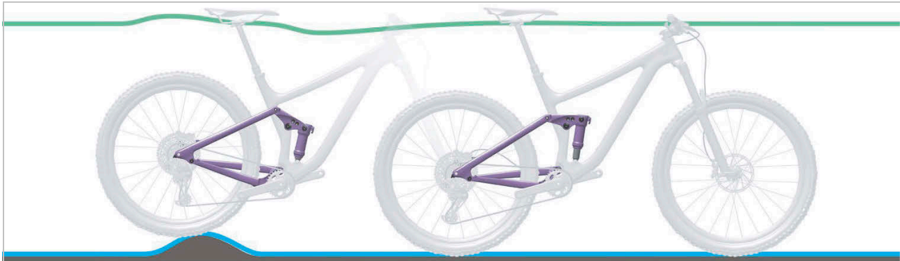
Rysunek 198: Optymalne działanie tylnego amortyzatora na nierównościach
