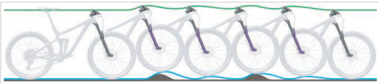
Rysunek 266: Zbyt szybkie rozprężanie widelca amortyzowanego
