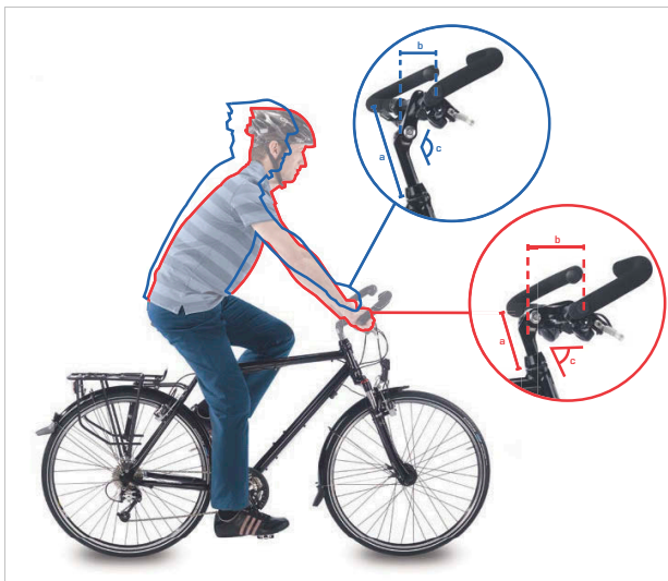
Rysunek 165: Pozycja roweru miejskiego (niebieski) i trekkingowego (czerwony) dzięki regulacji kąta nachylenia
