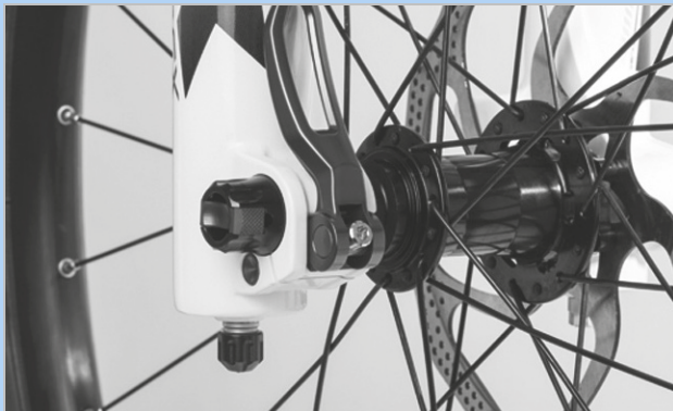
Rysunek 262: Ustawianie siły mocowania zacisku szybko mocującego
