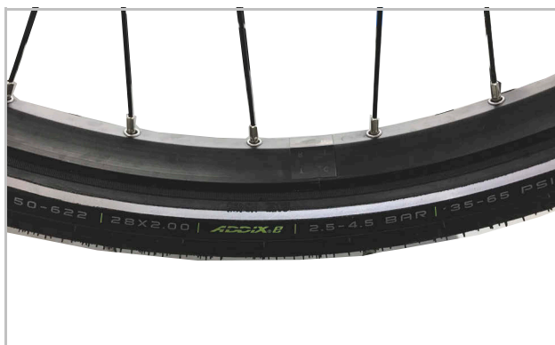
Rysunek 29: Przykład: Informacje podane na oponach
