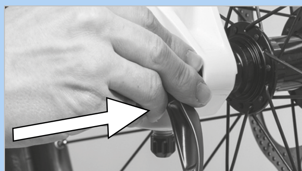
Rysunek 138: Wcisnąć zacisk szybkomocujący zgodnie z kierunkiem strzałki
