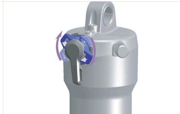
Rysunek 197: Wyregulować nastawnik dobiecia tak, aby amortyzator był bardziej twardy
