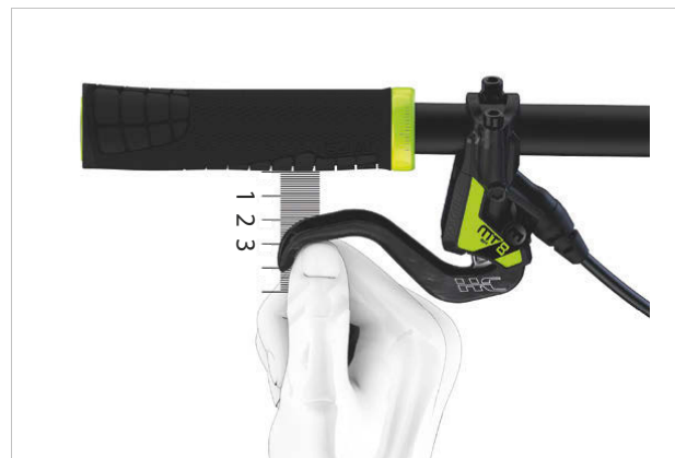
Rysunek 172: Ustawienie hamulca ręcznego
