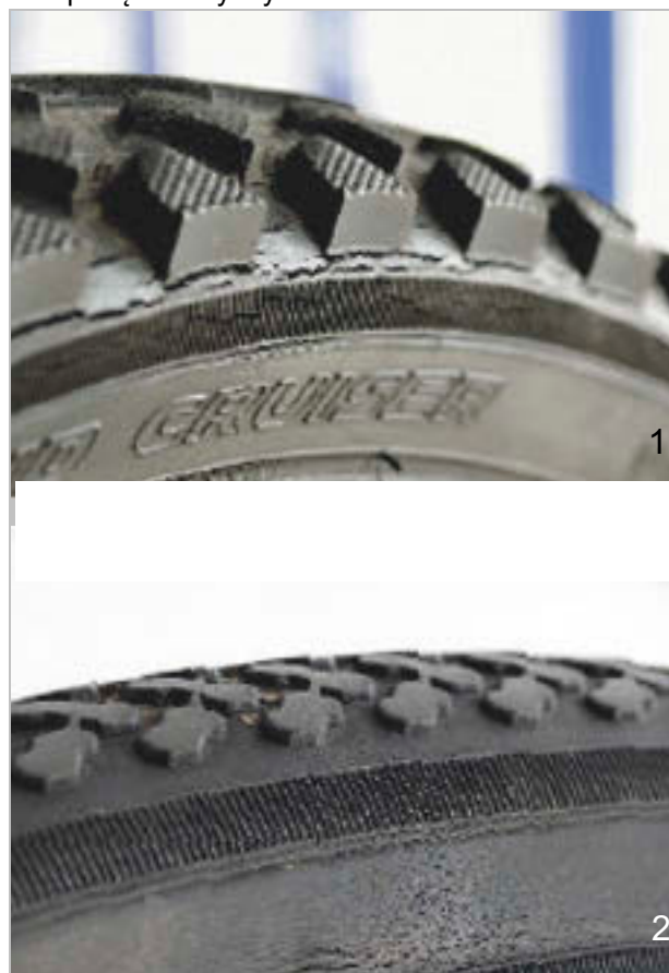
Rysunek 233: Przykłady pęknięć zmęczeniowych (1) i w wyniku starzenia się (2)
