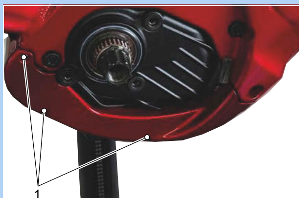
Rysunek 120: Śruby mocujące dolną pokrywę silnika (1)
