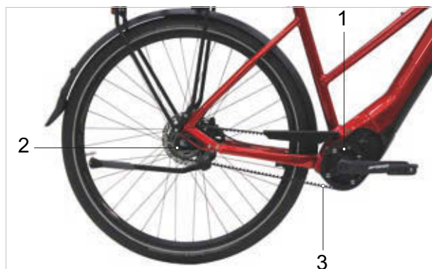
Rysunek 52: Schemat napędu paskowego
