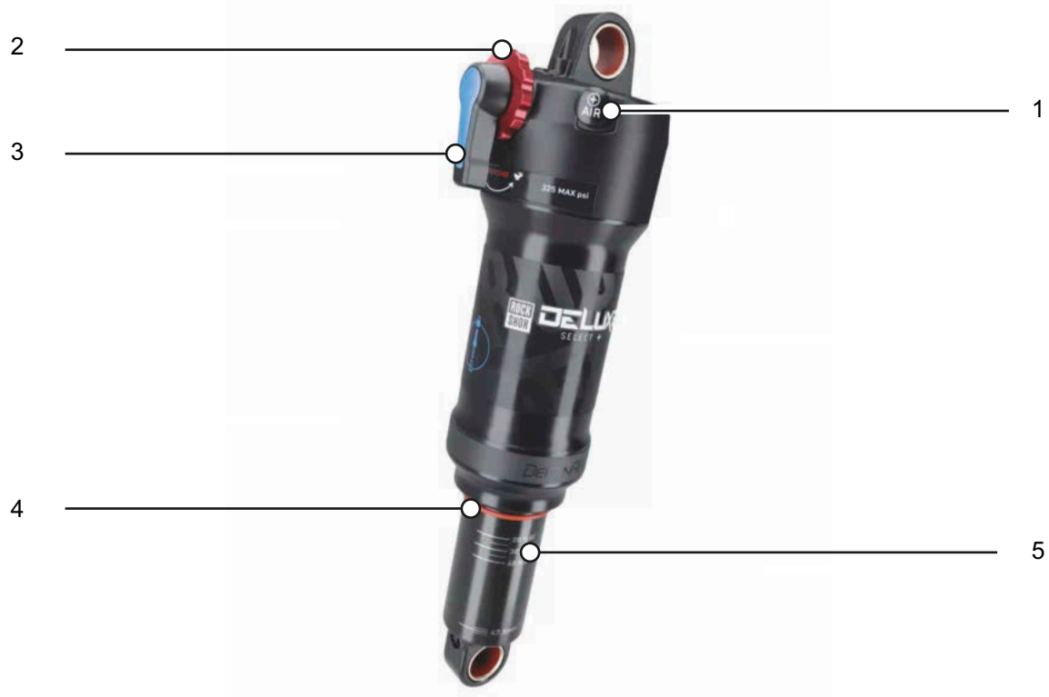
Rysunek 10: Budowa tylnego amortyzatora ROCKSHOX Deluxe Select+
