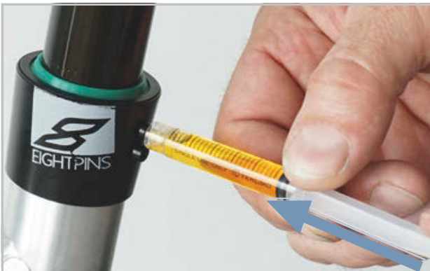
Rysunek 230: Smarowanie sztycy podsiodłowej EIGHTPINS
