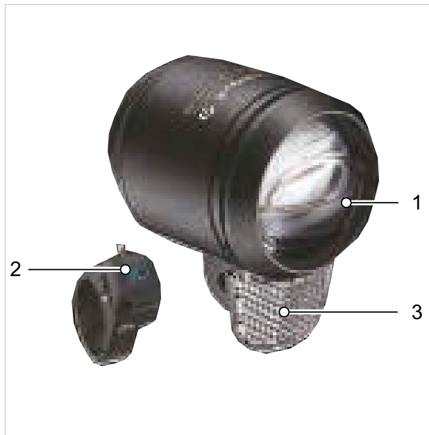
Rysunek 58: LITEMOVE, AE-130 z odblaskiem (1), przełącznik światel drogowych na kierownicy (2) i odblask (3)
