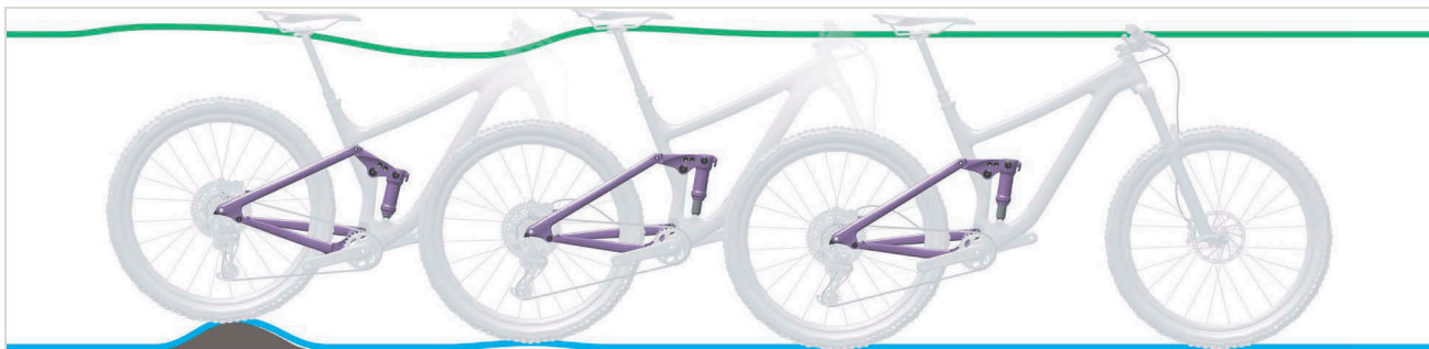
Rysunek 272: Zbyt szybkie rozprężanie się tylnego amortyzatora
