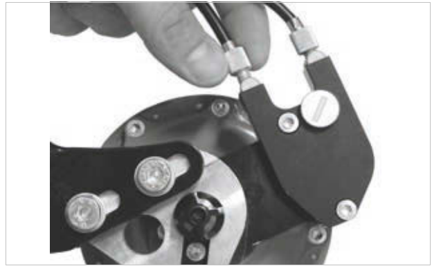
Rysunek 259: Wersje piast ROHLOFF z zewnętrznym sterowaniem mechanizmu zmiany biegów mają regulator linki na puszcze, która znajduje się po lewej stronie
