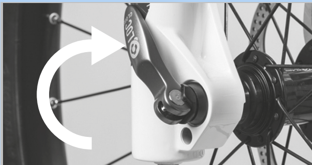
Rysunek 140: Zamykanie zacisku szybkomocującego
