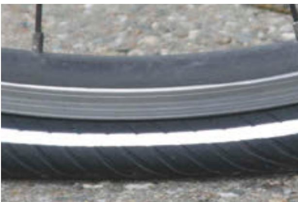
Rysunek 168: Zbyt niskie ciśnienie w oponie
