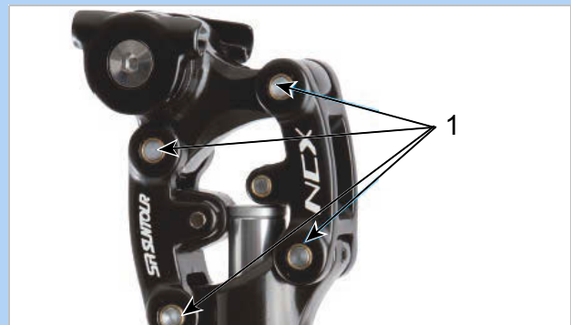
Rysunek 264: Punkty smarowania amortyzowanej sztycy podsiodłowej SR SUNTOUR
