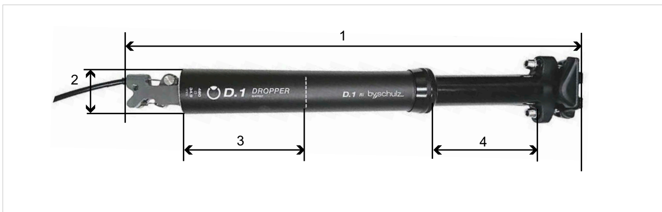
Rysunek 92: Wymiary sztycy podsiodłowej BY,SCHULZ, D.1
