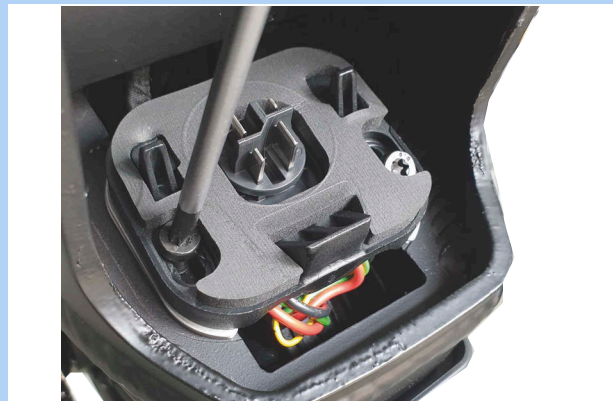
Rysunek 114: Odkręcanie śrub akumulatora
