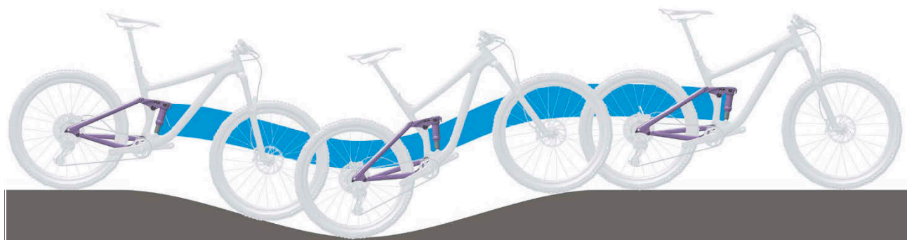
Obr. 9: Optimální chování tlumiče zadního odpružení při jízdě v kopcovitém terénu
