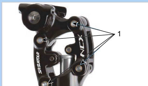
Obr. 250: Mazací body odpružené sedlovky SR SUNTOUR
