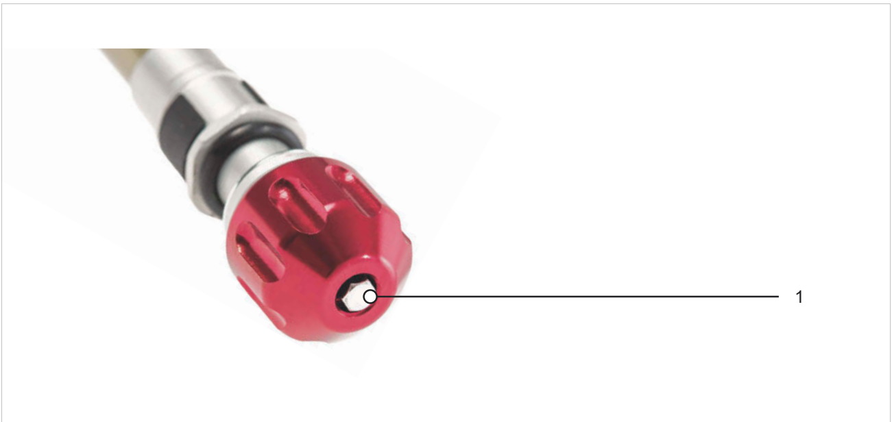
Obr. 253: Příklad nastavovacího šroubu odskoku (vidlice) SR SUNTOUR (1)
