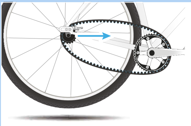
Obr. 93: Posunutí zadního kola dopředu
