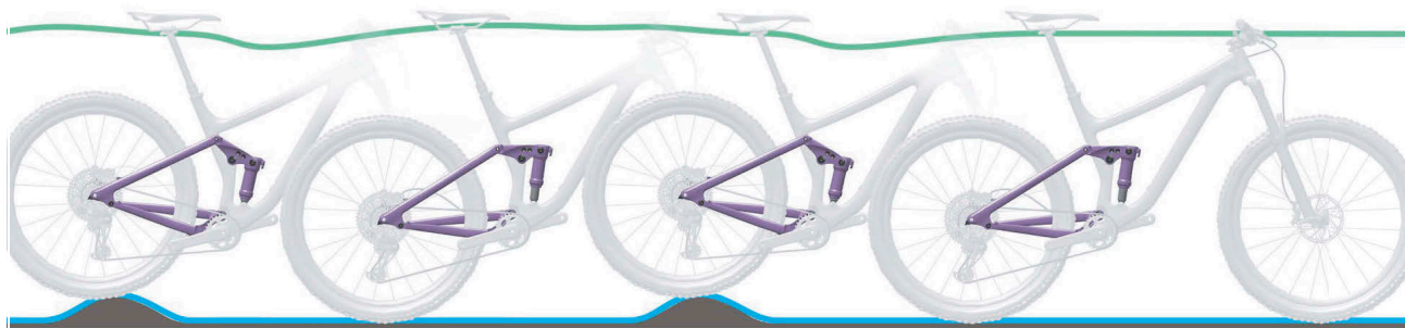
Obr. 8: Optimální chování tlumiče zadního odpružení při jízdě
