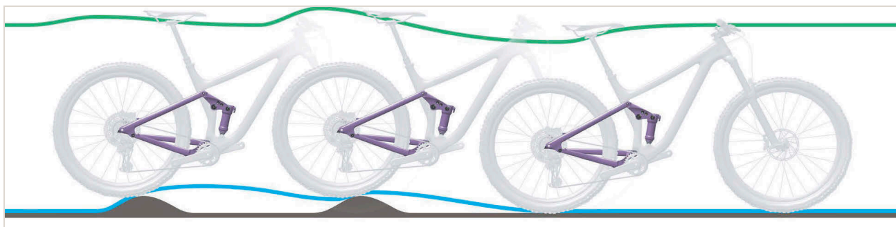
Obr. 260: Příliš pomalé roztahování tlumiče zadního odpružení
