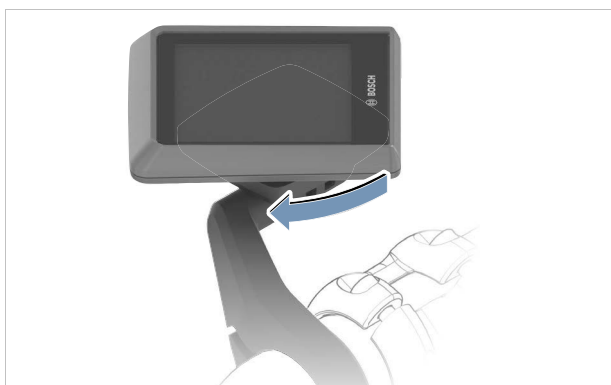
Obr. 175: Otáčení displeje ve směru hodinových ručiček
