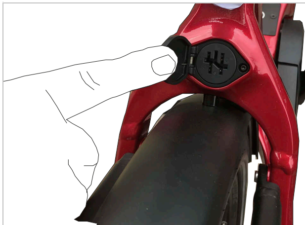
Obr. 180: Elektrická přípojka ZEMO
