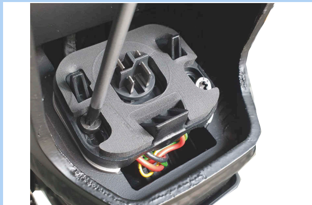
Obr. 100: Povolení šroubů držáku akumulátoru
