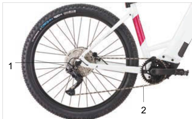
Obr. 50: Schéma řetězového převodu s přesmykačem
