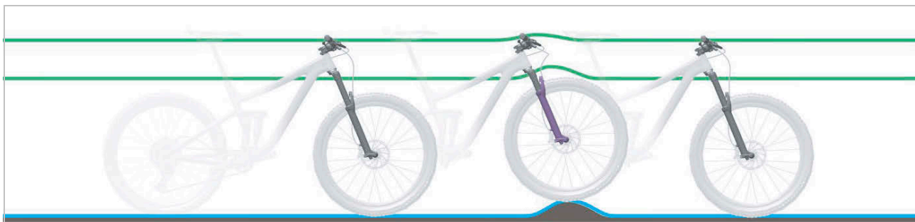
Obr. 20: Optimální chování odpružené vidlice při jízdě u nerovnosti
