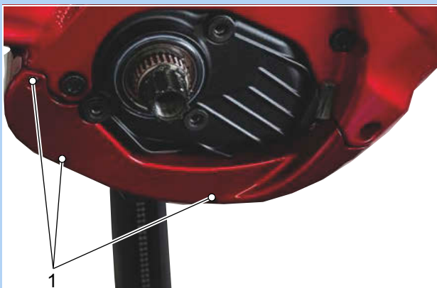
Obr. 106: Upevňovací šrouby dolního krytu motoru (1)
