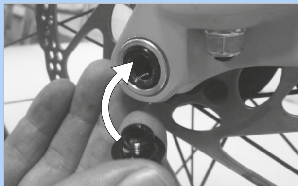
Obr. 115: Nasazení pojistného šroubu
