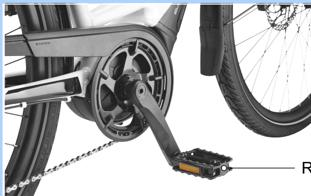
Obr. 91: Pedál R pravého ramena kliky
