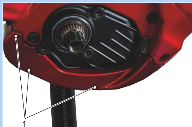
Obr. 96: Upevňovací šrouby dolního krytu motoru (1)
