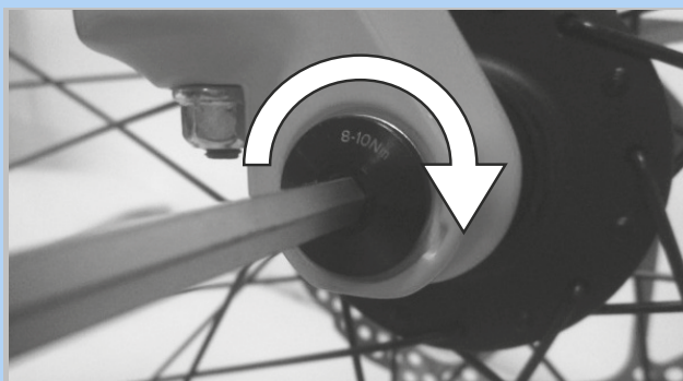
Obr. 114: Utažení osy ve směru šipky
