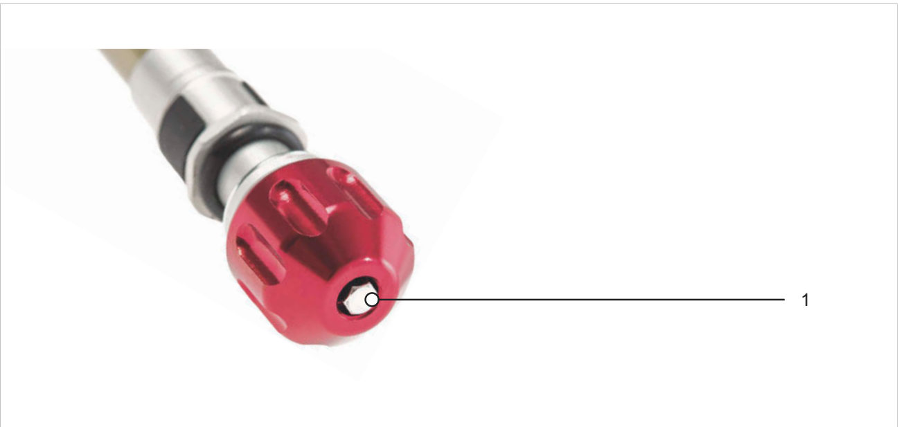
Obr. 255: Příklad nastavovacího šroubu odskoku (vidlice) SR SUNTOUR (1)
