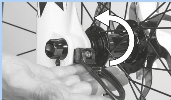
Obr. 120: Stlačte páku rychloupínáku ve směru šipky
