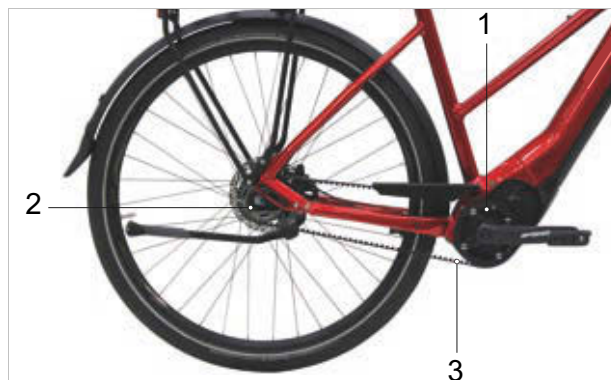
Obr. 51: Schéma řemenového pohonu
