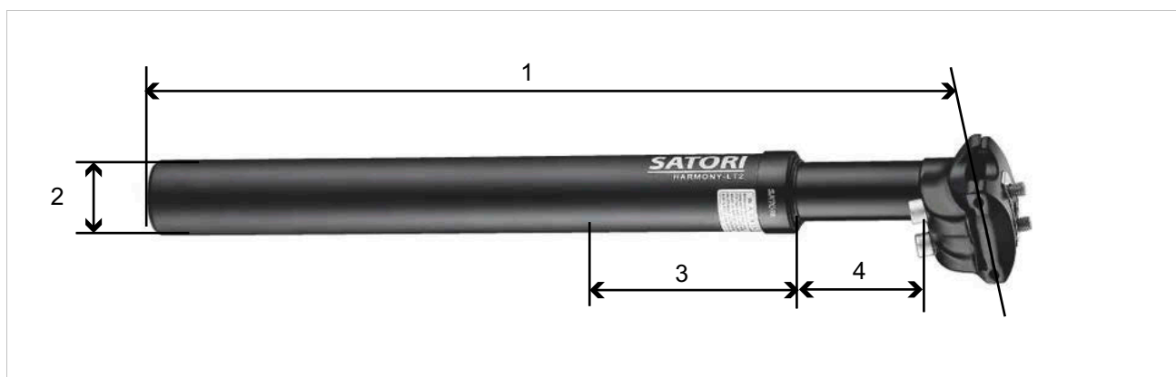
Obr. 79: Rozměry sedlovky Satori, Harmony LT2
