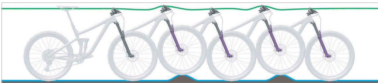
Obr. 18: Optimální chování odpružené vidlice při jízdě
