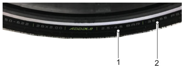
Afbeelding 202: Vuldruk in bar (1) en psi (2)
