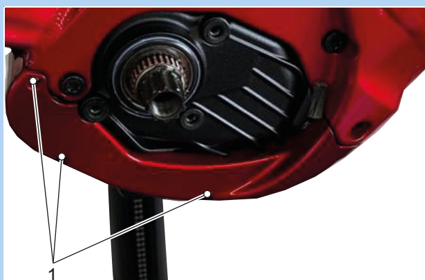
Afbeelding 74: Bevestigingsschroeven onderste motorafdekking (1)
