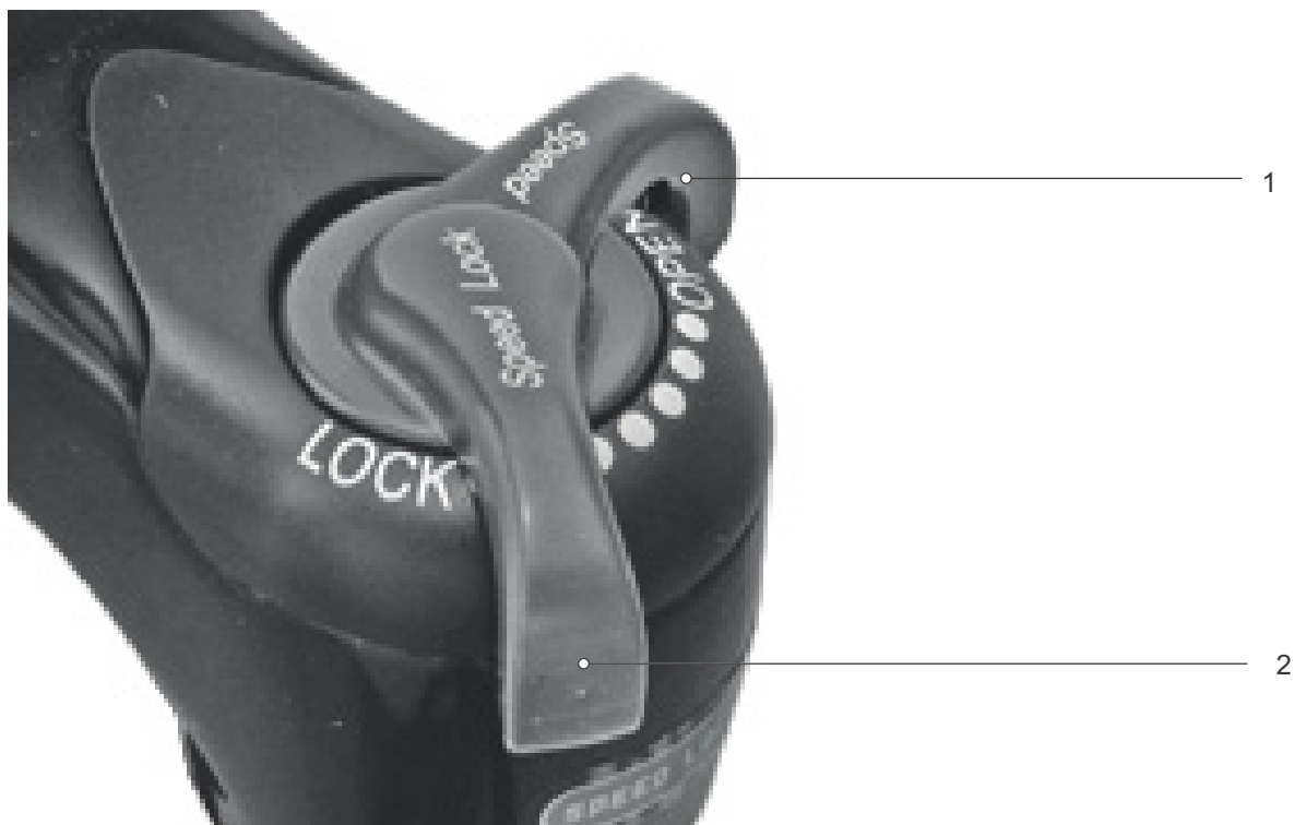
Afbeelding 193: SR SUNTOUR drukdemper in open (1) en gesloten (2) stand
