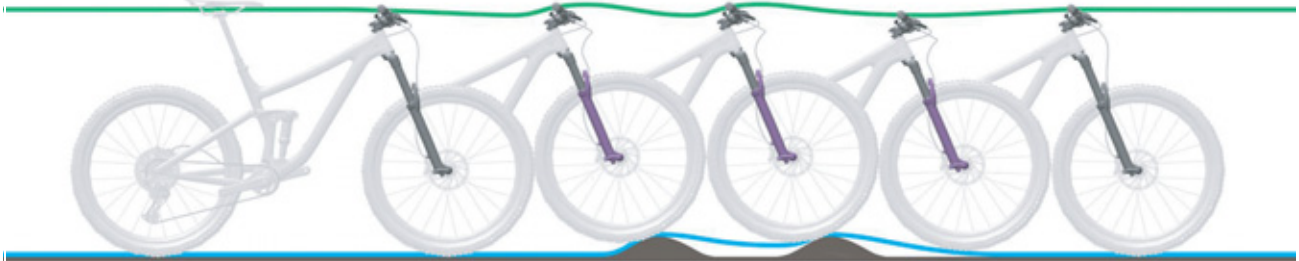
Afbeelding 248: Te langzaam uitveren van de verende voorvork
