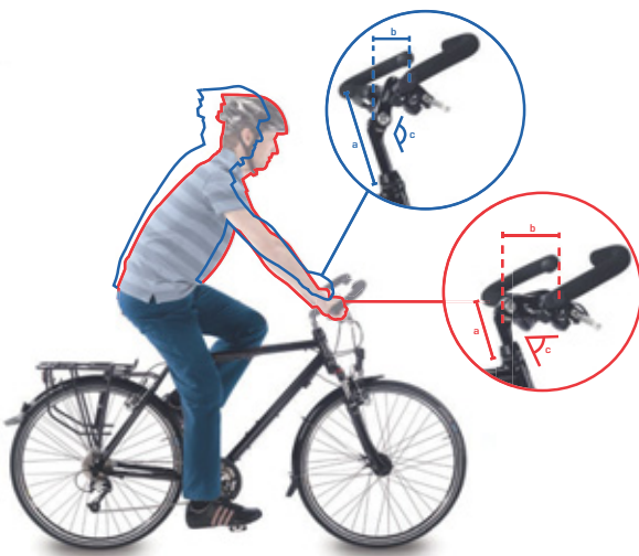
Afbeelding 130: Stadsfiets- (blauw) en toerfietsstand (rood) door verandering van de hoek
