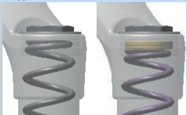
Afbeelding 156: Voorspanningsafstelling in- en uitdraaien
