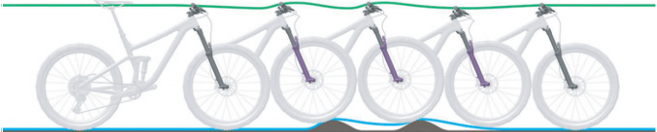
Afbeelding 240: Te langzaam uitveren van de verende voorvork
