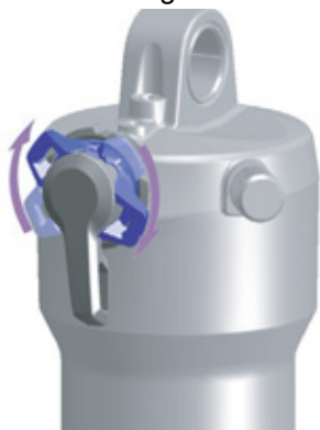
Afbeelding 168: Drukdemperafsteller harder afstellen
