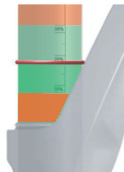
Afbeelding 146: Voorgeschreven sagbereik (groen) en verboden sagbereik (rood)
