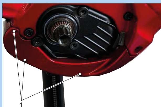
Afbeelding 64: Bevestigingsschroeven onderste motorafdekking (1)
