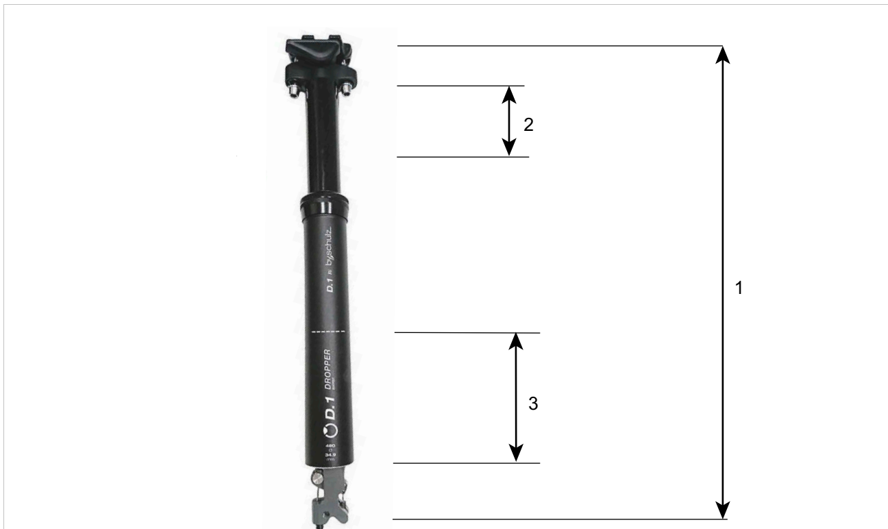
Figura 43: Struttura canotto reggisella by.Schulz G.1
