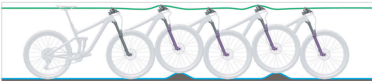
Figura 18: Comportamento di marcia ottimale della forcella ammortizzata
