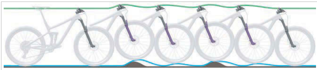
Figura 252: Corsa di estensione troppo veloce della forcella ammortizzata
