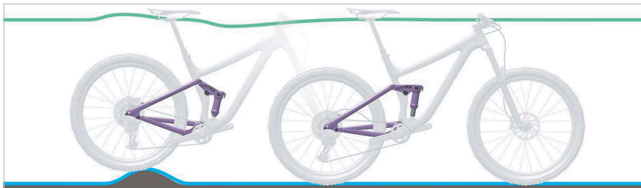
Figura 185: Comportamento di marcia ottimale dell'ammortizzatore del carro posteriore su asperità
