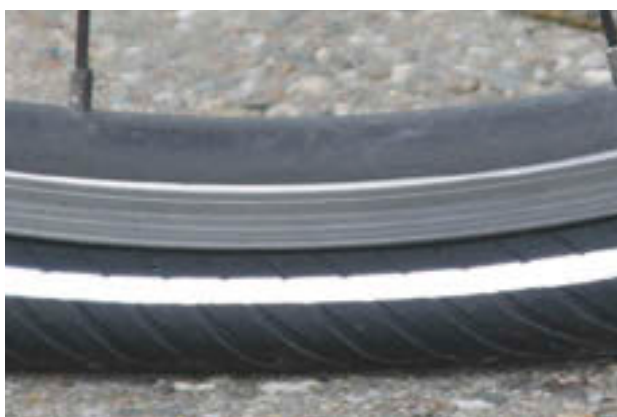
Figura 154: Pressione di gonfiaggio insufficiente
