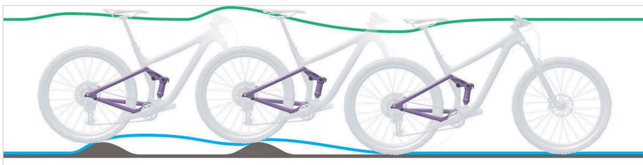
Figura 260: Corsa di estensione troppo lenta dell'ammortizzatore del carro posteriore
