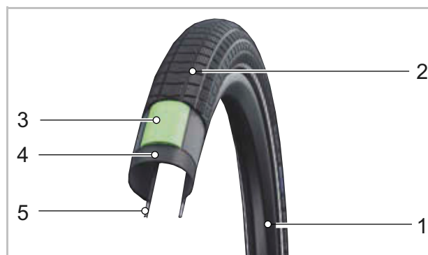
Figura 29: Struttura degli pneumatici aperti
