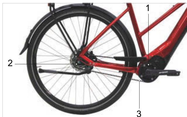
Figura 51: Schema della trasmissione a cinghia
