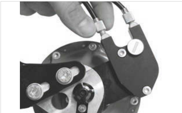
Figura 245: Le versioni del mozzo ROHLOFF con comando esterno del cambio hanno i regolatori della tensione sulla scatola dei cavi situata sul lato sinistro
