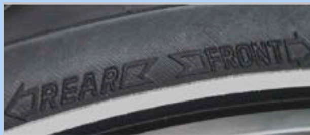
Figura 112: Freccia del senso di rotazione su pneumatici MTB
