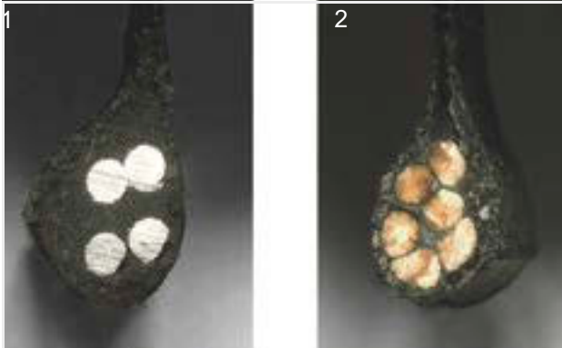
Figura 30: Cerchietto in acciaio (1) e cerchietto in Kevlar (2)
