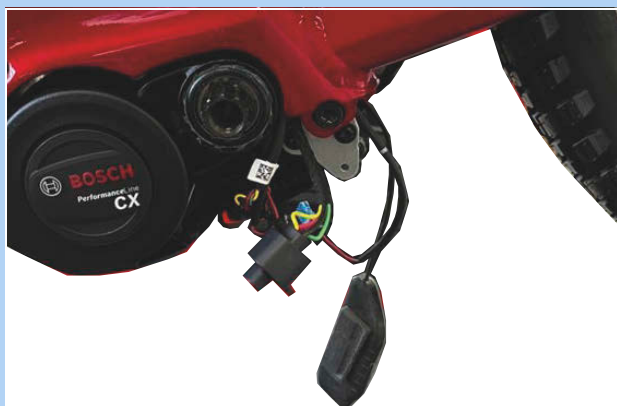
Figura 98: Motore senza copertura
