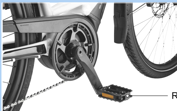
Figura 91: Pedale R nel braccio destro della pedivella
