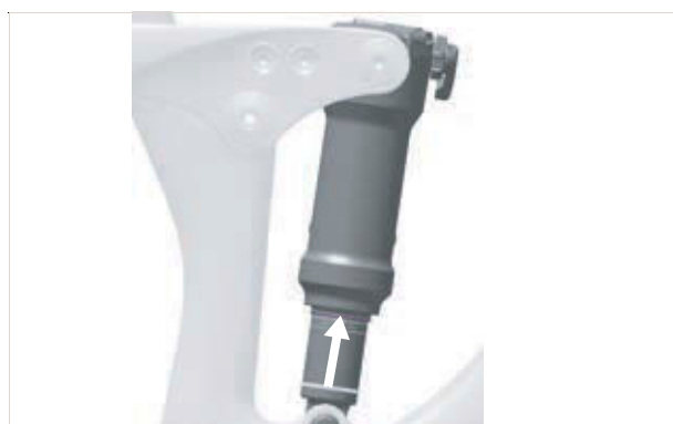
Figura 166: Spostamento dell'O-ring sull'ammortizzatore del carro posteriore
