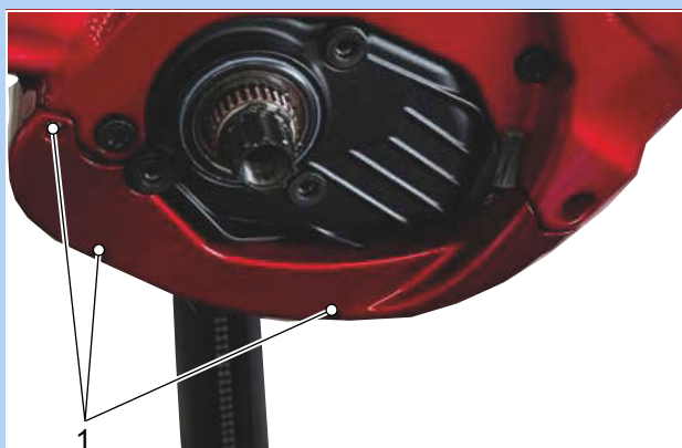
Figura 106: Tornillos de fijación de la cubierta del motor inferior (1)
