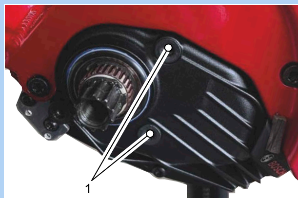
Figura 105: Posición de los tornillos de fijación (1)
