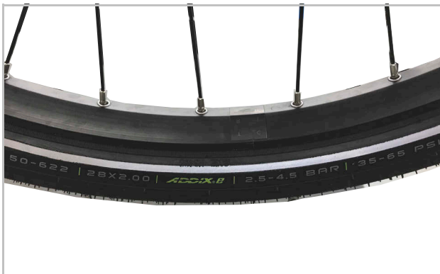
Figura 28: Ejemplo: Información en la cubierta
