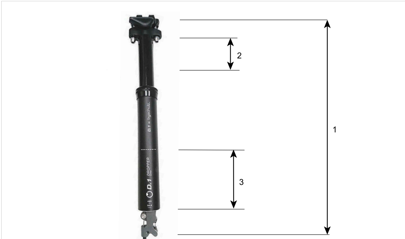
Figura 43: Estructura de la tija de sillín by.Schulz G.1
