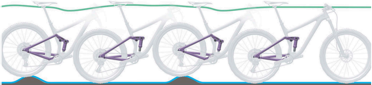
Figura 8: Condición óptima de marcha del amortiguador de la horquilla trasera
