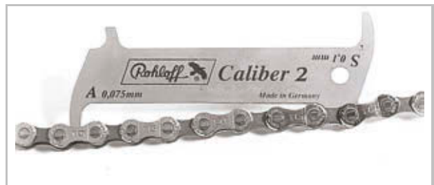
Figura 225: Ejemplo de calibre de medición ROHLOFF
