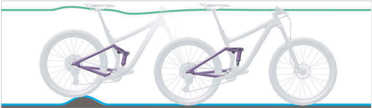
Figura 185: Condición óptima de marcha del amortiguador de la horquilla trasera en caso de irregularidades
