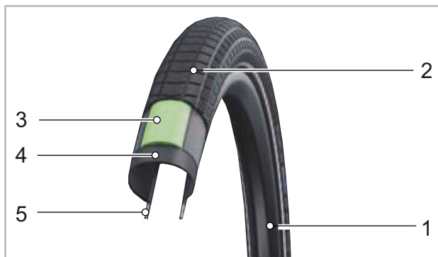
Figura 29: Estructura de las cubiertas abiertas
