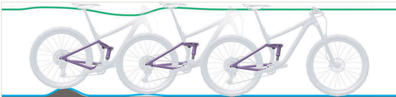
Figura 258: Descompresión demasiado rápida del amortiguador de la horquilla trasera
