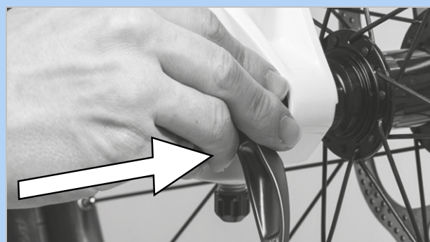
Figura 124: Inserción del cierre rápido en la dirección de la flecha
