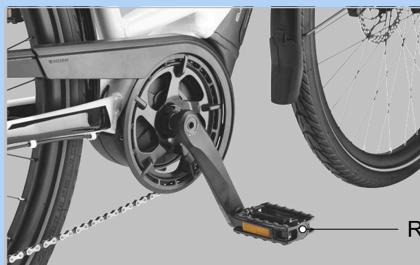
Figura 129: Pedal R en el brazo de manivela derecho
