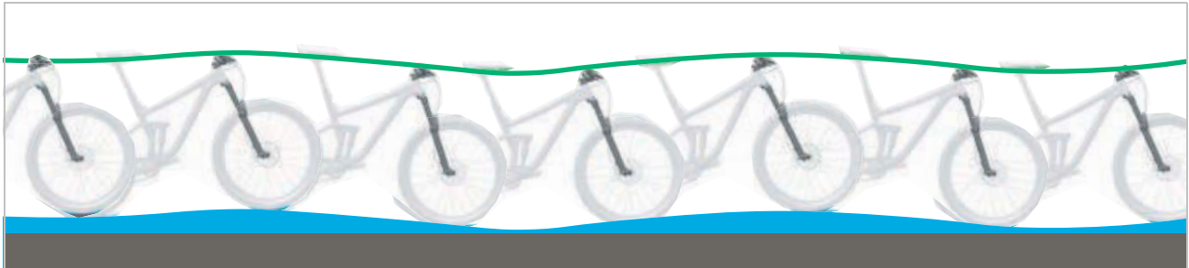
Figura 209: Movimientos de baja velocidad
