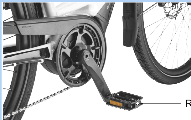
Figura 91: Pedal R en el brazo de manivela derecho
