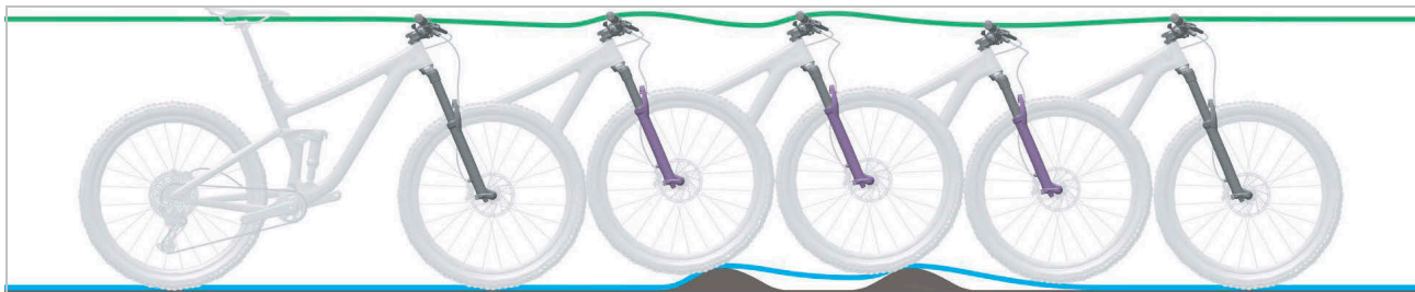
Figura 254: Descompresión demasiado lenta de la horquilla de suspensión
