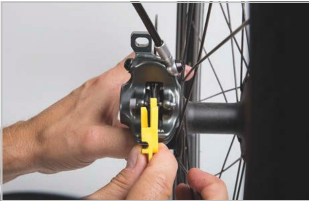
Figura 220: Comprobación de la almohadilla de freno montada con ayuda del seguro de transporte
