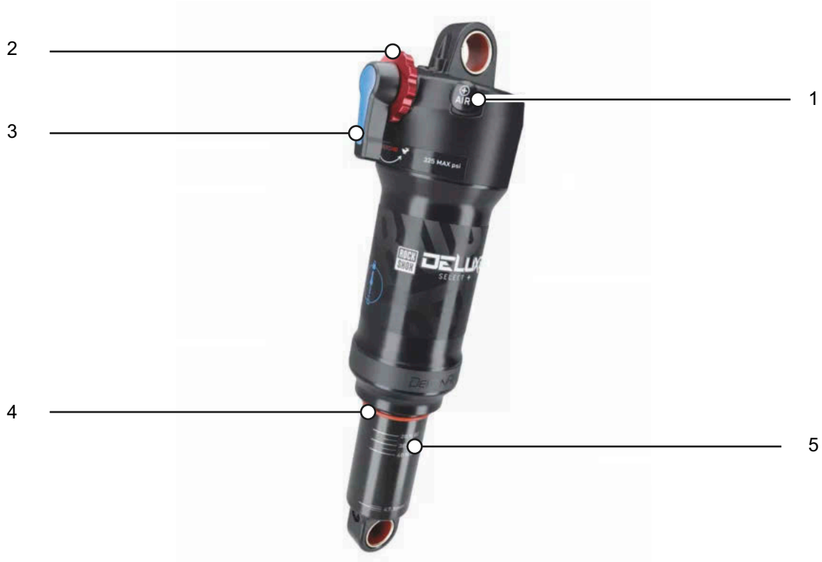
Figura 74: Estructura del amortiguador de la horquilla trasera ROCKSHOX Deluxe Select+
