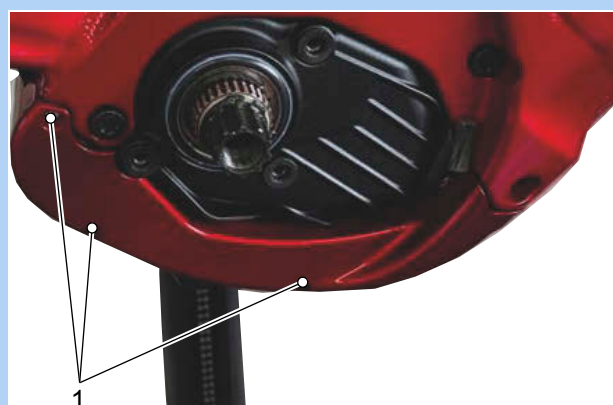
Figura 96: Tornillos de fijación de la cubierta del motor inferior (1)
