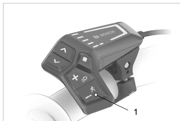
Figura 199: Posición del botón de ayuda para el desplazamiento (1)
