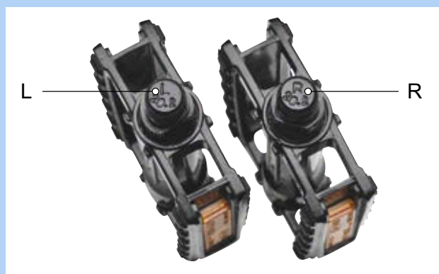
Figura 90: Ejemplo de marca de los pedales
