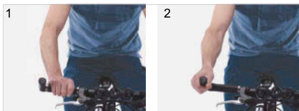
Figura 194: Posiciones de agarre en el acople de manillar
