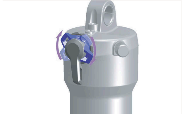
Figura 184: Ajustar el regulador de niveles de presión más duro
