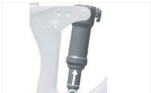
Figura 166: Desplazamiento de la junta tórica en el amortiguador de la horquilla trasera
