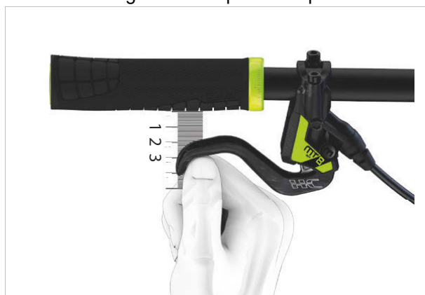
Figura 158: Posicionamiento del freno de mano
