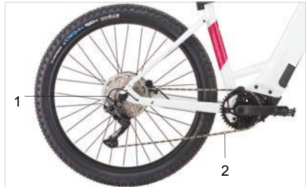
Figura 50: Esquema de la transmisión por cadena con cambio de cadena
