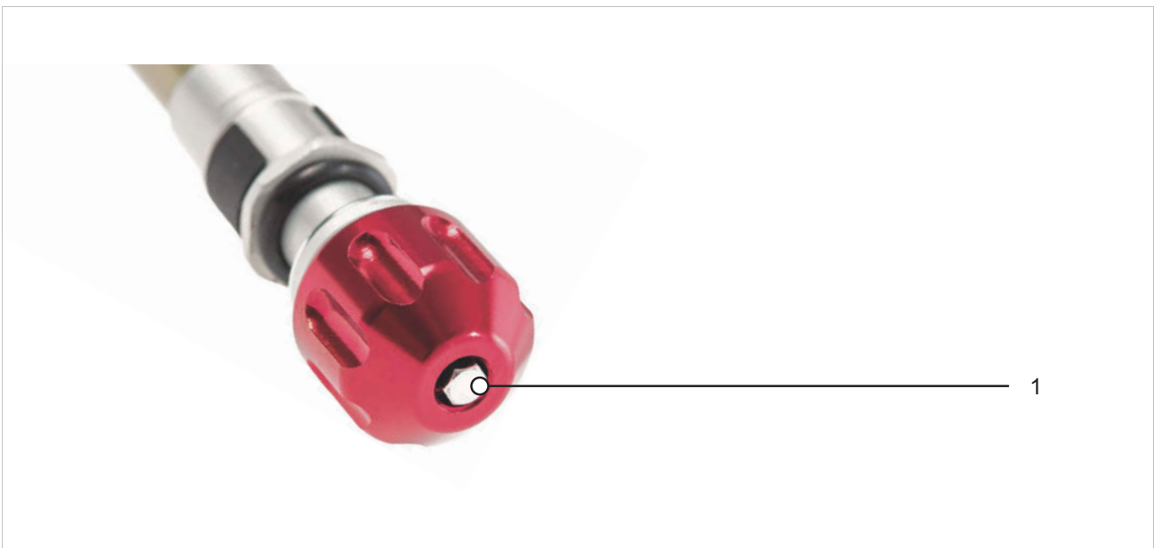
Figura 253: Ejemplo de regulador de niveles de tracción (horquilla) SR SUNTOUR (1)
