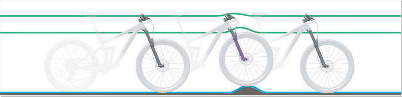
Figura 20: Condición óptima de marcha de la horquilla de suspensión en caso de irregularidades
