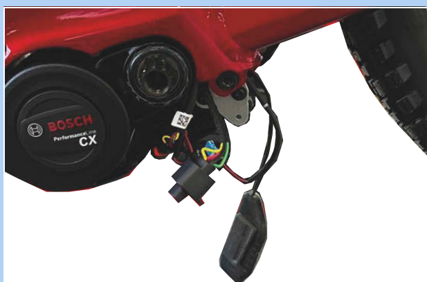
Figura 98: Motor sin cubierta
