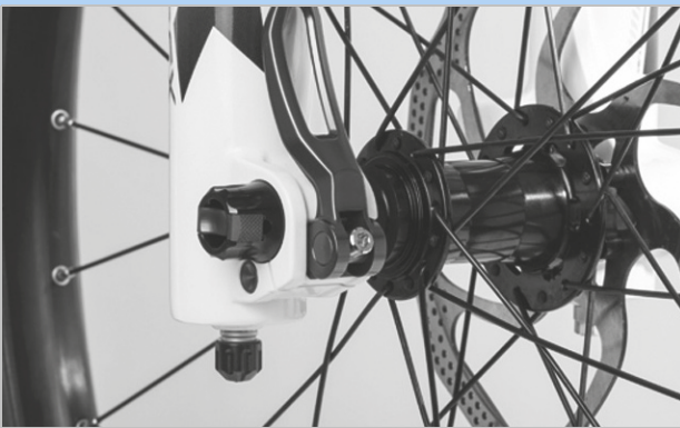
Figura 121: Posición perfecta de la palanca tensora
