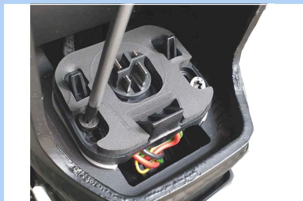
Figura 100: Aflojamiento de los tornillos del soporte de la batería
