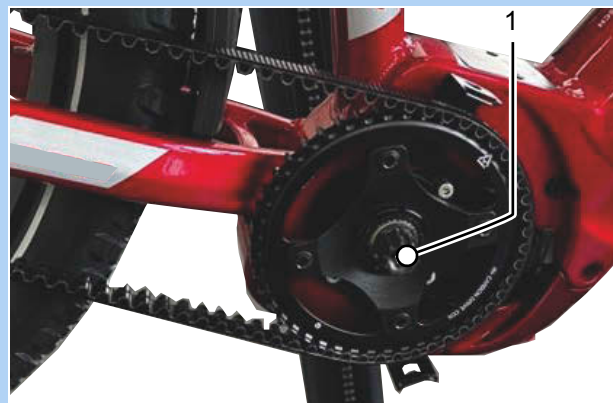
Afbeelding 107: Voorbeeld riemschijf bevestigen
