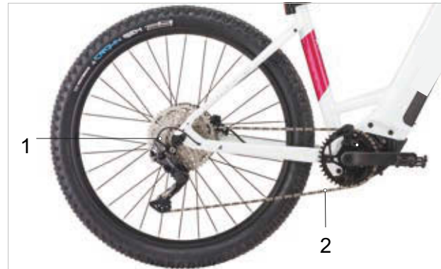
Afbeelding 50: Schema kettingaandrijving met derailleur
