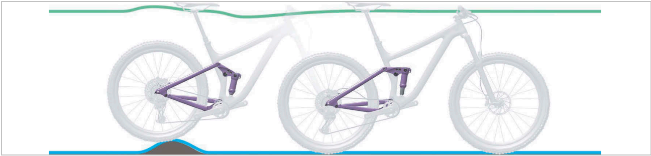
Afbeelding 7: Optimaal rijgedrag van de achterbouwdeemper bij oneffenheden
