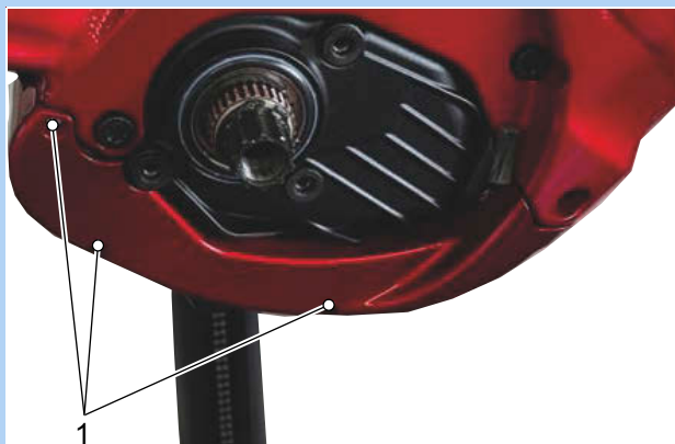
Afbeelding 106: Bevestigingsschroeven onderste motorafdekking (1)
