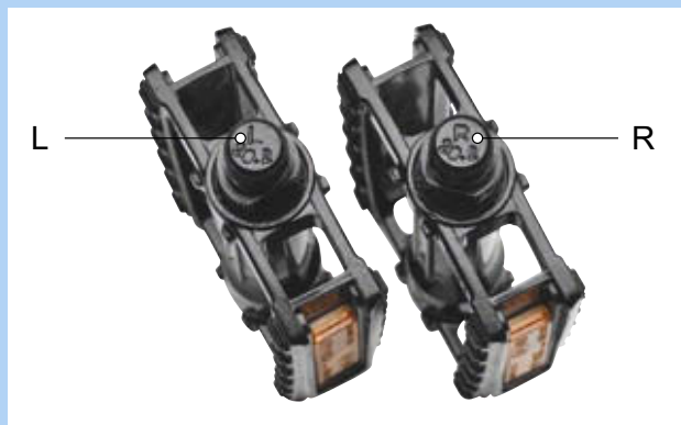
Afbeelding 90: Voorbeeld markering op pedalen
