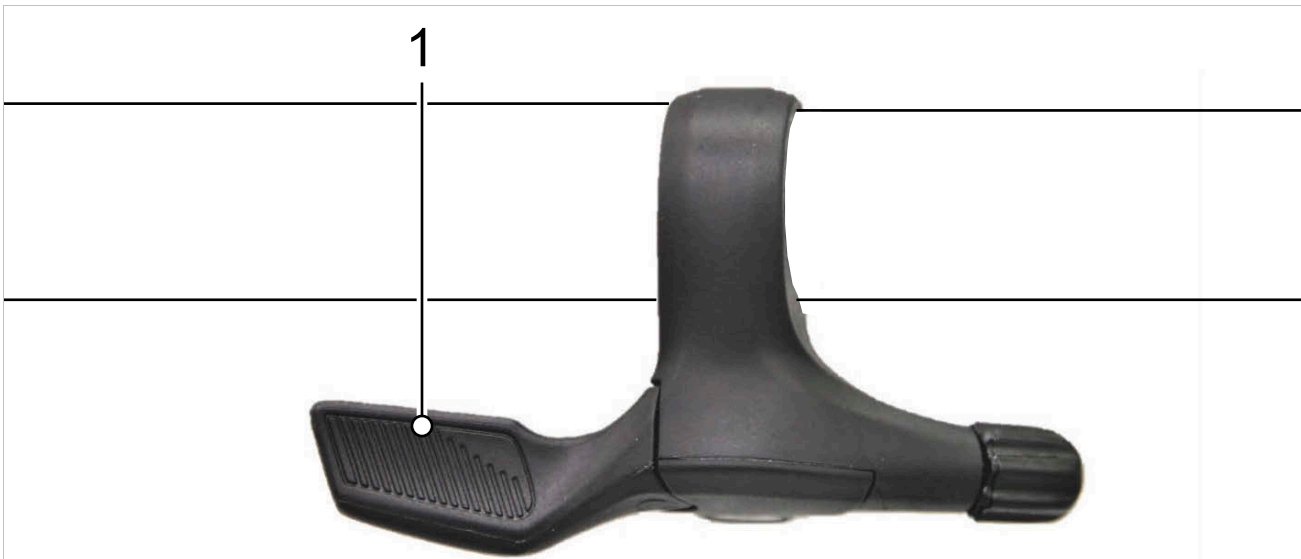
Afbeelding 65: Bedienhendel zadelpen, voorbeeld bedienhendel LIMOTEC
