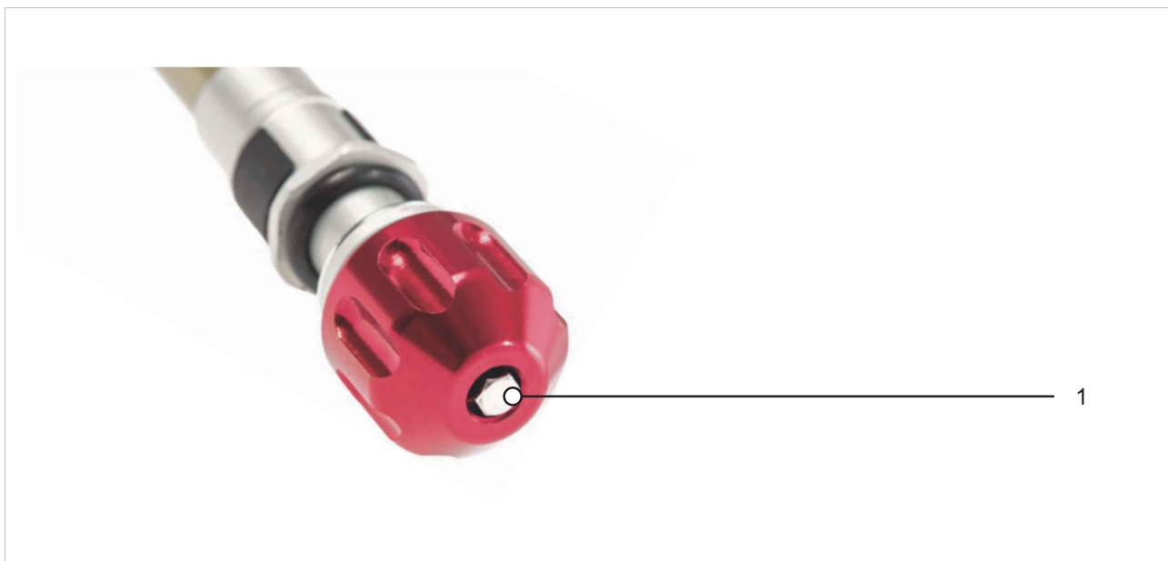
Afbeelding 167: Voorbeeld SR SUNTOUR trekdemperafsteller (verende voorvork) (1)
