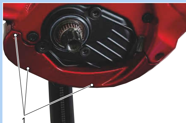
Afbeelding 96: Bevestigingsschroeven onderste motorafdekking (1)
