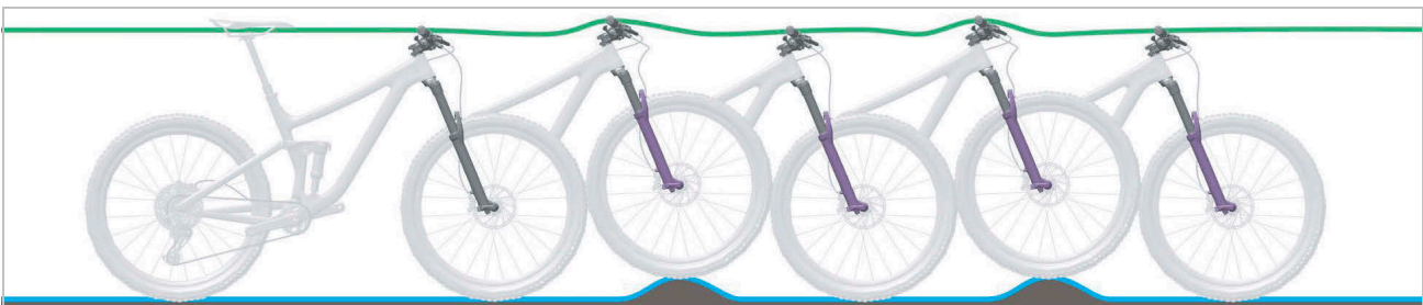
Afbeelding 21: Optimaal rijgedrag van de verende voorvork
