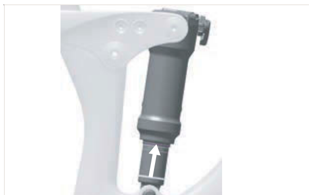
Afbeelding 166: O-ring op de achterbouwdeemper verschuiven
