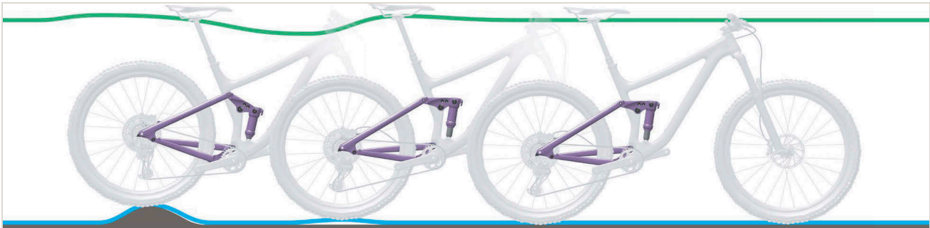
Afbeelding 258: Te snel uitveren van de achterbouwdeemper
