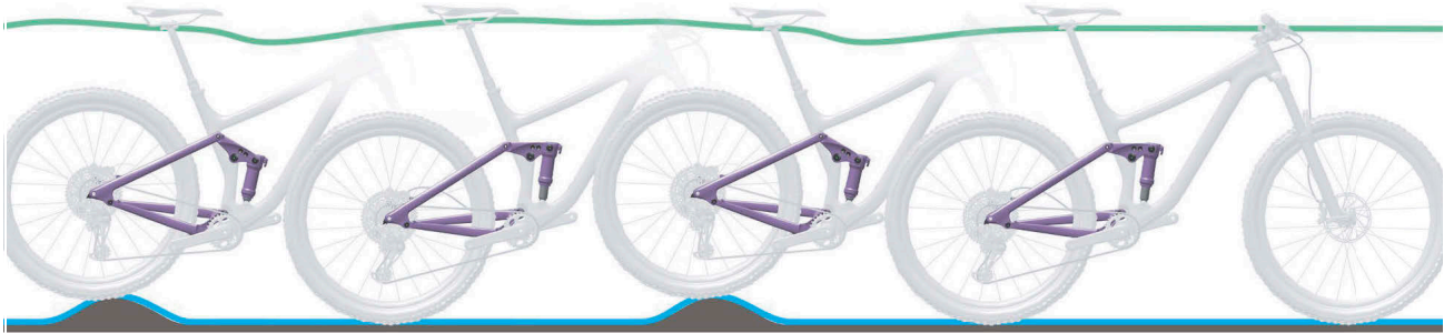
Afbeelding 8: Optimaal rijgedrag van de achterbouwdeemper
