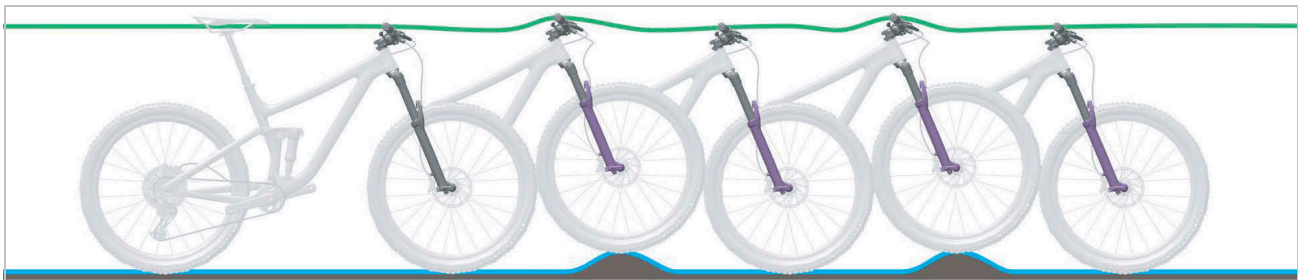
Afbeelding 18: Optimaal rijgedrag van de verende voorvork
