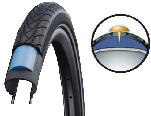
Figura 8: Azione della cintura di protezione contro le forature
