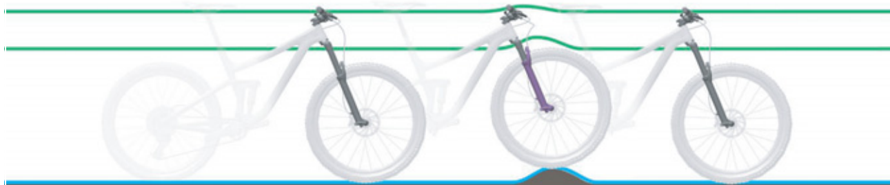
Figura 192: Comportamento di marcia ottimale su un terreno con asperità
