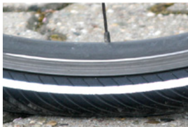
Figura 139: Corretta pressione di gonfiaggio. Lo pneumatico quasi non si deforma sotto il peso corporeo
