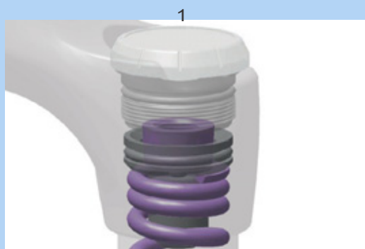
Figura 147: Avvitamento e svitamento dell'anello di regolazione del precarico
