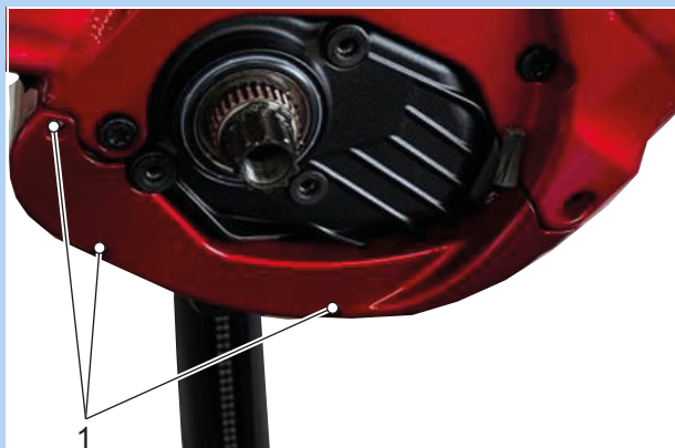
Figura 74: Viti di fissaggio della copertura inferiore del motore (1)
