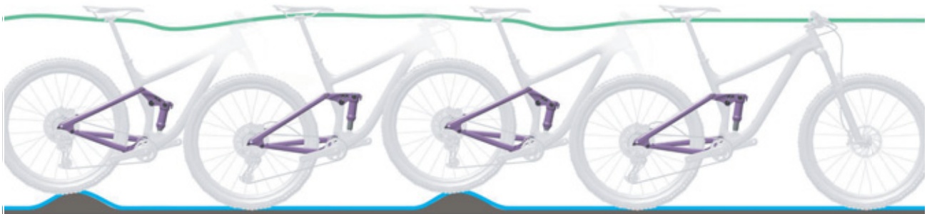
Figura 25: Comportamento di marcia ottimale dell'ammortizzatore del carro posteriore
