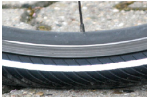
Figura 132: Corretta pressione di gonfiaggio. Lo pneumatico quasi non si deforma sotto il peso corporeo
