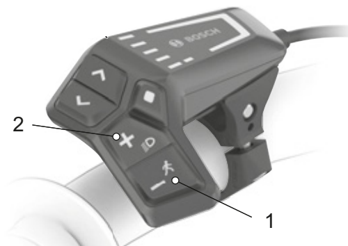
Figura 188: Ubicazione del pulsante più e del pulsante meno
