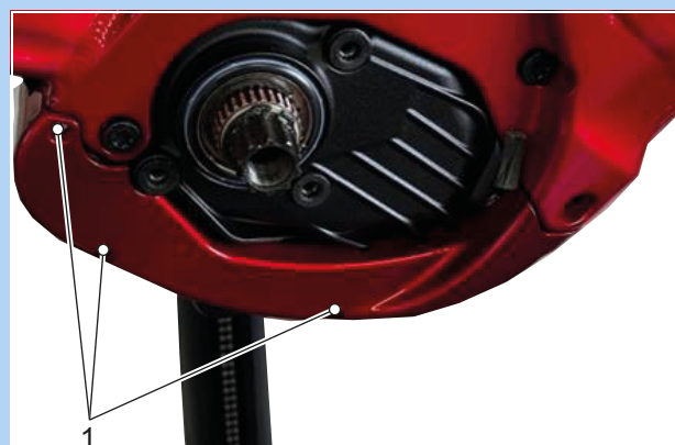
Figura 64: Viti di fissaggio della copertura inferiore del motore (1)
