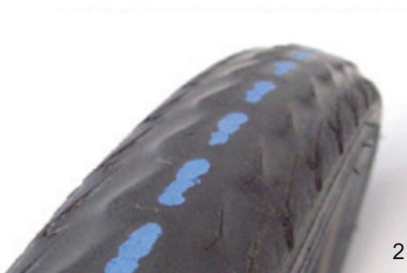
Figura 203: Pneumatico senza profilo che può essere sostituito (1) e pneumatico con protezione contro le forature in vista (2) che deve essere sostituito
