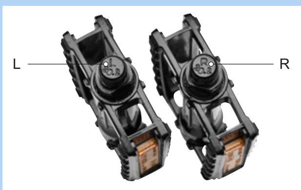
Figura 58: Esempio: segno sui pedali
