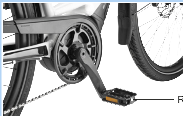
Figura 59: Pedale R nel braccio destro della pedivella
