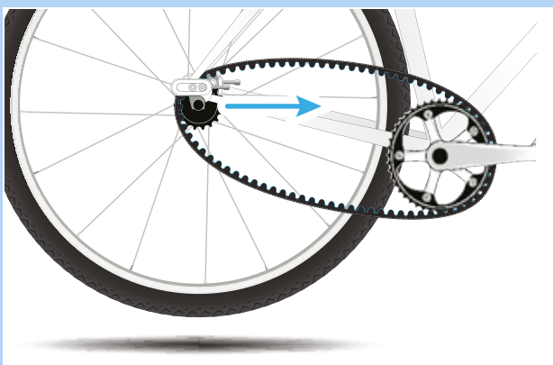
Figura 61: Spingere la ruota posteriore in avanti
