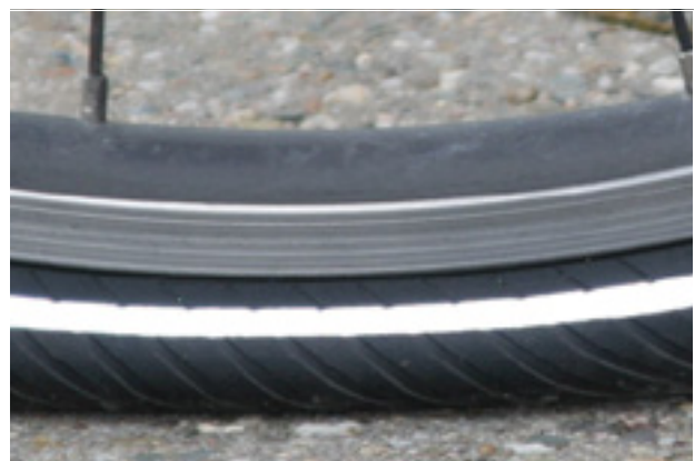
Figura 133: Pressione di gonfiaggio insufficiente
