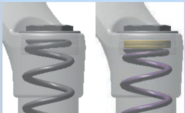
Figura 156: Avvitamento e svitamento dell'anello di regolazione del precarico
