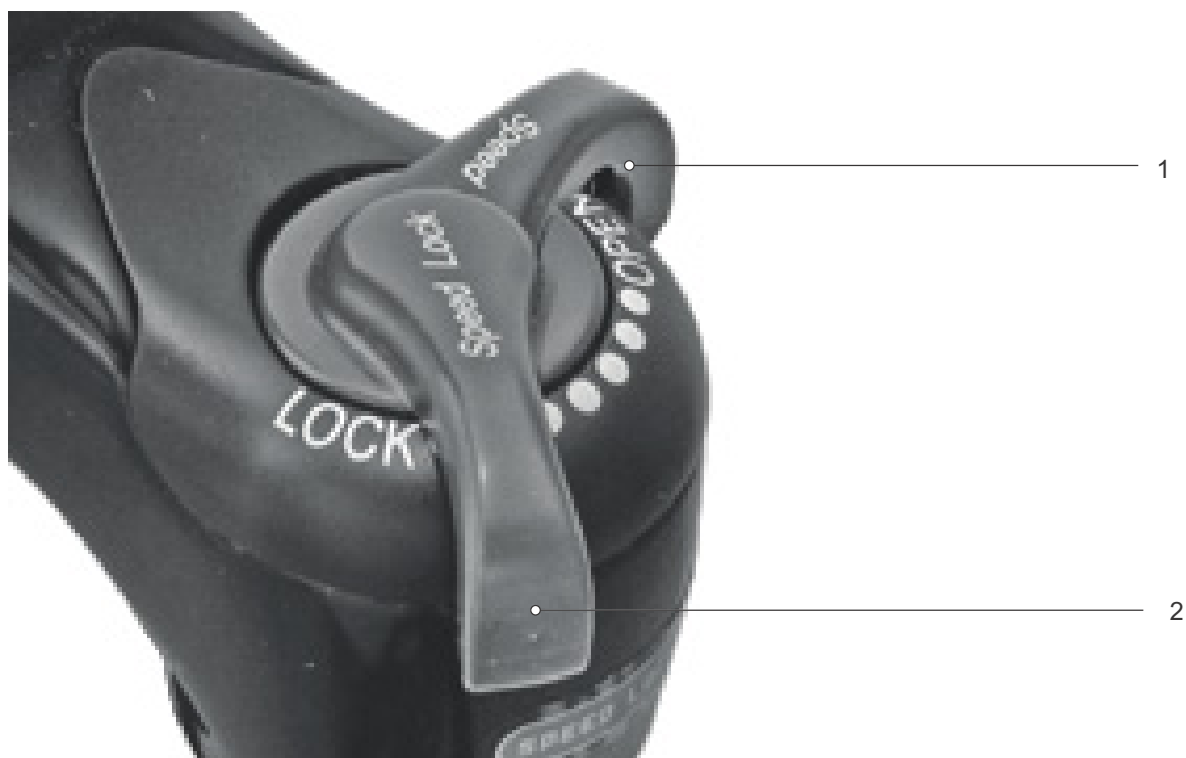
Figura 193: Ammortizzatore a stadi di pressione SR SUNTOUR in posizione aperta (1) e chiusa (2)
