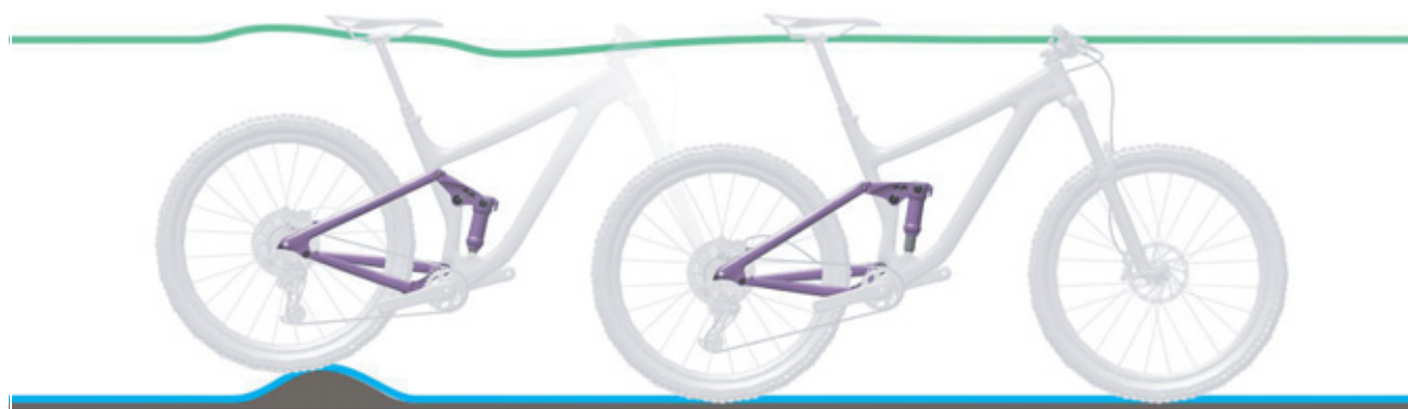
Figura 164: Comportamento di marcia ottimale dell'ammortizzatore del carro posteriore su asperità
