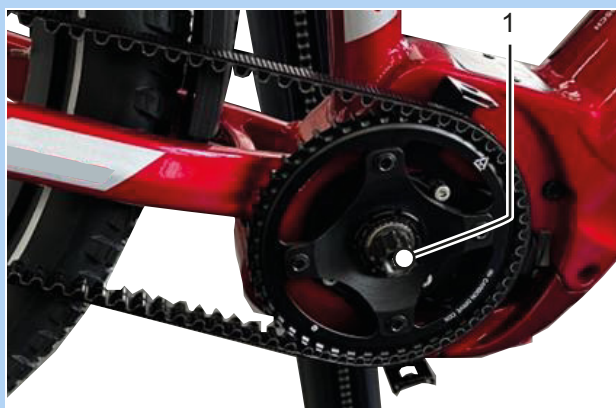
Figura 75: Fissaggio della puleggia, esempio
