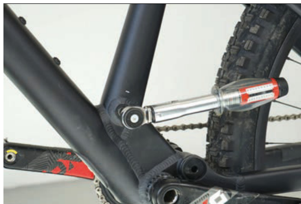
Figura 116: Serraggio dell'asse del canotto reggisella
