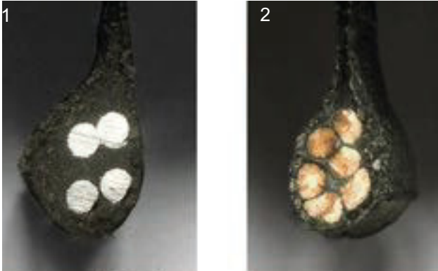
Figura 7: Cerchietto in acciaio (1) e cerchietto in Kevlar (2)
