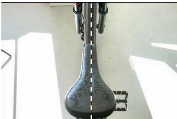
Figura 115: Posizionamento della sella in direzione di marcia
