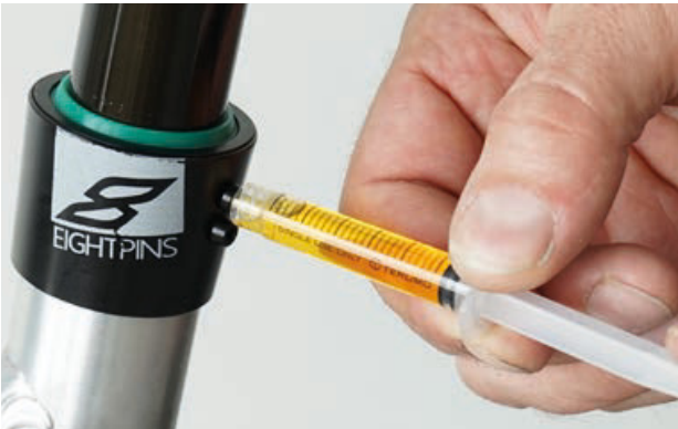
Figura 201: Lubrificazione del cannotto reggisella Eightpins
