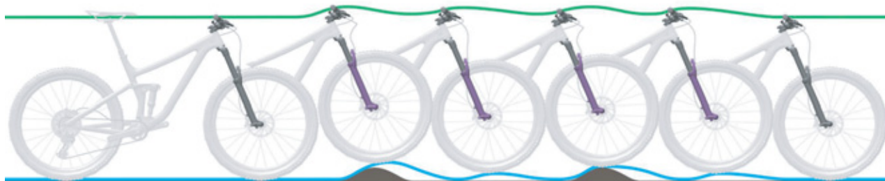
Figura 238: Corsa di estensione troppo veloce della forcella ammortizzata
