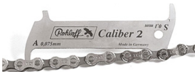
Figura 211: Esempio di calibro di misura dell'usura ROHLOFF
