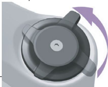
Figura 195: Regolazione più morbida del regolatore dello stadio di compressione
