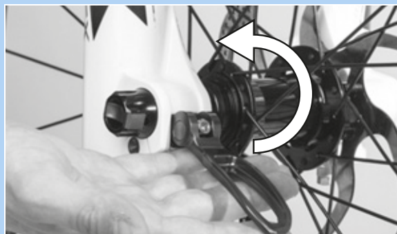
Figura 88: Spinta della leva del bloccaggio rapido nel verso della freccia
