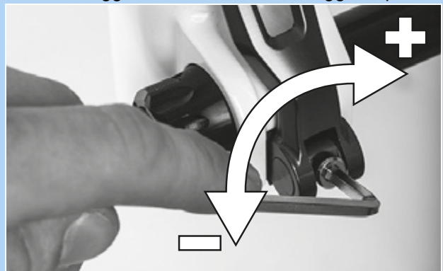
Figura 235: Regolazione della forza di serraggio del bloccaggio rapido
