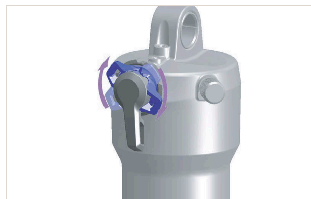
Afbeelding 148: Drukdemperafsteller harder afstellen
