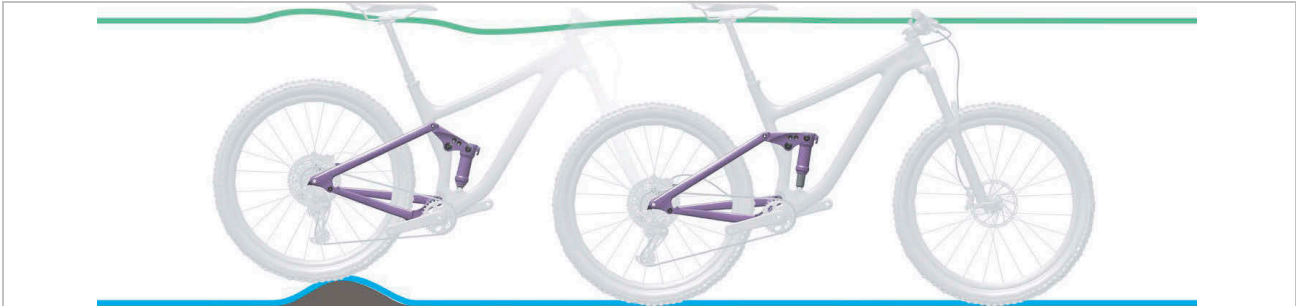
Afbeelding 7: Optimaal rijgedrag van de achterbouwdeemper bij oneffenheden
