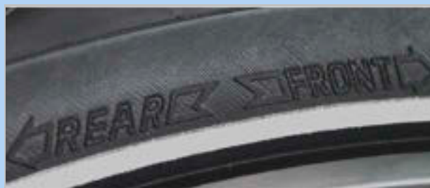
Afbeelding 67: Pijl draairichting op MTB-banden
