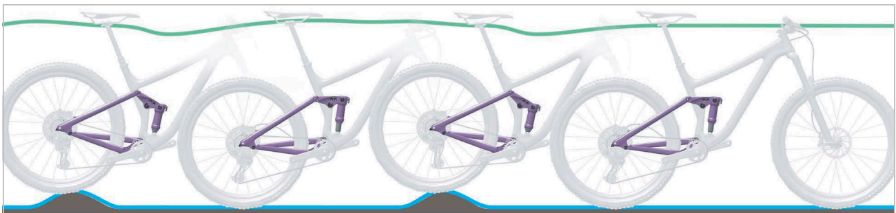
Afbeelding 5: Optimaal rijgedrag van de achterbouwdemper
